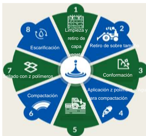
Figura 14. Proceso constructivo con Z polímeros.
