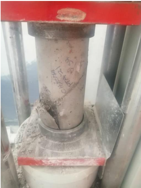
Fotografía 1. Falla por compresión
