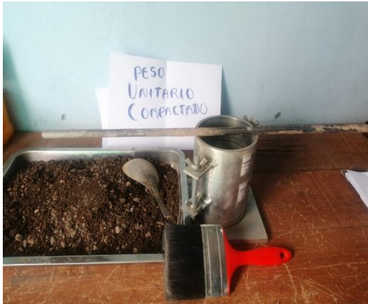
Fotografía 1. Materiales usados en el peso unitario compactado
