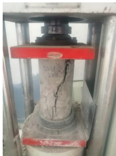
Figura 24. Falla por compresión.
