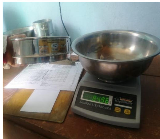
Fotografía 4. Peso del tamizado malla 1/2" muestra de agregado grueso
