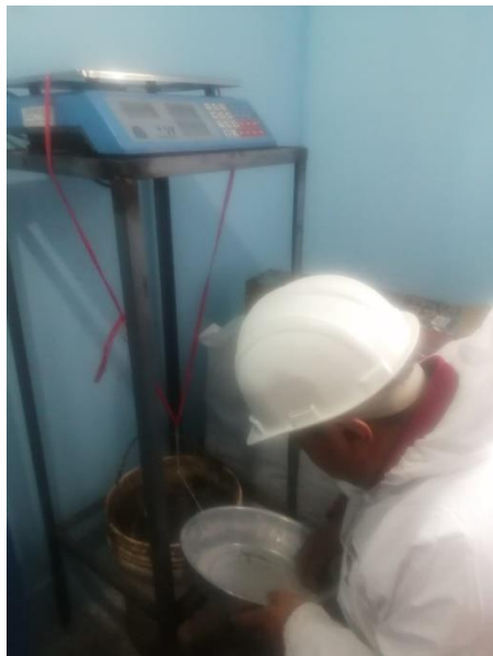
Fotografía 4. Saturado del agregado grueso por 24 horas
