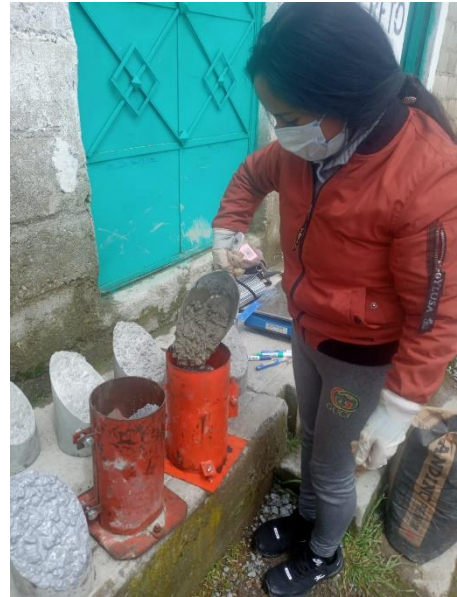
Fotografía 2. Colocación de concreto fresco sobre concreto antiguo
