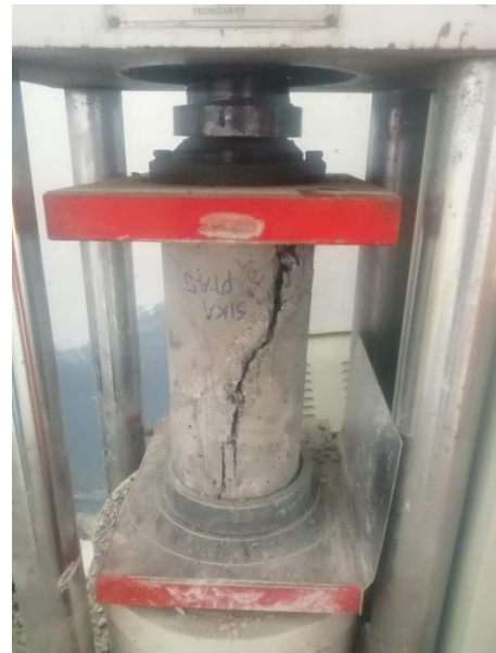
Fotografía 2. Falla por compresión
