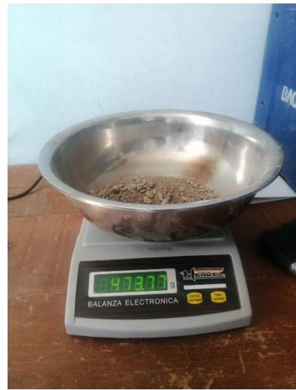
Fotografía 2. Pesado de muestras de agregado grueso y fino después del secado
