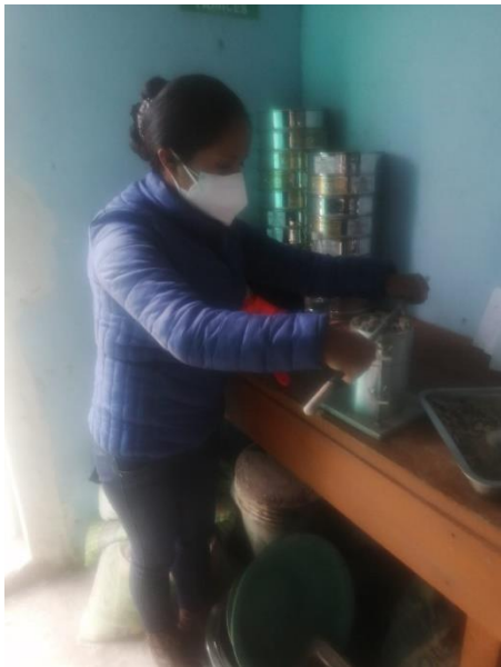
Fotografía 3. Enrasado de muestra de agregado grueso.
