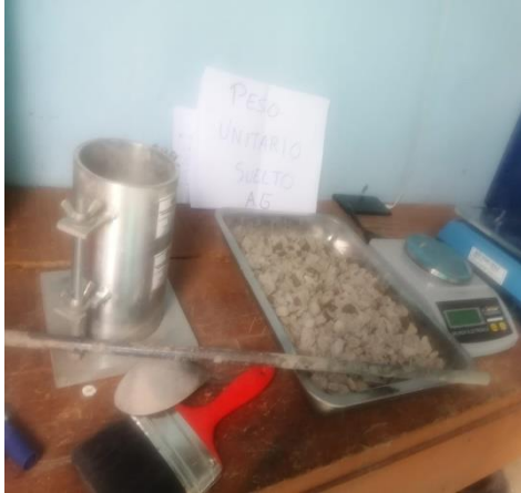
Fotografía 1. Materiales usados en el peso unitario suelto de agregado grueso
