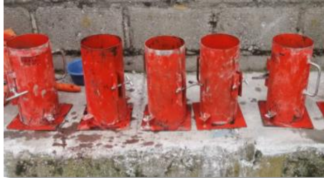
Figura 9. Moldes cilíndricos de 30 x 15 (ASTM C-39)
