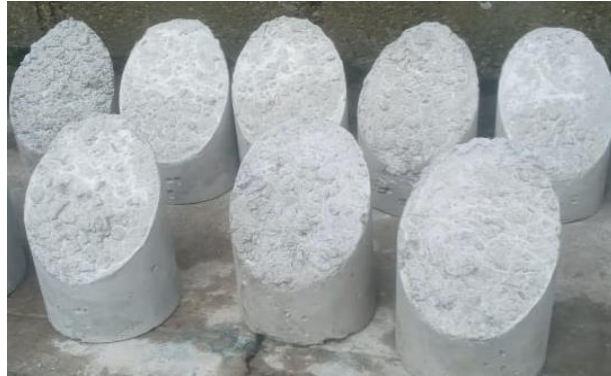
Figura 18. Picado 50 % de superficie de contacto
