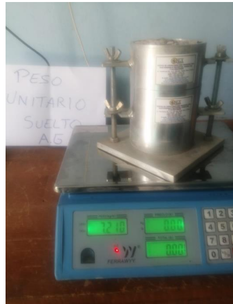
Fotografía 4. Determinación del peso de molde más agregado grueso
