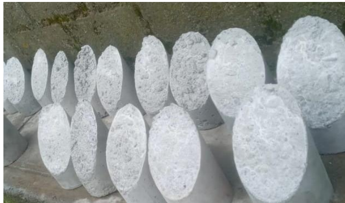
Figura 17. Muestras con ángulo de corte 45°
