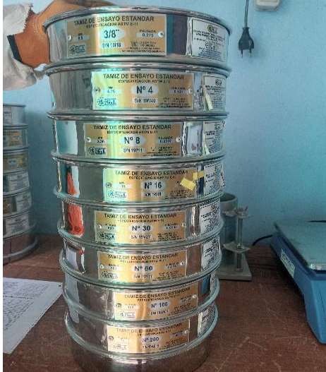
Fotografía 1. Disposición de mallas para tamizar agregado fino
