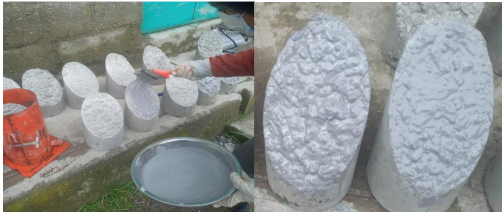
Figura 20. Juntas de contacto, aplicando Adhesivo
