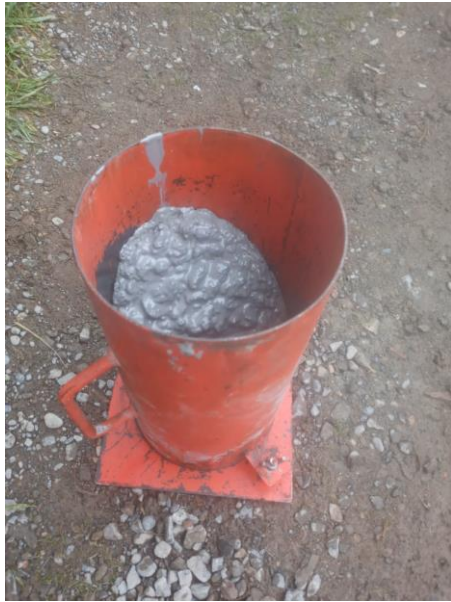
Fotografía 1. Llenado de concreto antiguo en molde, aplicado adhesivo epóxico.
