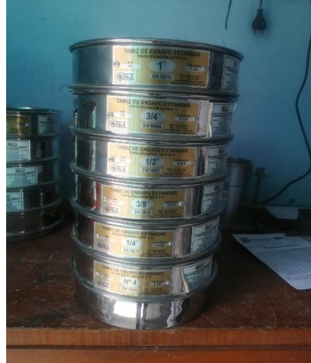
Fotografía 2. Disposición de mallas para tamizaje agregado grueso
