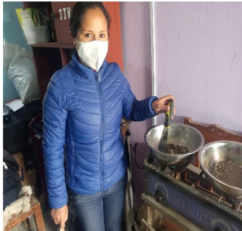
Fotografía 3. Secado de muestras en cocina a fuego lento de agregado grueso y fino.
