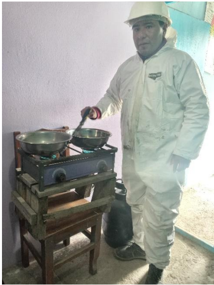
Fotografía 1. Secado de muestras en cocina a fuego lento de agregado grueso y fino.
