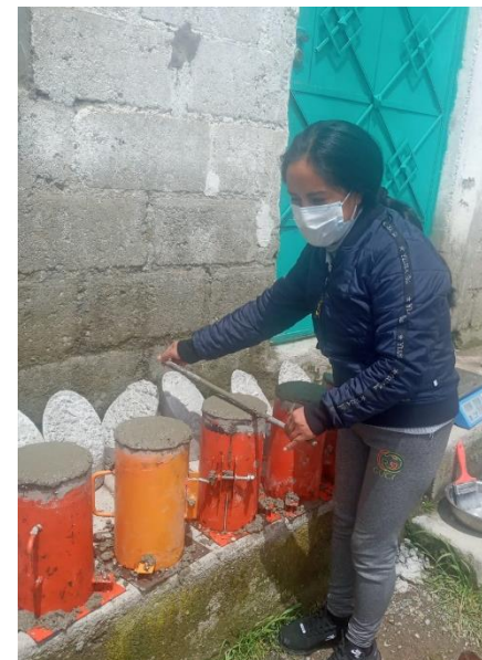
Fotografía 4. Enrasado de concreto fresco en segunda etapa
