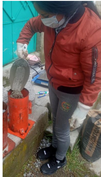
Fotografía 2. Llenado del mortero en el molde
