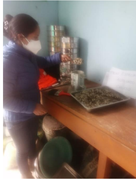
Fotografía 2. Llenado de agregado grueso al molde.
