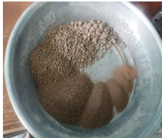
Fotografía 4. Selección del tamizado de muestra de agregado fino
