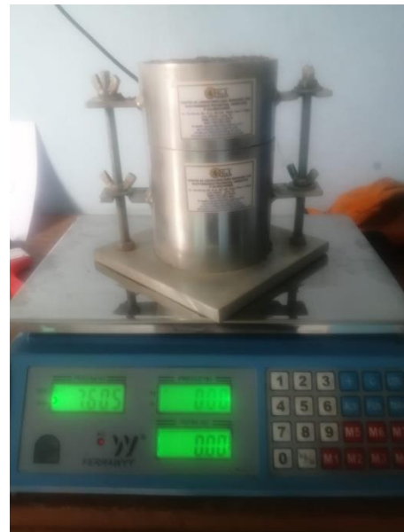
Fotografía 4. Determinación del peso de molde más agregado fino
