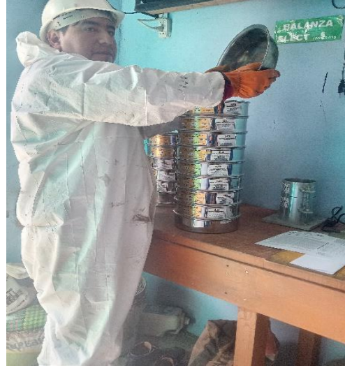
Fotografía 2. Empezando a tamizar la muestra
