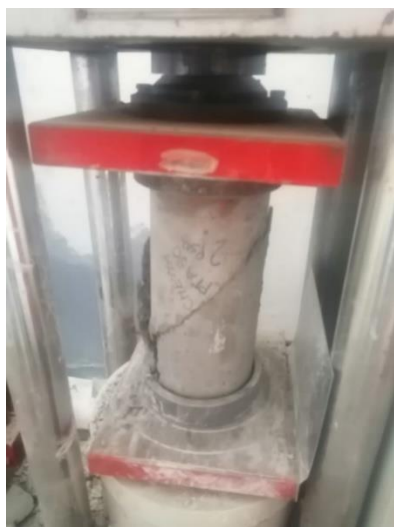
Figura 23. Falla por deslizamiento (corte)
