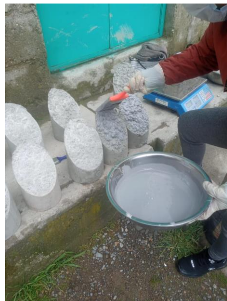
Fotografía 4. Aplicación de adhesivo Sikadur 32 gel en junta de contacto.
