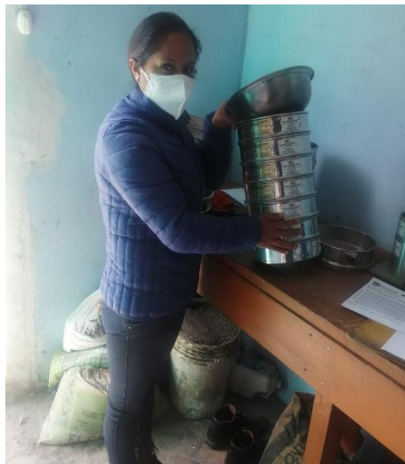
Fotografía 3. Tamizando la muestra de agregado grueso.
