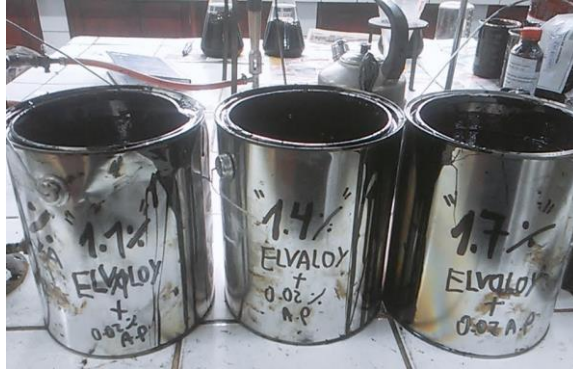
Figura 9. Asfaltos modificados con diferentes % del polímero Elvaloy 4170 Ret. Fuente: Propia
