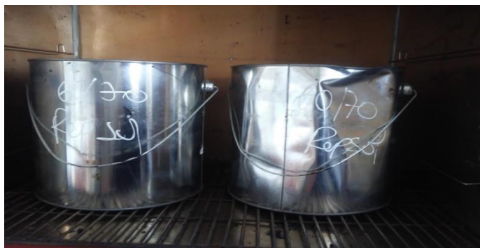
Figura 6. Asfalto Pen 60/70 puesta en horno a 180^{\circ}\text{C}
