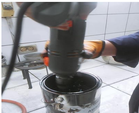
Figura 8. Batido de asfalto Pen 60/70, polímero Elvaloy 4170 Ret y Acido poli fosfórico.
