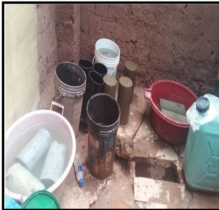
Figura 13: Proceso de curado de las muestras de concreto Fuente: Propio
