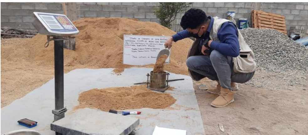
Figura 3. Peso Unitario del Agregado Fino
