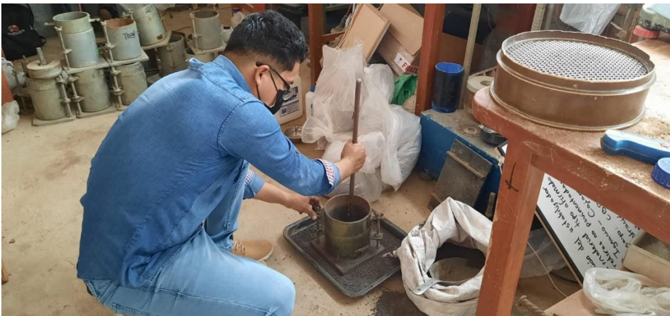
Figura 5. Peso unitario de la escoria de acero
