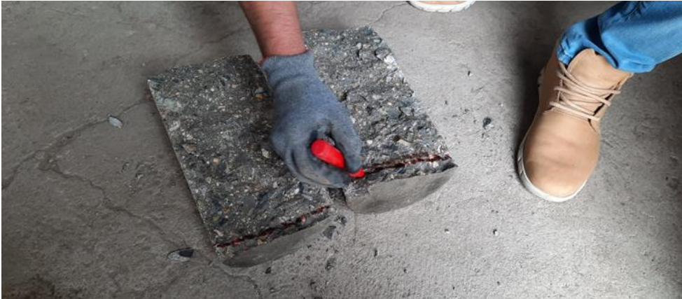
Figura 19. Ensayo de penetración del agua bajo presión (Toma 2)
