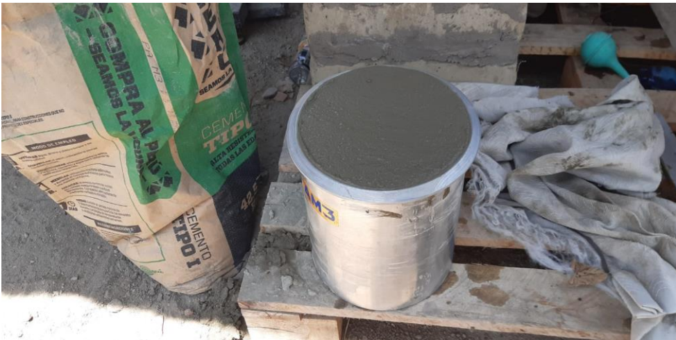
Figura 14. Densidad del concreto fresco
