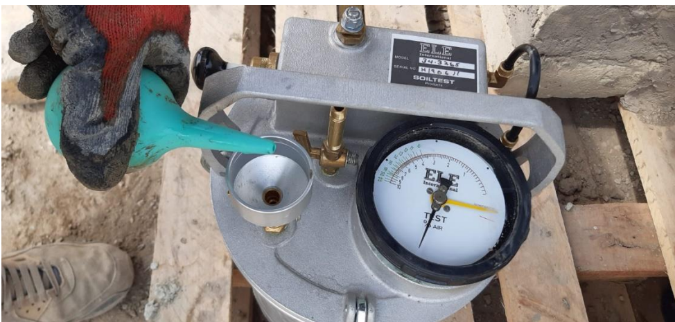
Figura 15. Ensayo porcentaje de aire atrapado del concreto
