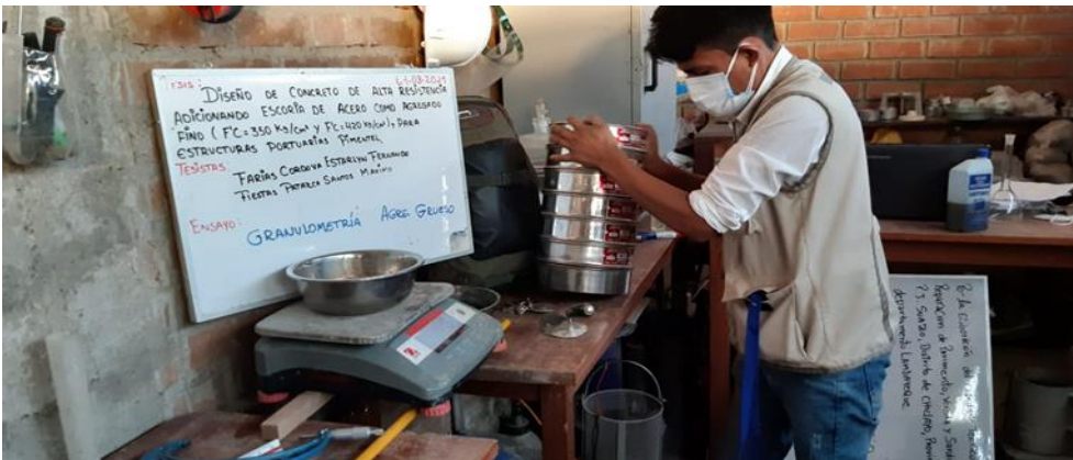
Figura 2. Análisis granulométrico del agregado Grueso
