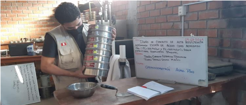
Figura 1. Análisis granulométrico del agregado fino a cargo de los tesistas
