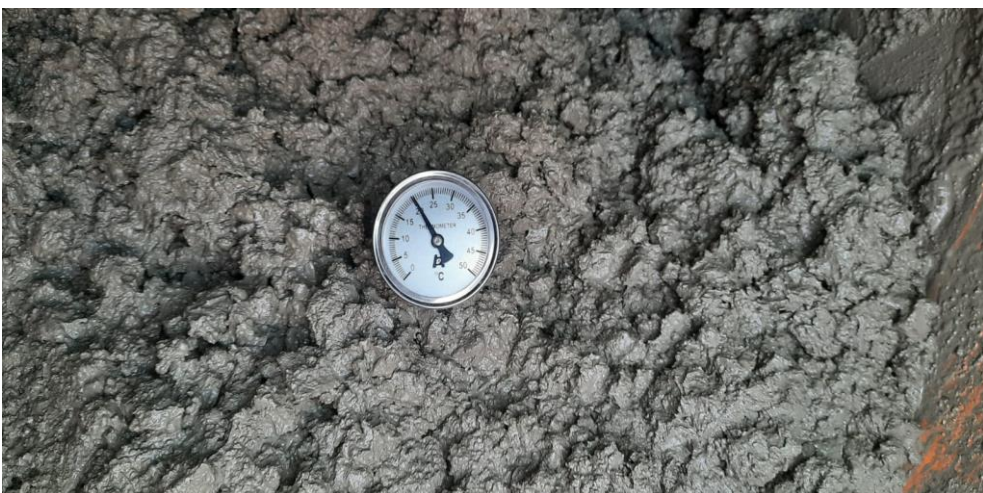
Figura 12. Temperatura del concreto fresco
