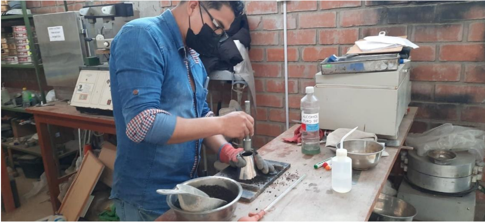
Figura 10. Peso específico de la escoria de acero
