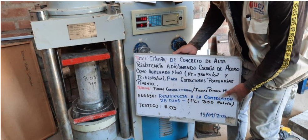
Figura 16: Ensayo de Resistencia a la compresión
