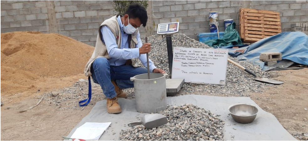
Figura 4. Peso Unitario del Agregado Grueso
