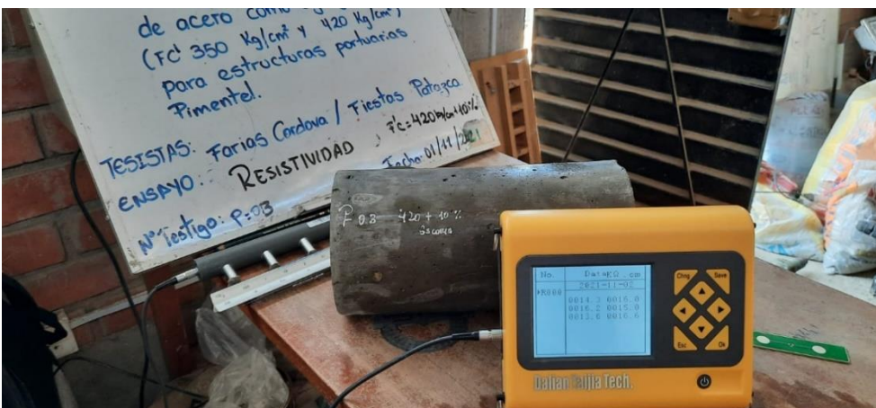
Figura 21. Ensayo de resistividad eléctrica (Toma 2)
