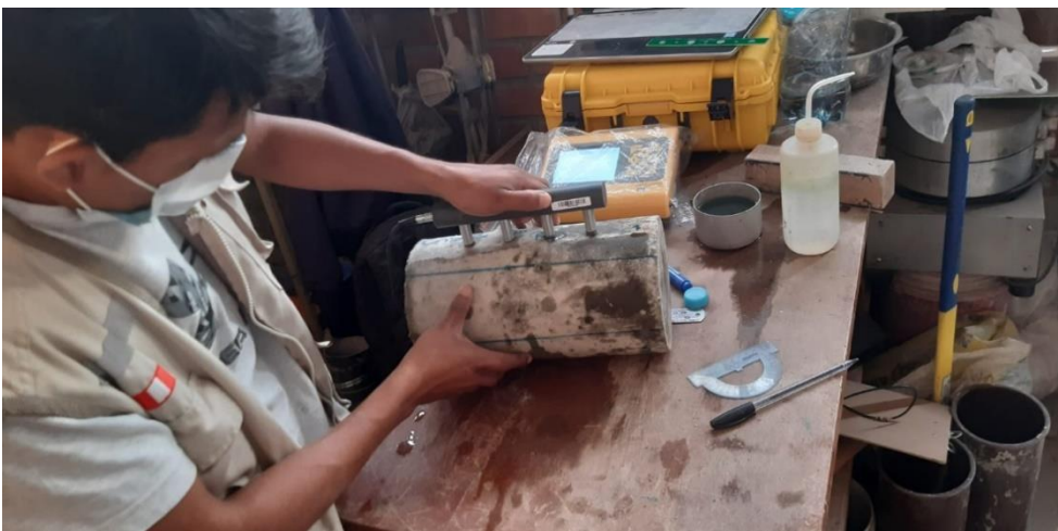
Figura 20. Ensayo de resistividad eléctrica (Toma 1)
