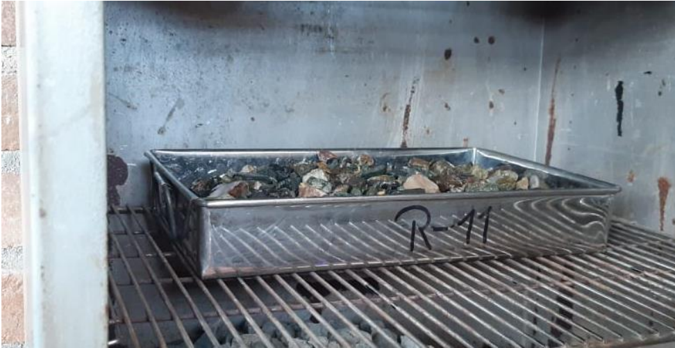
Figura 7. Contenido de humedad del agregado grueso
