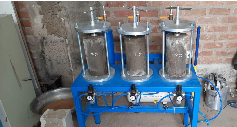
Figura 18. Ensayo de penetración del agua bajo presión del concreto endurecido (Toma 1)
