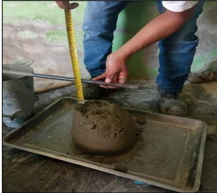
Foto 7. Ensayo de Slump
