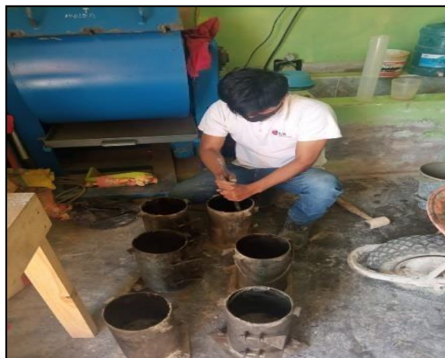
Foto 6. Limpieza de moldes de probetas
