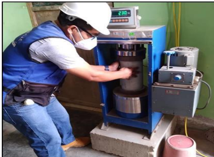
Foto 8. Ensayo de compresión.
