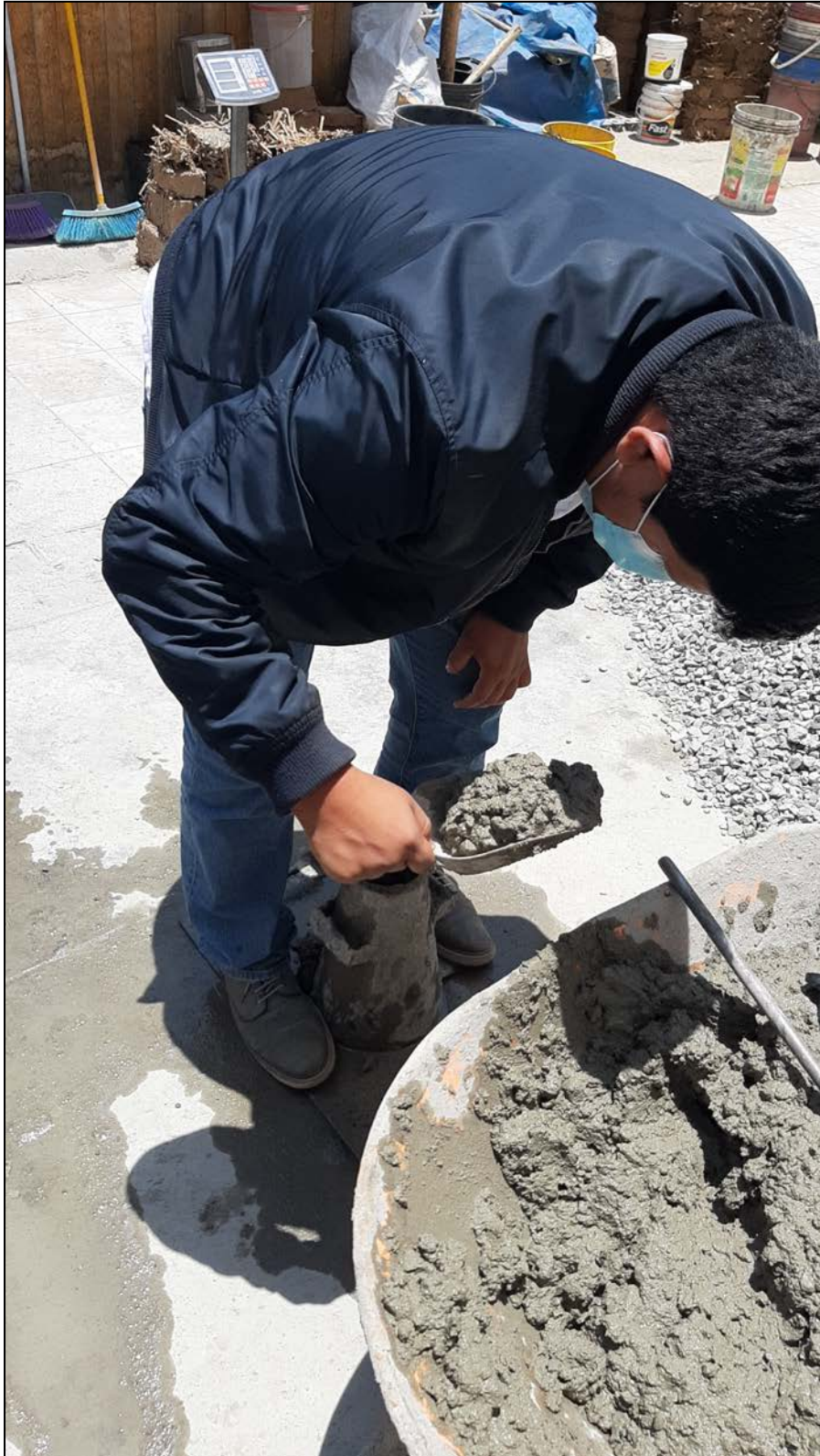
Figura 62. Realización del ensayo de asentamiento.
