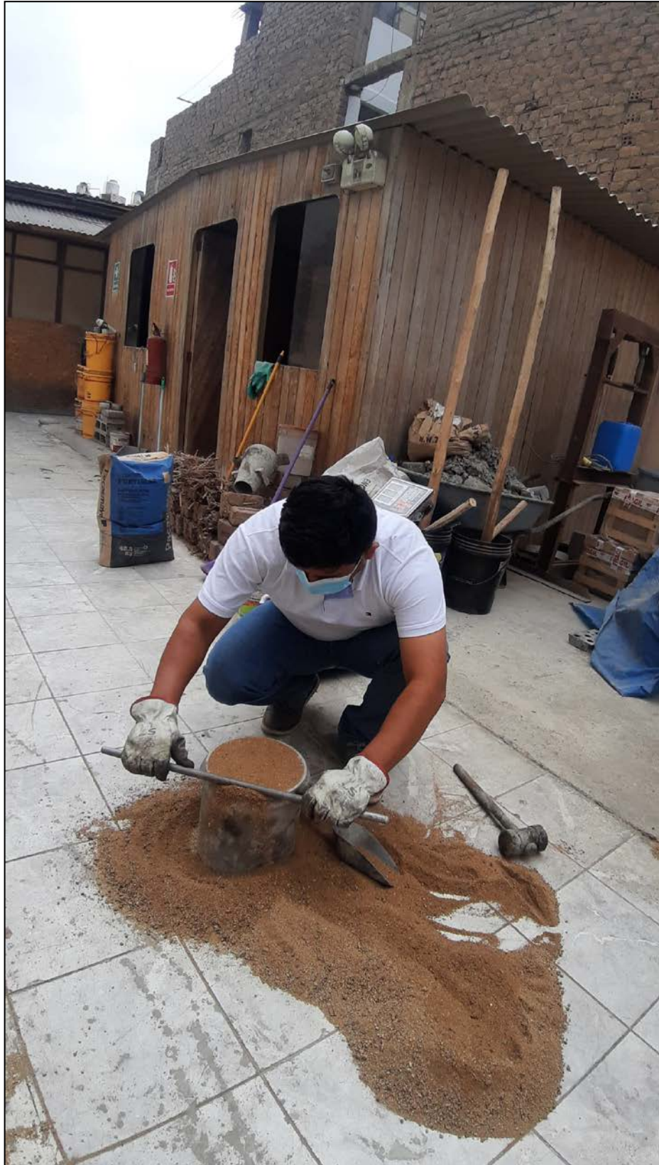
Figura 60. Realización del ensayo de peso unitario del agregado fino.
