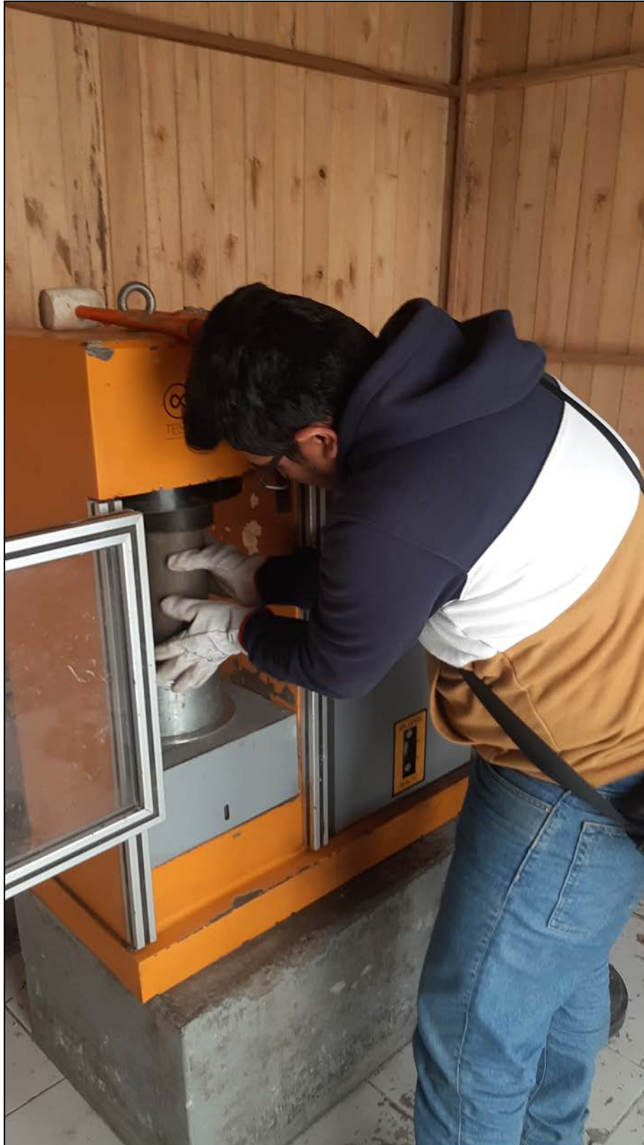
Figura 64. Realización del ensayo de rotura de probetas.
