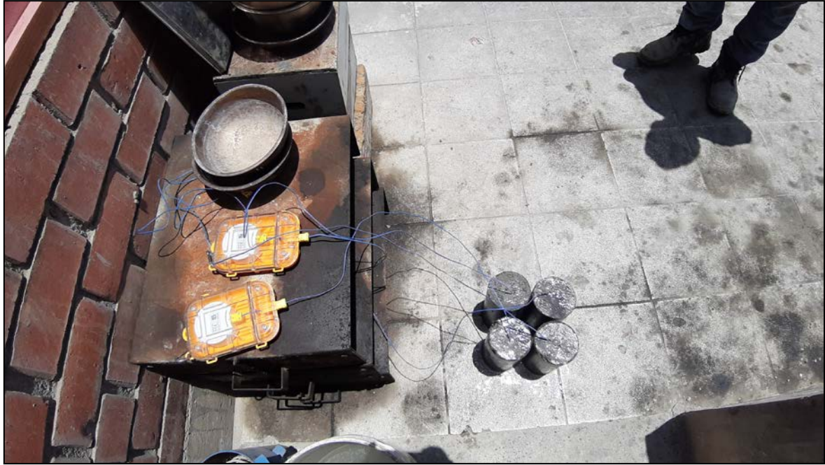
Figura 63. Sensores midiendo la temperatura de las probetas.
