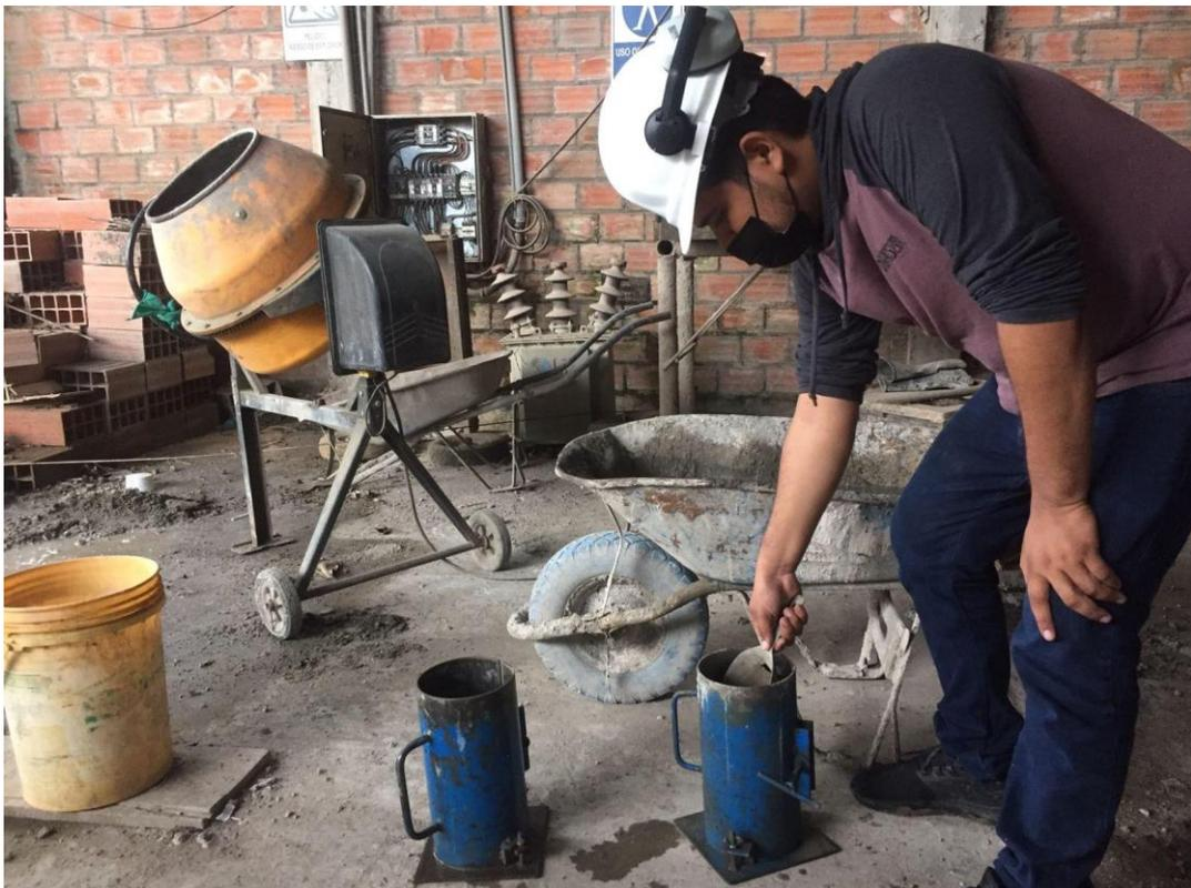
FOTOGRAFÍA 10. Elaboración de probetas
