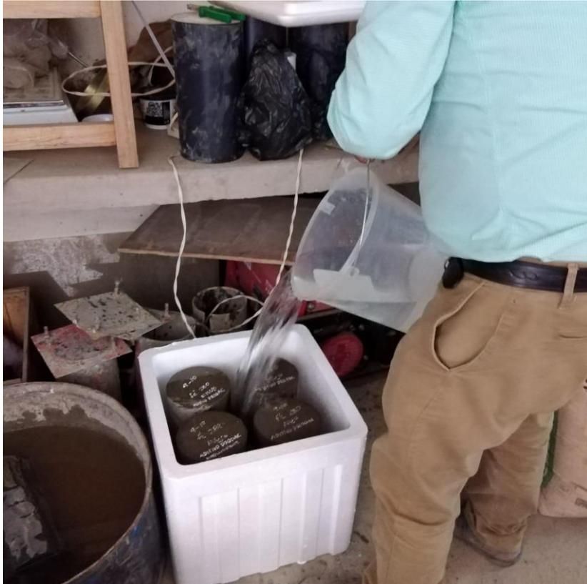
FOTOGRAFÍA 11. Curado de probetas
