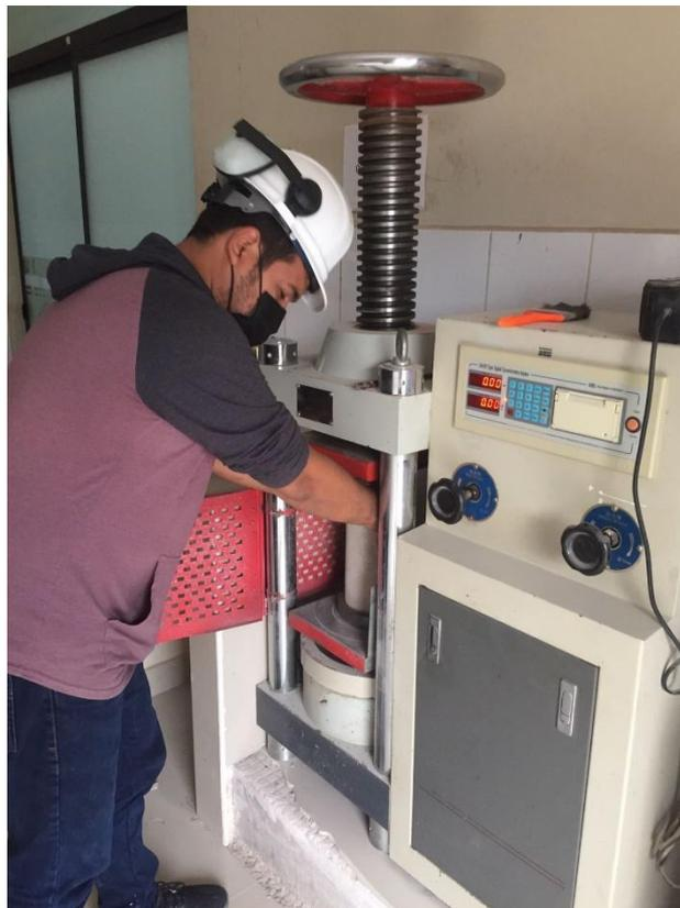
FOTOGRAFÍA 12. Prueba de resistencia de probetas
