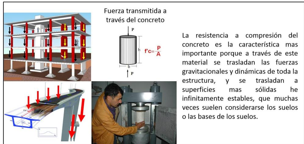
Figura N° 04. Resistencia a la compresión.
