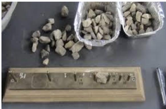
*Figura N° 02. Tamaño de agregado grueso.*
