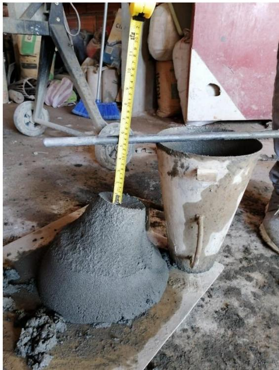
FOTOGRAFÍA 8. Prueba de slump del concreto fast track
