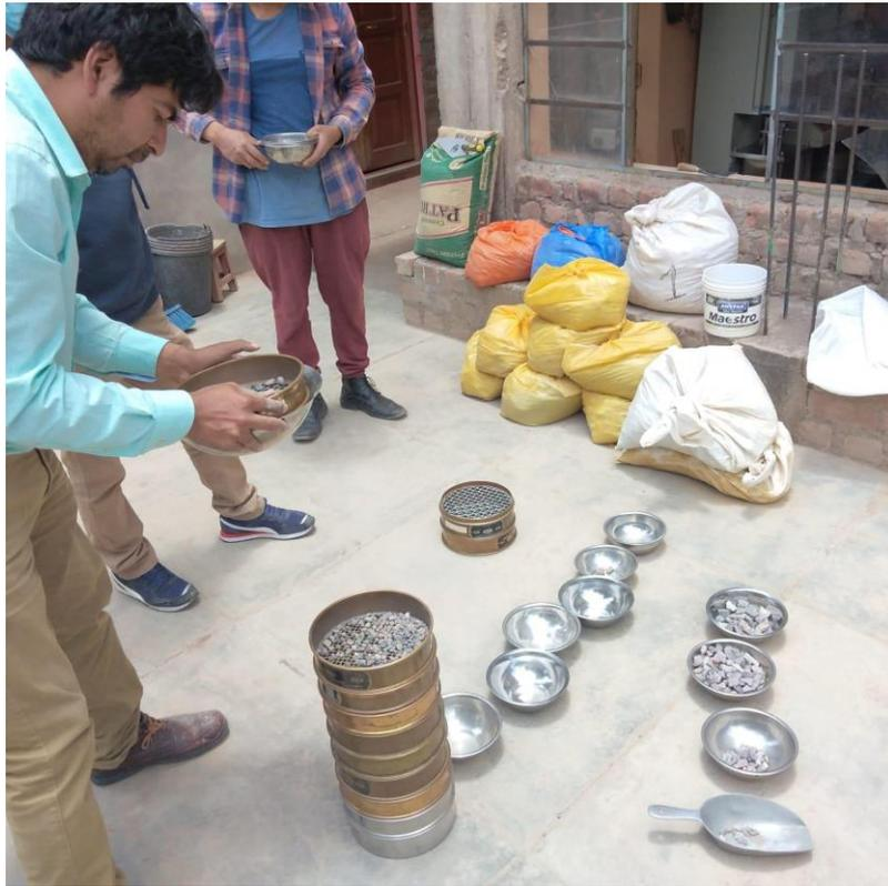
FOTOGRAFÍA 1. Ensayo para determinar las propiedades del agregado
