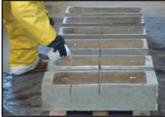
Figura 26. Proceso de la aplicación de epóxico en los agujeros Fuente: Guillermo La Torre y Silva (2019)
