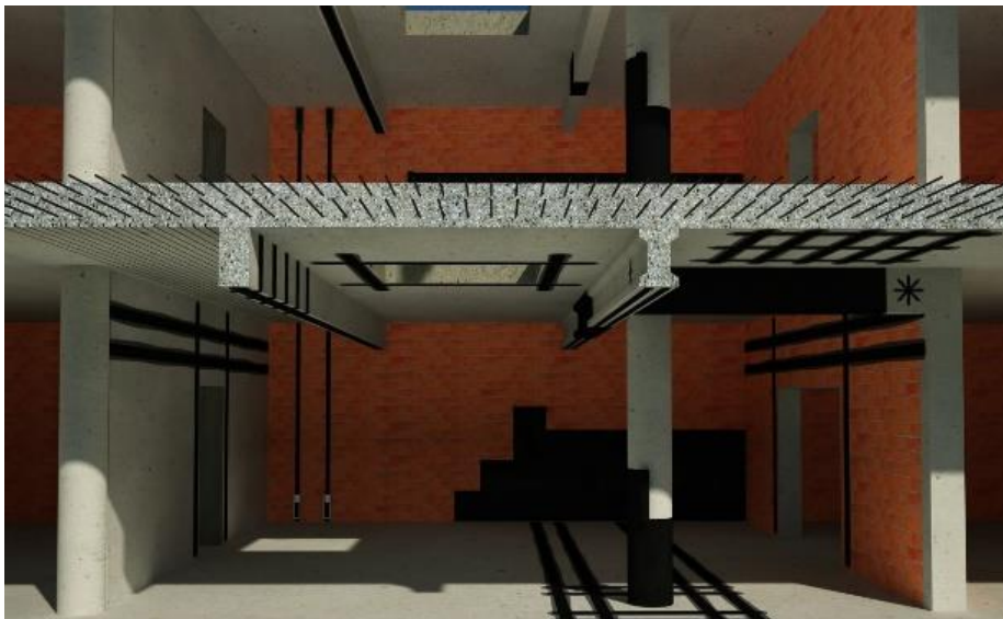
Figura 8. Refuerzo con fibra de carbono
