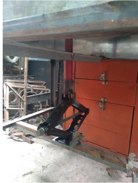
Fotografía 10. Gata mecánica para presión en el molde.
