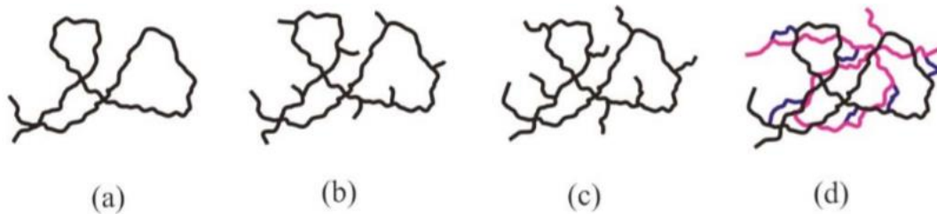
Figura 3. Polímero lineal sin ramificaciones (a), con ramificaciones cortas (b), con ramificaciones largas (c) y polímero entrecruzado (d).
