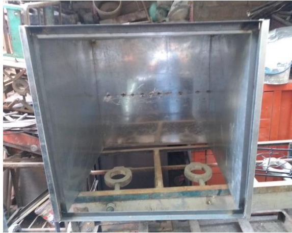
Fotografía 5. Fabricación de horno, estructura interior.
