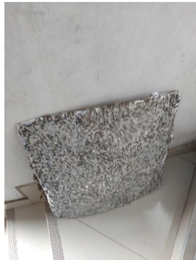
Fotografía 26. Producto de lámina de 60x60 de ancho por 4 mm de espesor para llevar a laboratorio.
