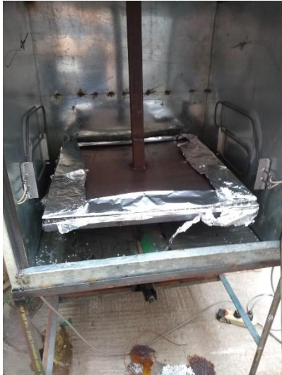
Fotografía 23. Se aplicación una plancha encima y presión a través de la gata mecánica.
