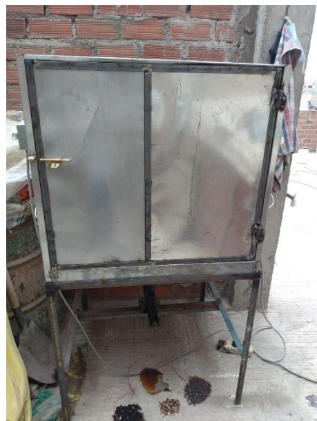
Fotografía 12. Fabricación del horno final.
