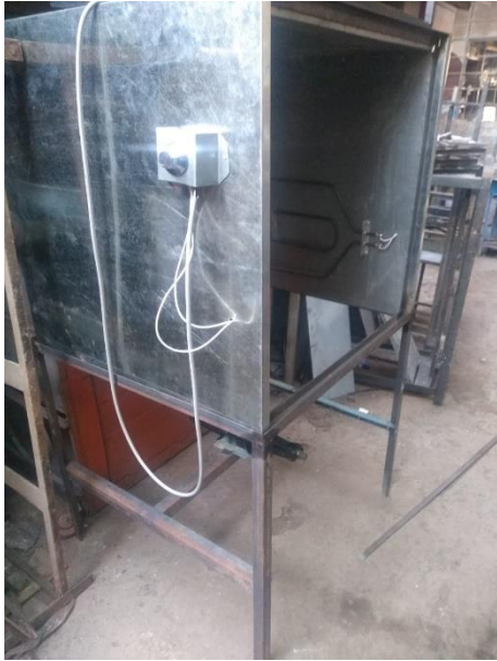
Fotografía 9. Colocación de resistencia y el soporte para el horno.
