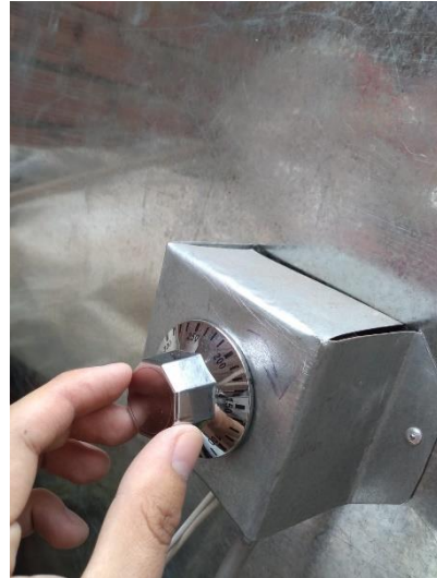
Fotografía 24. Primer control de temperatura con el termostato.
