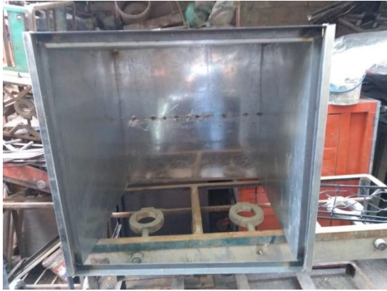
Figura 9. Proceso de fabricación del interior del Horno.
