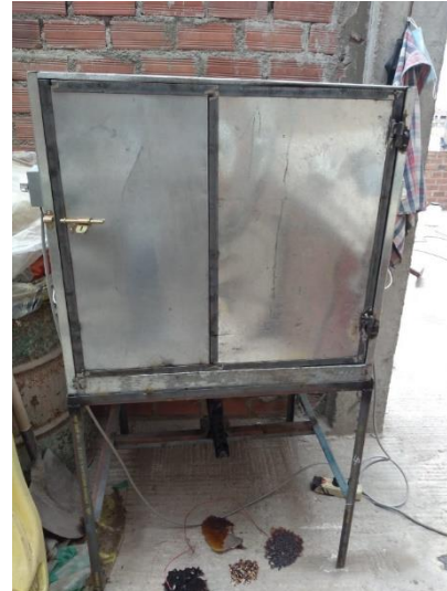
Figura 10. Horno completo con una temperatura máxima de 400 C.
