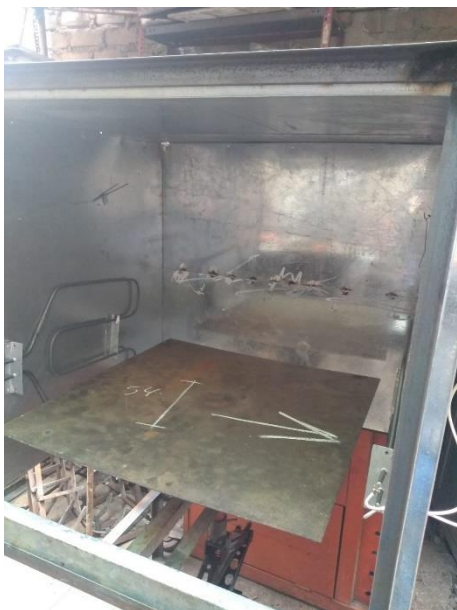
Fotografía 11. Plancha metálica que sube con gata mecánica.
