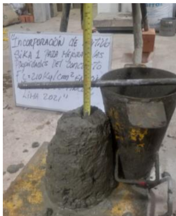
Figura 28. Slump de concreto del diseño patrón - 4"
