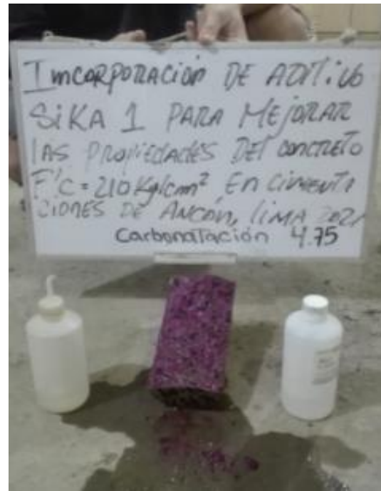
Figura 36. Aplicación de fenolftaleína para el ensayo de resistencia a la carbonatación en concreto con incorporación de 4.75% de aditivo Sika
