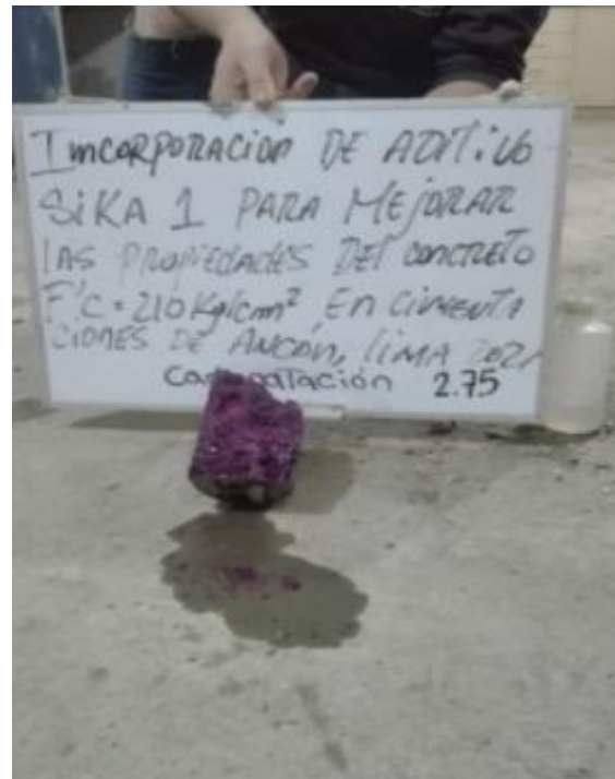
Figura 34. Aplicación de fenolftaleína para el ensayo de resistencia a la carbonatación en concreto con incorporación de 2.75% de aditivo Sika 1
