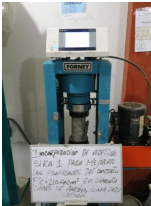
Figura 37. Ensayo de resistencia a la compresión – Diseño patrón
