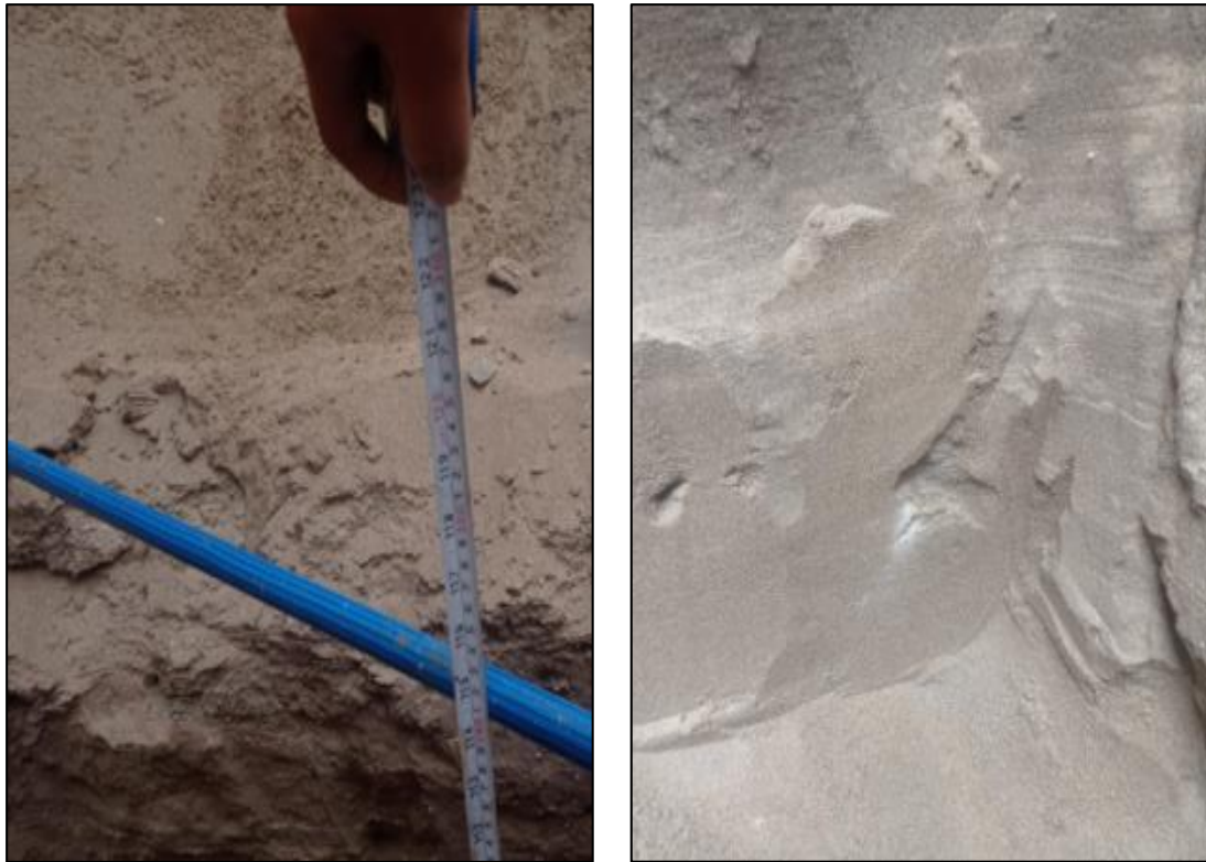
Figura 5. Profundidad de calicata y sustratos del suelo
