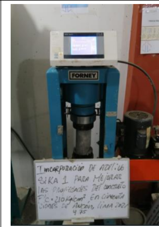
Figura 40. Ensayo de resistencia a la compresión – dosificación de 4.75% de aditivo Sika 1
