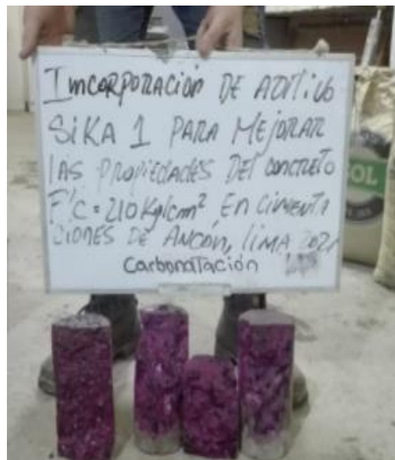
Figura 32. Aplicación de fenolftaleína para el ensayo de resistencia a la carbonatación
