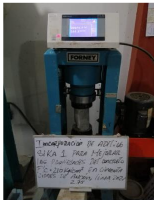
Figura 38. Ensayo de resistencia a la compresión – dosificación de 2.75% de aditivo Sika 1
