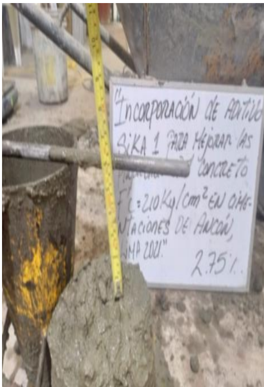
Figura 29. Slump de concreto con incorporación de 2.75% de aditivo Sika 1 - 6"
