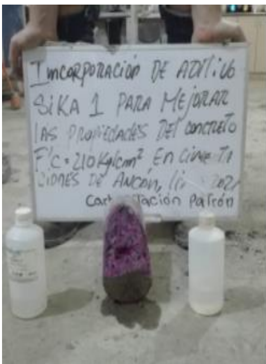
Figura 33. Aplicación de fenolftaleína para el ensayo de resistencia a la carbonatación diseño patrón
