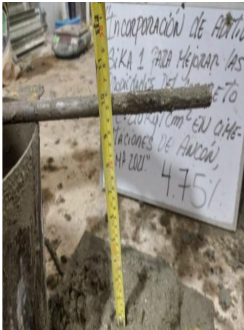
Figura 31. Slump de concreto con incorporación de 4.75% de aditivo Sika 1 - 9.5"
