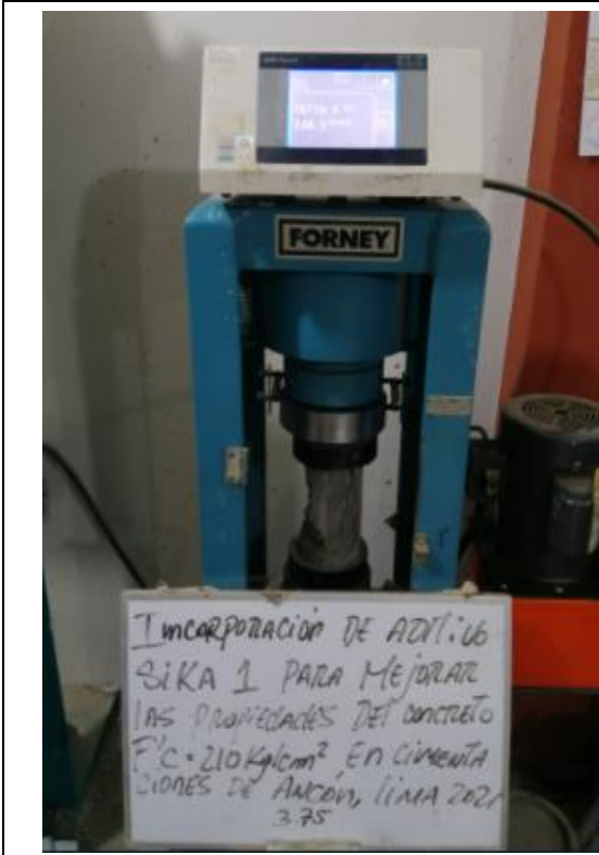
Figura 39. Ensayo de resistencia a la compresión – dosificación de 3.75% de aditivo Sika 1
