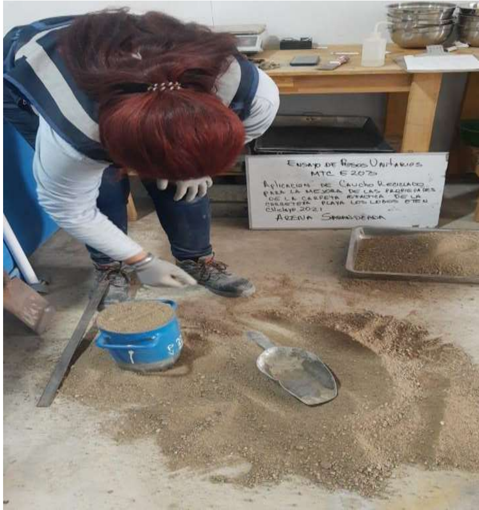
Figura 14: Ensayo de pesos unitarios de arena zarandeada.
