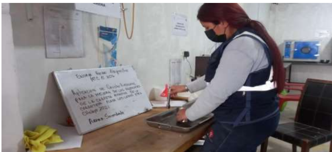
Figura 13: Ensayo de peso específico de arena zarandeada. Fuente: Elaboración propia.
