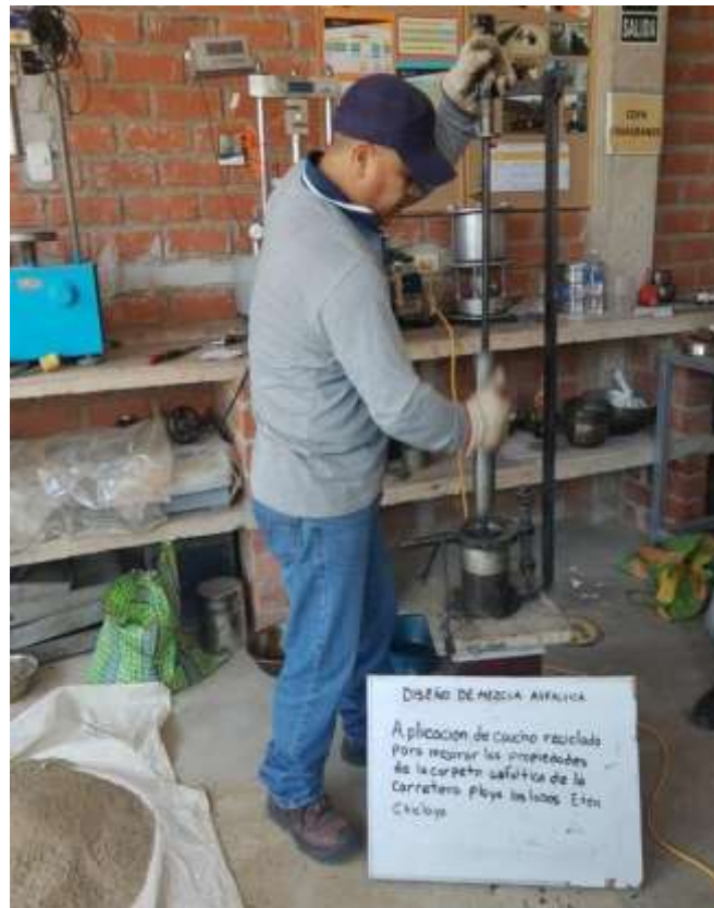
Figura 28: Compactación de mezcla asfáltica.
