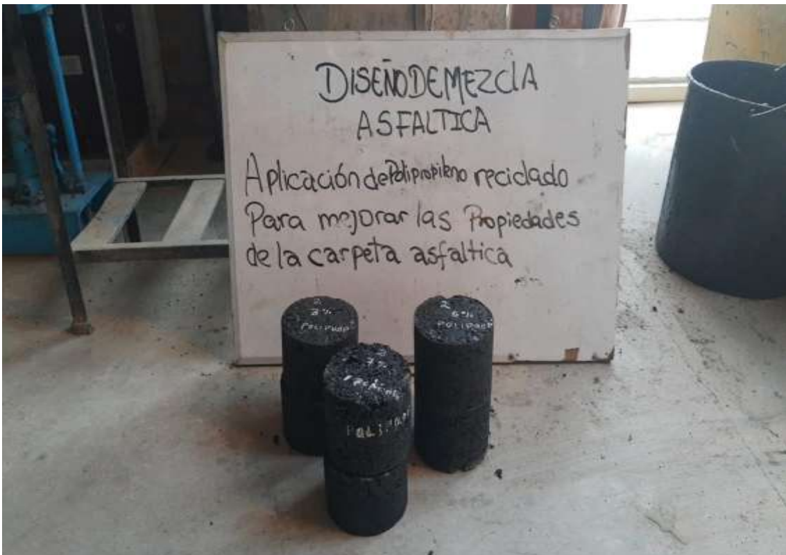
Figura 32: Ensayo Marshall. Fuente: Elaboración propia.
