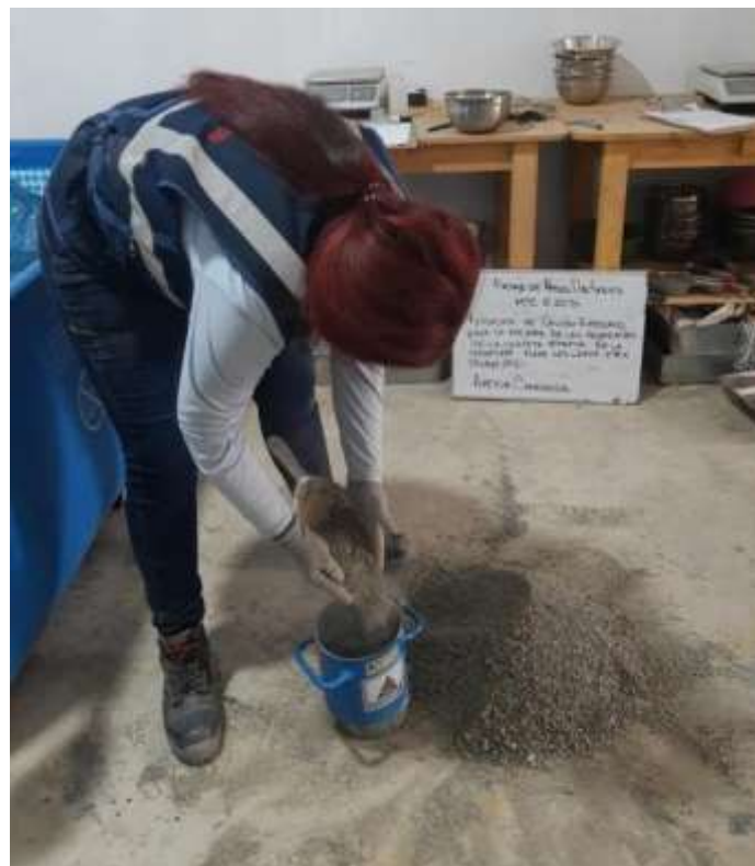
Figura 16: Ensayo de pesos unitarios de arena chancada. Fuente: Elaboración propia.
