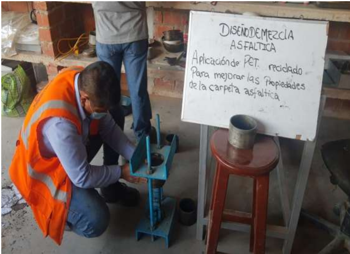
Figura 31: Ensayo marshall. Fuente: Elaboración propia.
