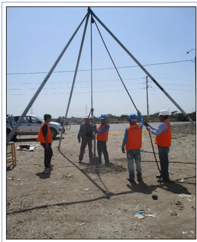
Figura 52 Extracción de muestras del suelo de la Habitación Urbana “Miguel Sánchez Gonzales” – La Victoria – Chiclayo.
