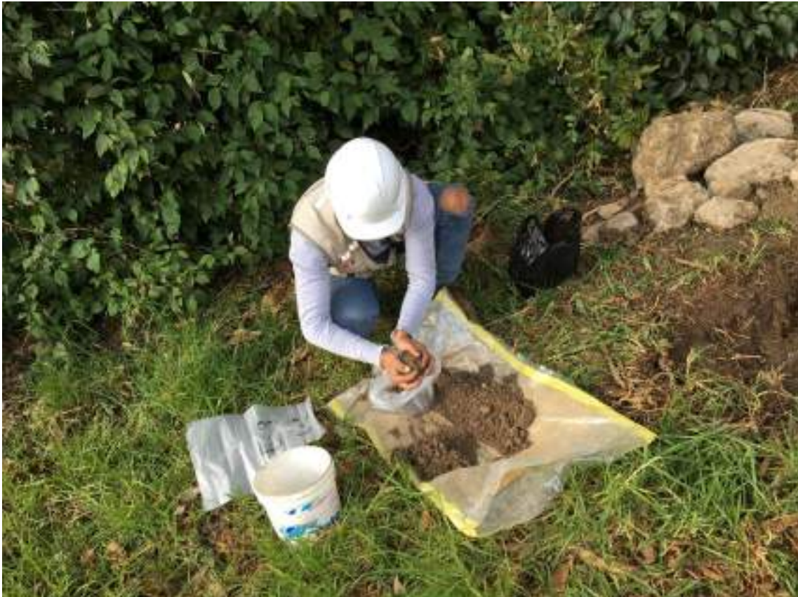
FOTO 20. EXTRACCIÓN DE ESTRATOS DE CALICATAS
