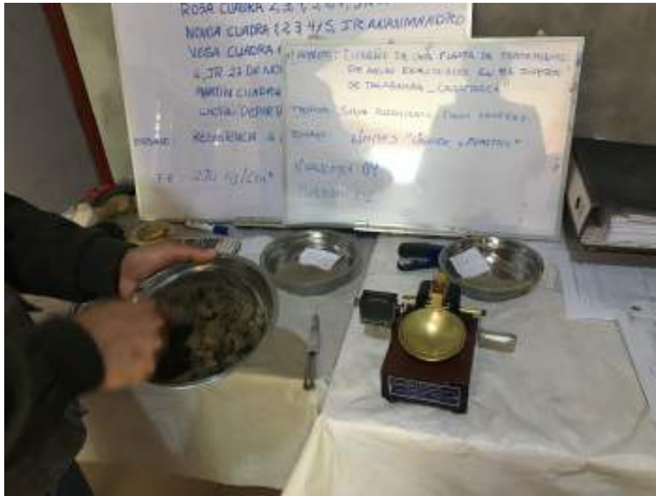
FOTO 27. MUENTRAS PARA REALIZAR ENSAYO DE LIMITE LÍQUIDO CON EL INSTRUMENTO CAZUELA DE CASA GRANDE
