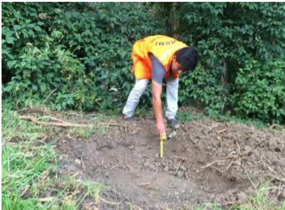
FOTO 12. MEDICION DE LA ALTURA DEL TERRENO NATURAL EN UN RANGO DE 20cm A 40cm
