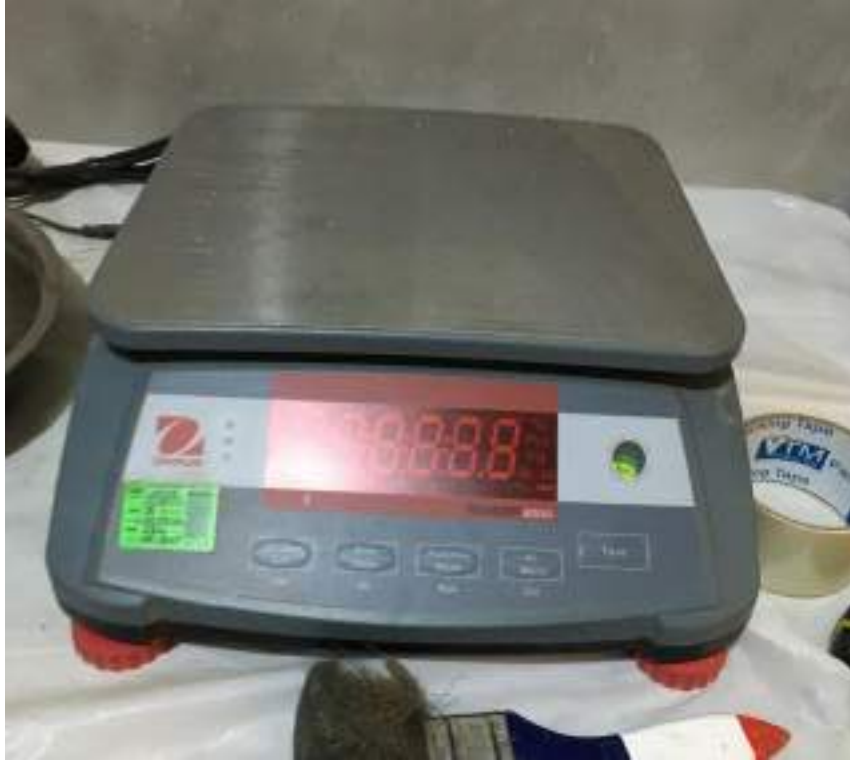
FOTO 03. BALANZA UTILIZADA CON UNA PRECISION DE 15 Kg.
