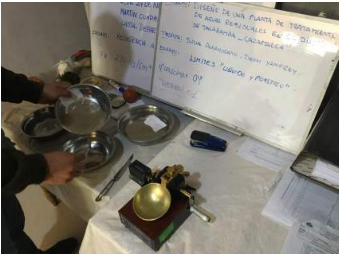
FOTO 26. MUESTRAS PARA REALIZAR ENSAYO DE LIMITE LÍQUIDO CON EL INSTRUMENTO CAZUELA DE CASA GRANDE
