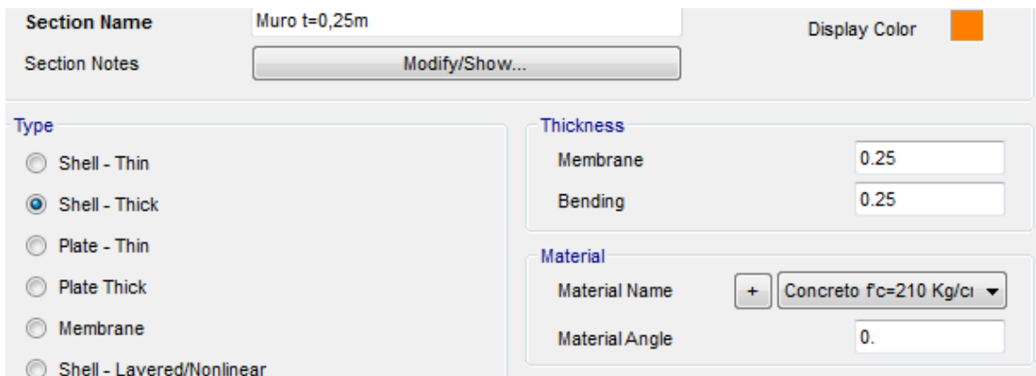
Figura 7 - Definición del elemento shell para vigas
