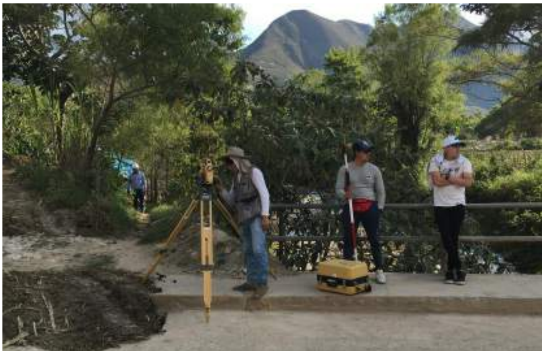
FOTO 08. TOMA DE PUNTOS A LO LARGO DEL AMBITO DEL INFLUENCIA DEL PROYECTO
