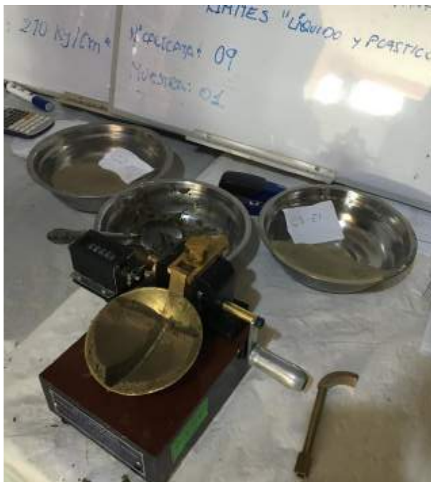
FOTO 28. MUENTRAS PARA REALIZAR ENSAYO DE LIMITE LÍQUIDO CON EL INSTRUMENTO CAZUELA DE CASA GRANDE
