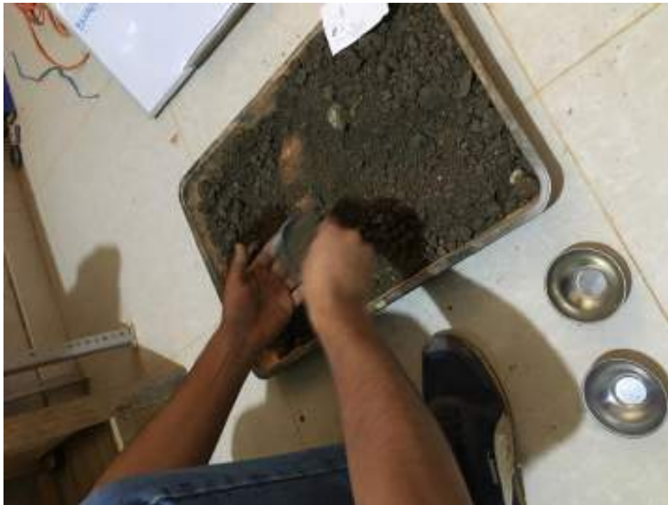
FOTO 06. SELECCIONANDO 3 TARAS CON MUESTRAS PARA EL ENSAYO DE CONTENIDO DE HUMEDAD
