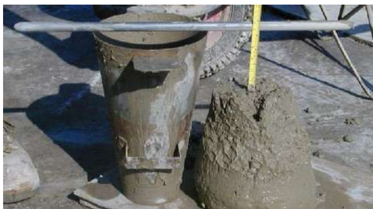
Figura 8. Cono de Abrams. Medición de asentamiento.
