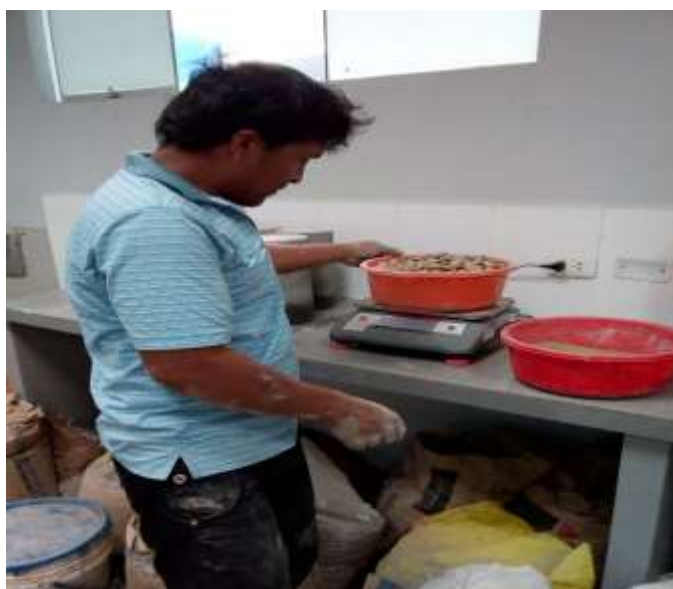
Descripción: Medición de agregado grueso
