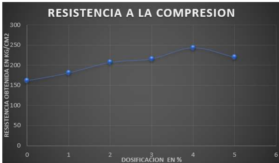
Figura 9. Resistencia a la compresión vs porcentaje de aditivo SOQUIMIC
