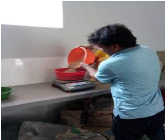
Descripción: Medición de agregado fino
