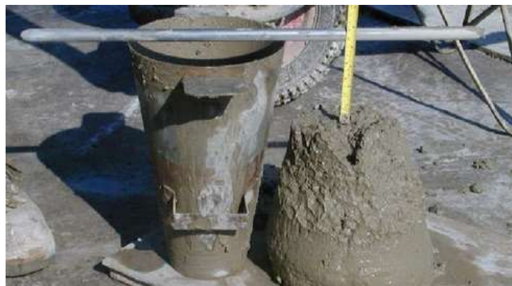
Descripción: Asentamiento del concreto
