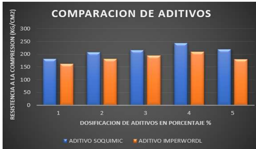
Figura 11. Comparación de resultados de compresión
