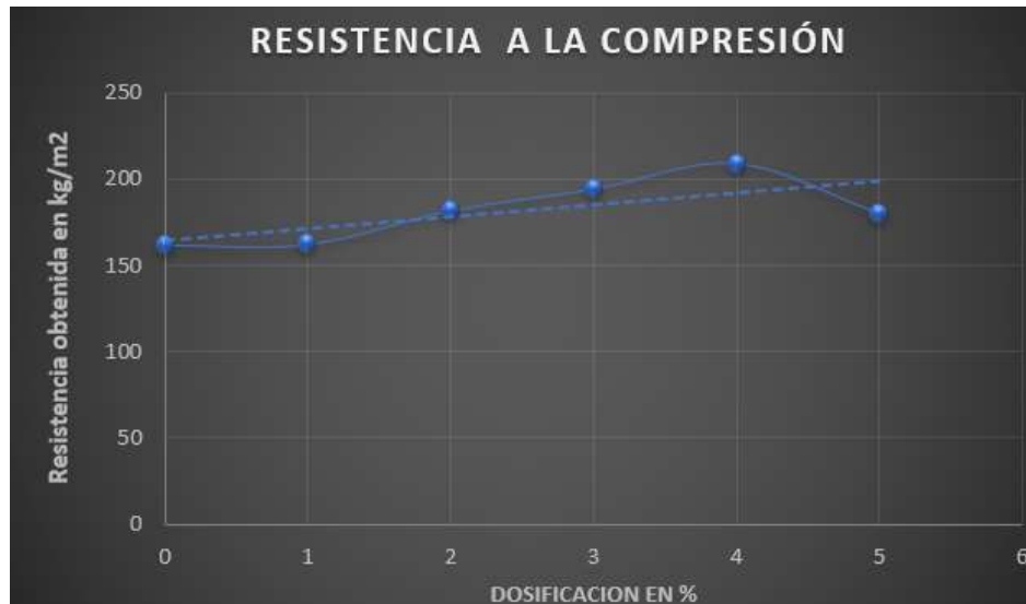
Figura 10. Resistencia a la compresión vs porcentaje de aditivo IMPERWORLD ACELERANTE
