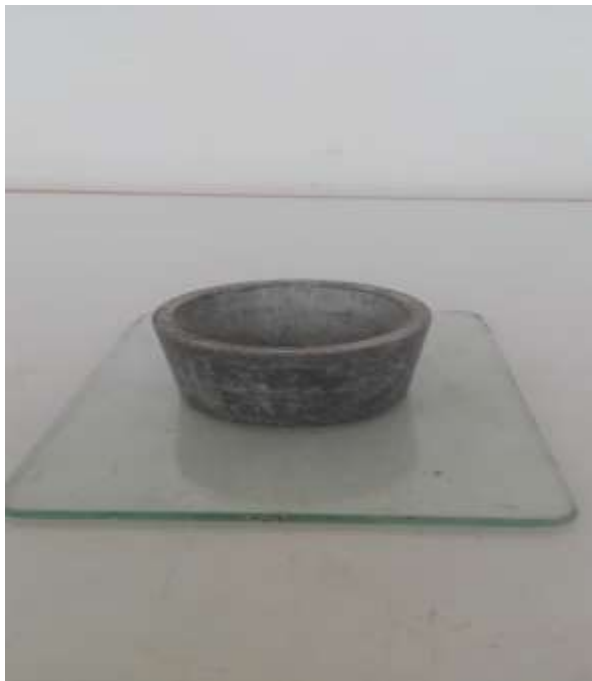
Descripción: molde cónico (aguja vicat) – invertido
