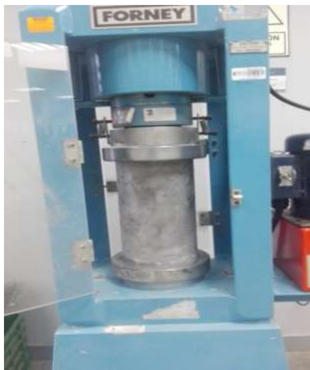
Descripción: Rotura de probetas
