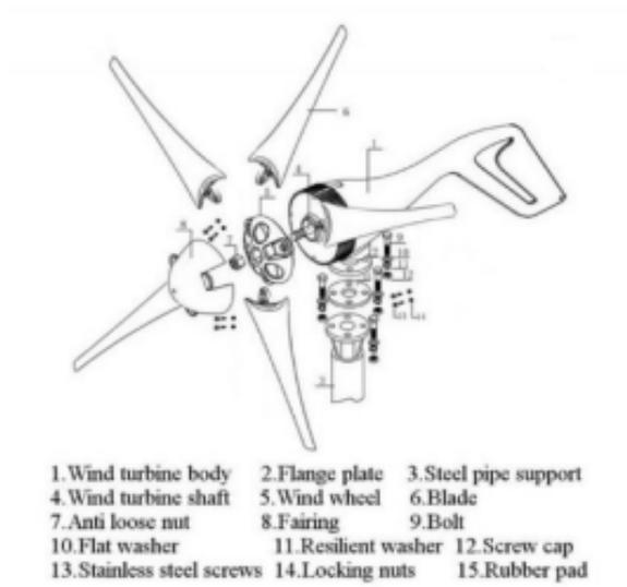
Figura 11. Estructura del aerogenerador
