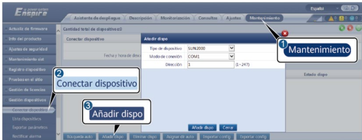
Figura 32. Configuración de parámetros del inversor SUN2000.
