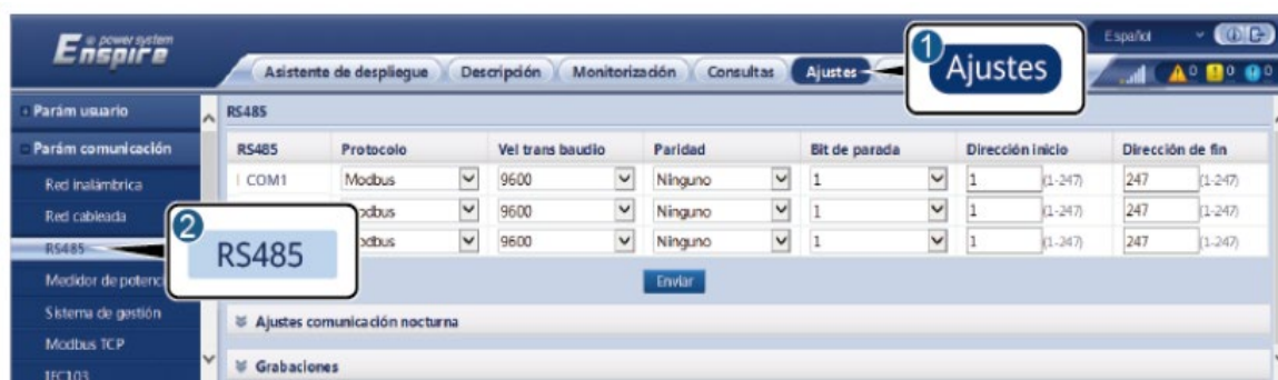
Figura 31. Configuración de los parámetros de RS48.
