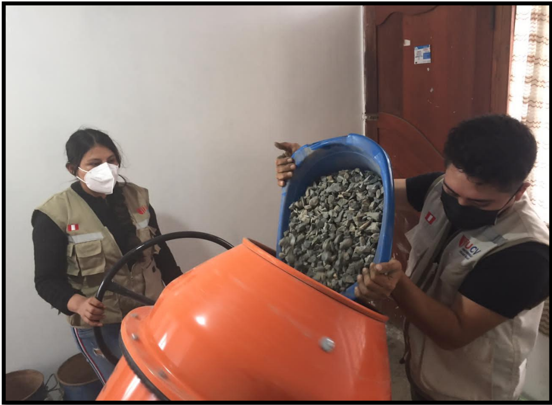
Fotografía 7: Realización de la mezcla para elaboración de las probetas
