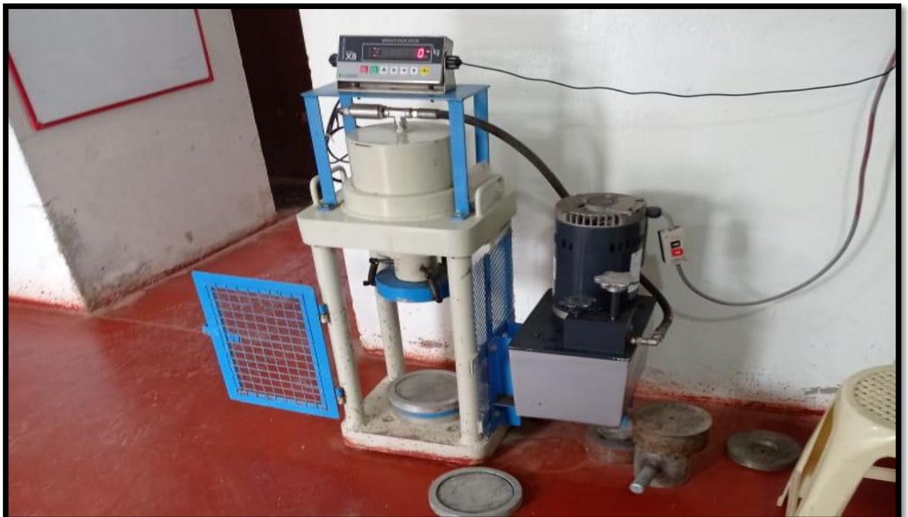
Fotografía 11: Ensayo de resistencia a la compresión
