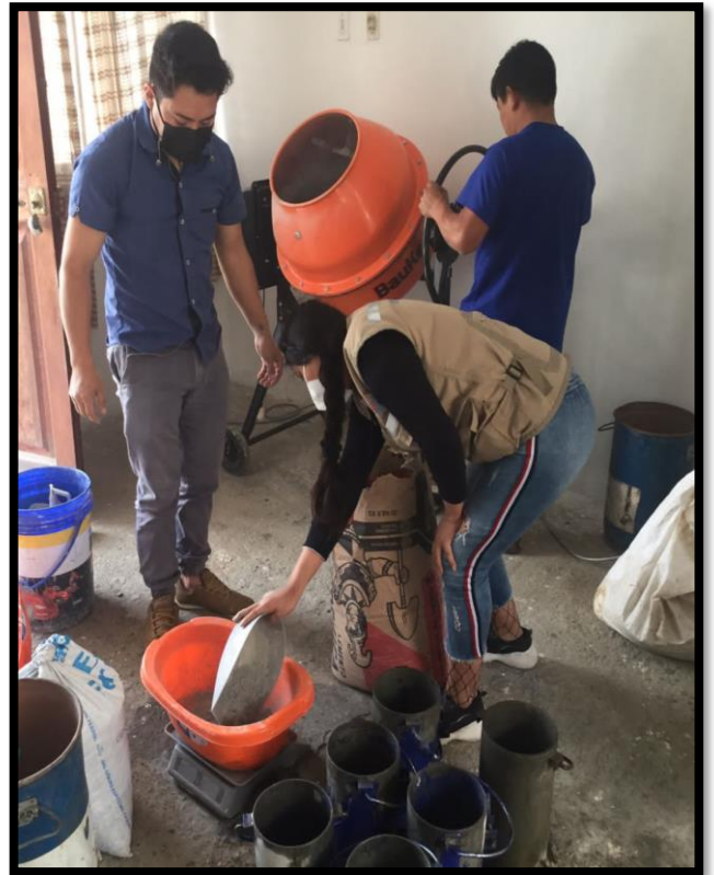
Fotografía 4: Realizando el peso del cemento para la mezcla de concreto
