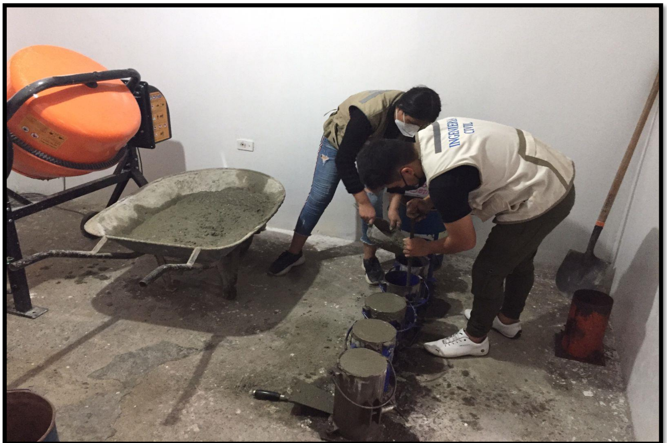
Fotografía 9: Realización de los 25 golpes en las tres capas del molde por cada probeta elaborada.
