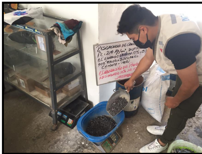
Fotografía 5: Realizando el peso de la escoria siderúrgica para la mezcla de concreto
