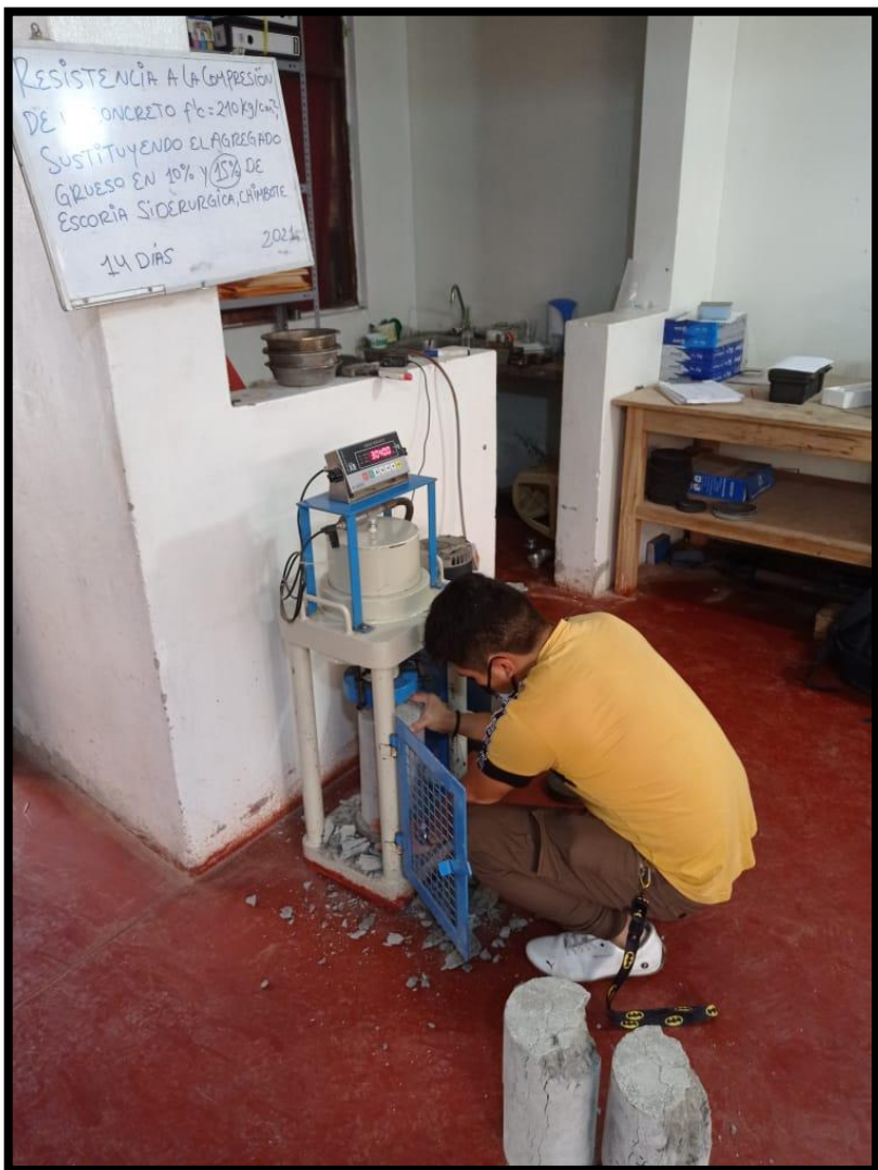
Fotografía 14: Ensayo de resistencia a la compresión del 15% a los 14 días
