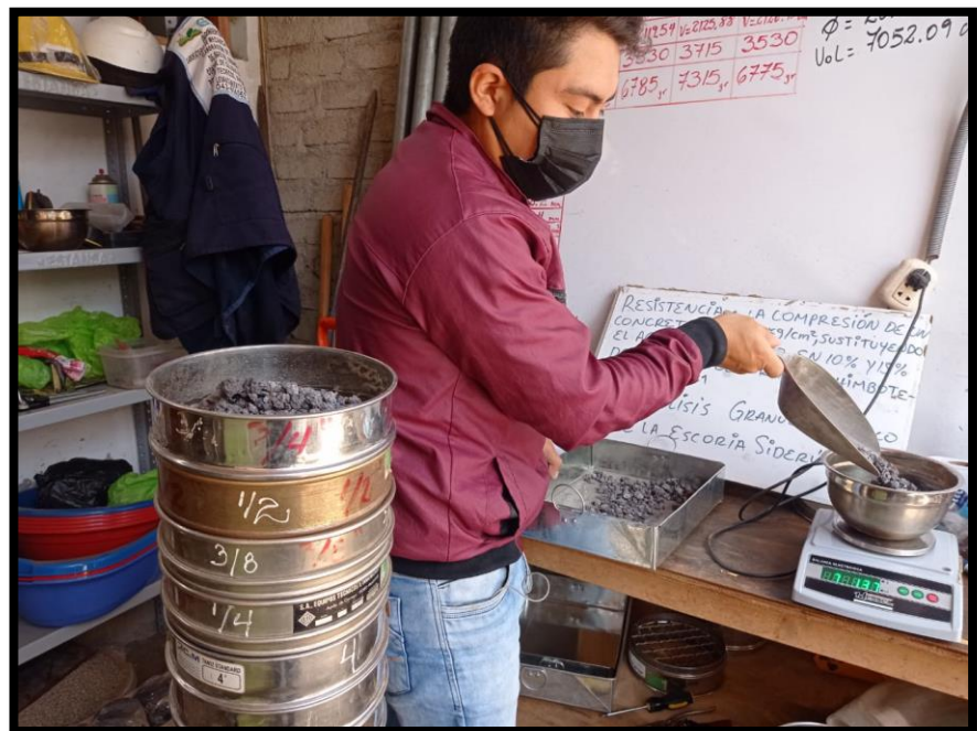
Fotografía 2: Tamizado y Peso de cada Tamiz de la Escoria siderúrgica
