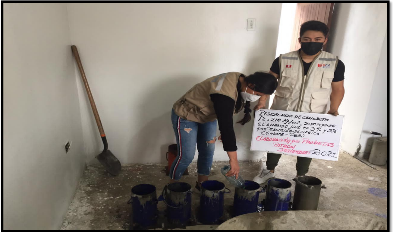
Fotografía 8: Realización del vaciado de petróleo a los moldes cilíndricos.
