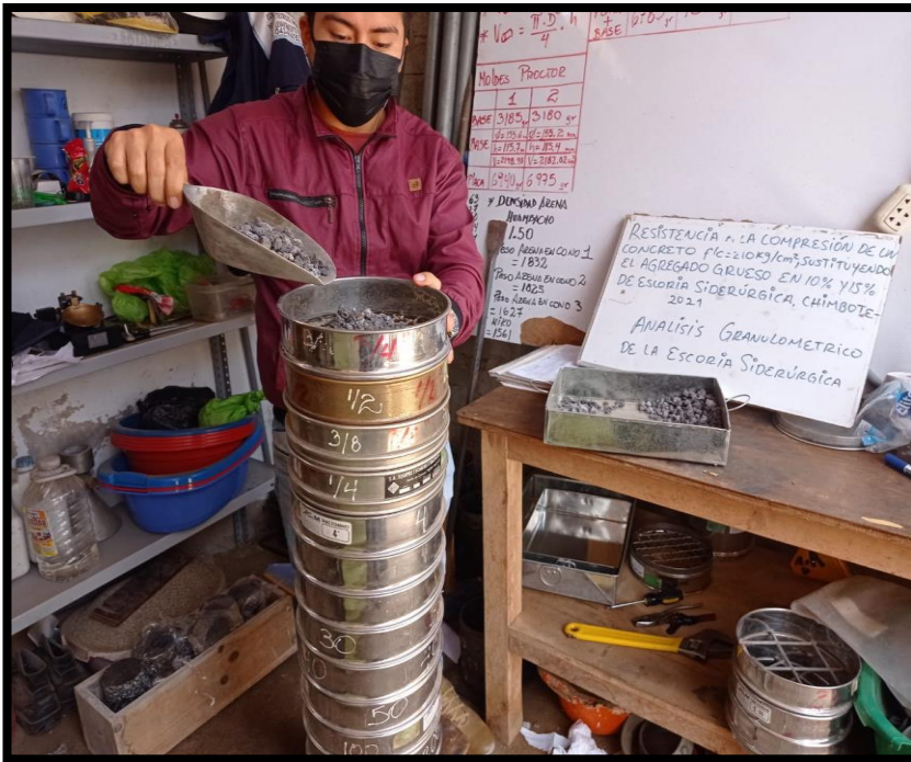
Fotografía 1: Realización del ensayo de granulometría.
