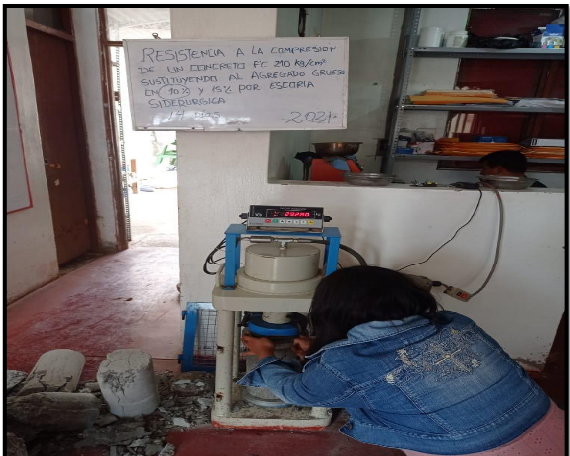
Fotografía 13: Ensayo de resistencia a la compresión del 10% a los 14 días
