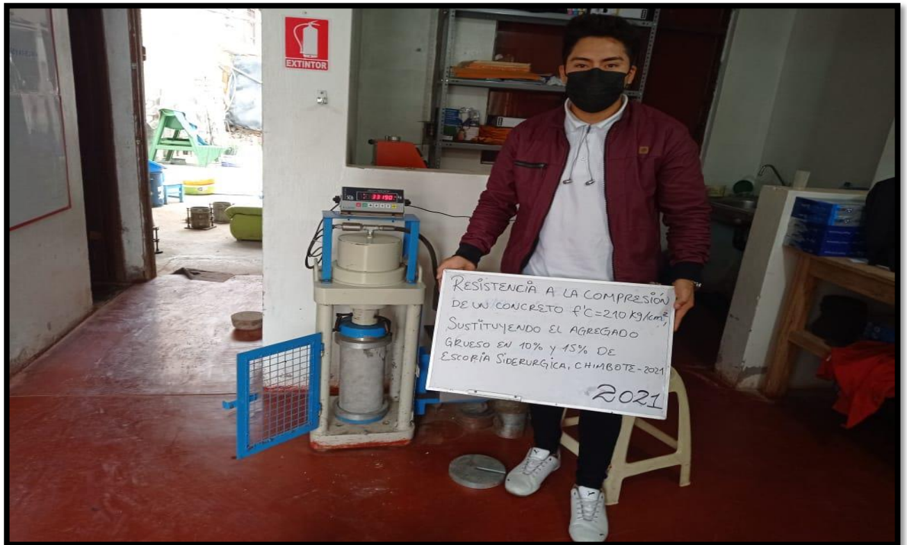
Fotografía 12: Ensayo de resistencia a la compresión del 15% a los 7 días
