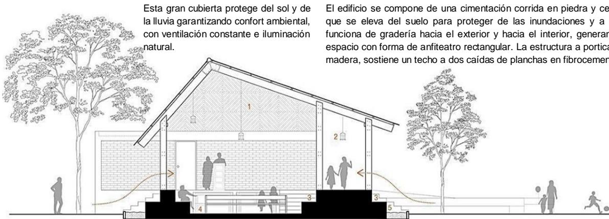
Esta gran cubierta protege del sol y de la lluvia garantizando confort ambiental, con ventilación constante e iluminación natural.
