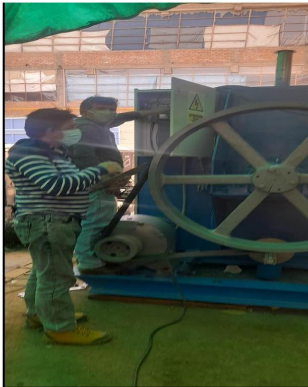
Figura 17. Revisión del montaje de la polea de la máquina
