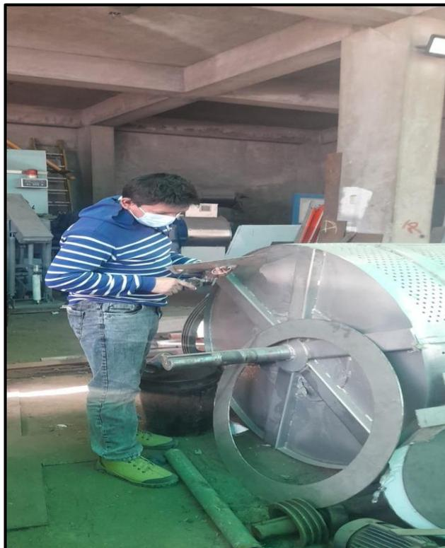
Figura 19. Revisión del eje y tambor de la máquina
