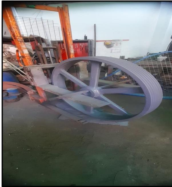
Figura 14. Desmontado de la polea
