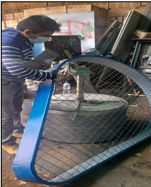
Figura 20. Revisión de la cinta de seguridad de la polea
