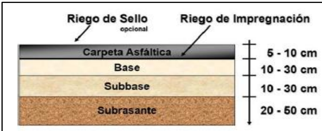
Figura 17: Estructura del pavimento flexible
