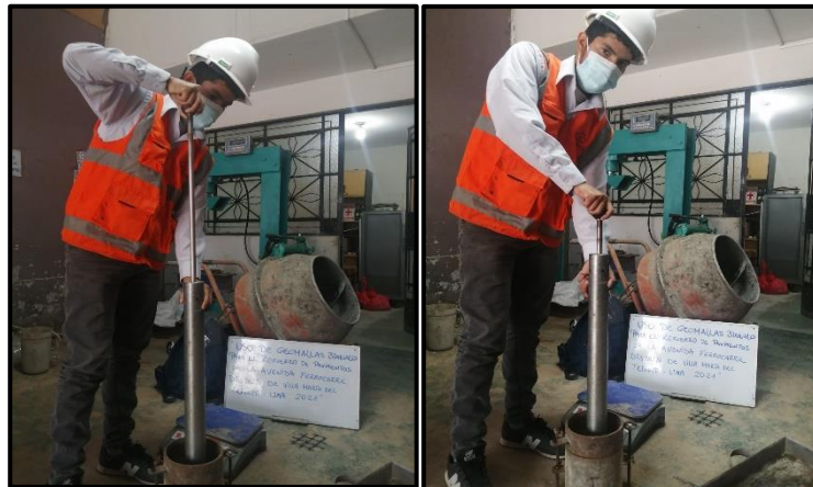
Figura 6. Laboratorio compactación con el pisón Fuente: Elaboración propia
