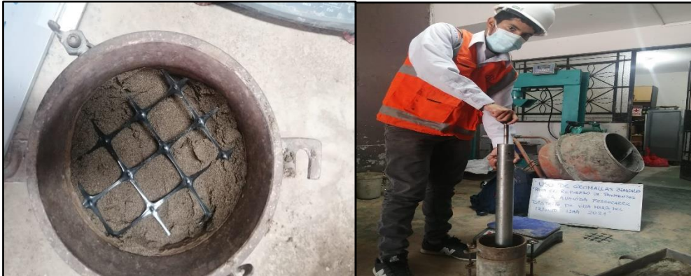
Figura 9. Se añadió la Geomalla Biaxial y se procedió a compactar Fuente: Elaboración propia
