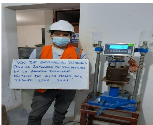
Figura 11. Aplicación de carga mediante la prensa CBR Fuente: Elaboración propia
