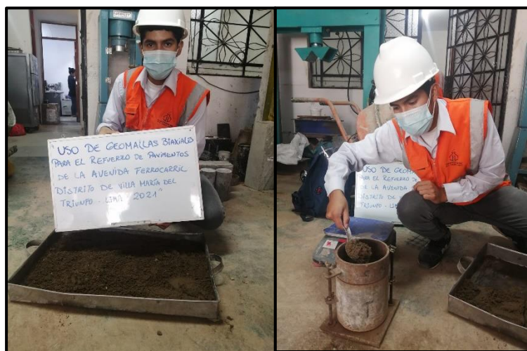
Figura 5. Ensayo Próctor Modificado Fuente: Elaboración propia
