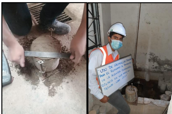
Figura 10. Se añadió la Geomalla Biaxial y se llevó a la poza Fuente: Elaboración propia
