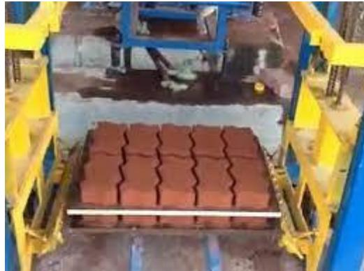
*Figura 17. Moldeado mecánico del adoquín de concreto*
