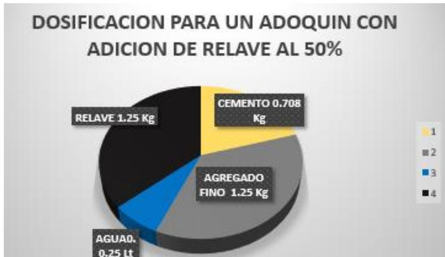
Figura 66. Dosificación con adición del 50% de relave.
