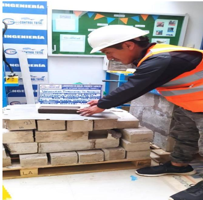
*Figura 58.* Prueba de variación dimensional
