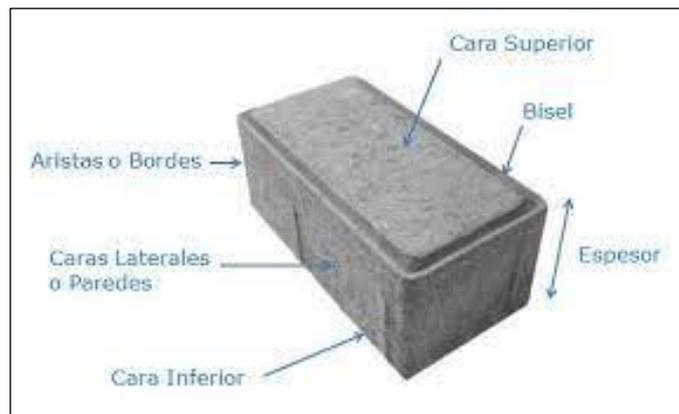
Figura 9. Se observa partes de un adoquín de concreto
