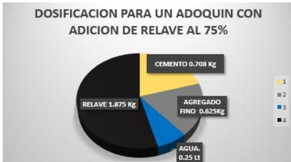
Figura 67. Dosificación con adición del 75% de relave.
