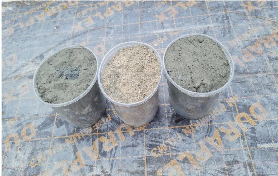
*Figura 45.* Se observa las tres muestras de relave de diferentes zonas
