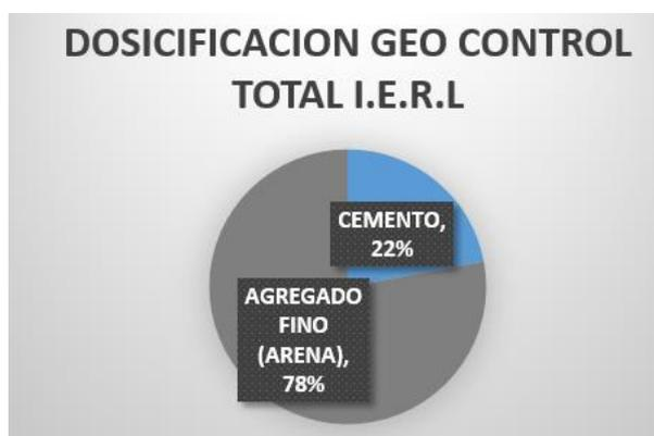
Figura 61. Dosificación de Geo Control Total E.I.R.L.
