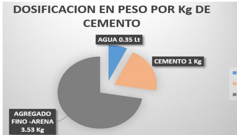
Figura 64. Dosificación en peso por kilogramo de cemento
