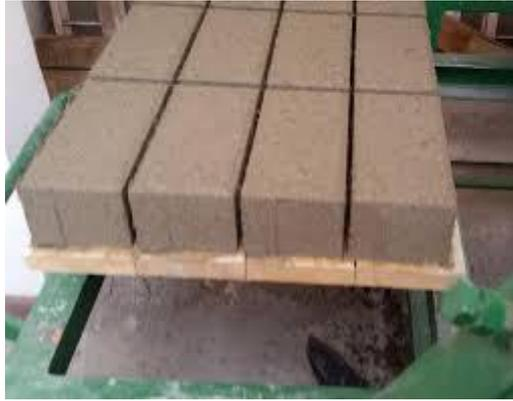
*Figura 18.* Fraguado del adoquín de concreto
