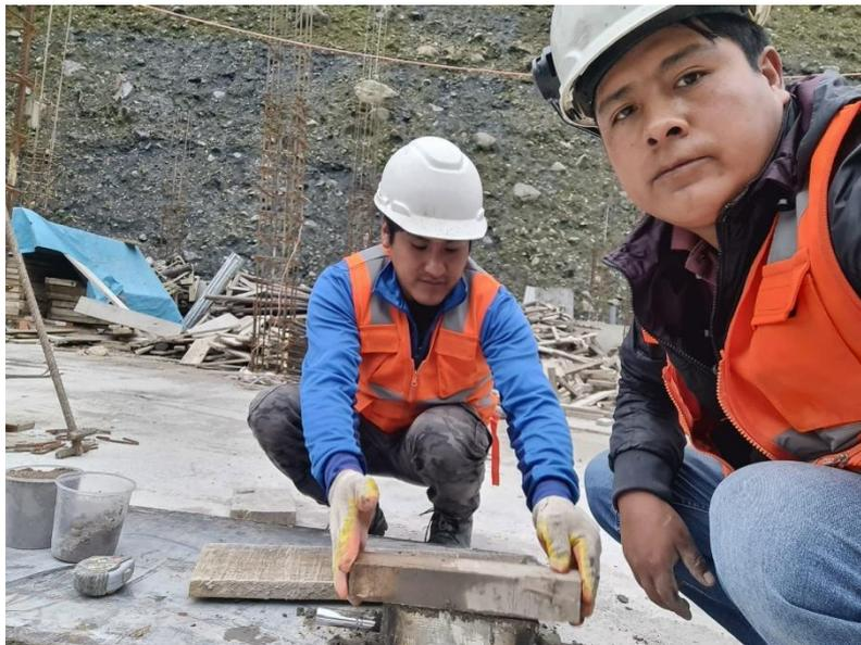
*Figura 55.* Se observa el llenado en el molde para adoquín con mezcla con adición de relave.
