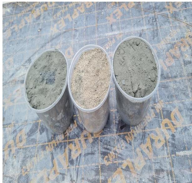
Figura 50. Colocado de muestras de relave para envío al laboratorio.
