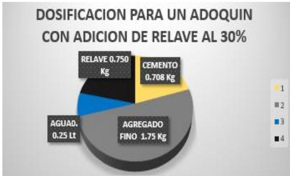
Figura 65 Dosificación con adición del 30% de relave.
