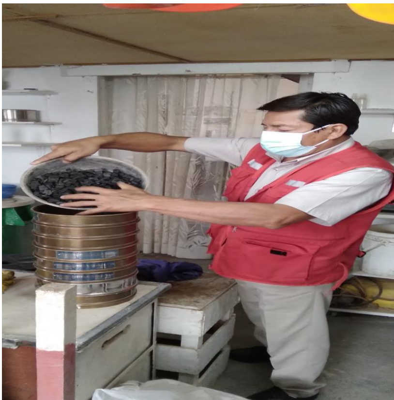
Foto 11. Ensayo de Granulometría
