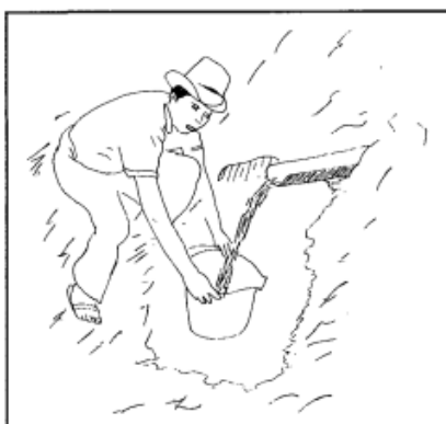
Figura 3.6 : Aforo del agua por el método volumétrico
