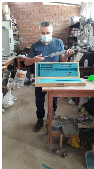
Figura 6. Realizando la penetración a las probetas de concreto de 0,50% de adición de mucílago de tuna con el instrumento llamado Penetrómetro con fuerza como máximo de 130 Lbf.
