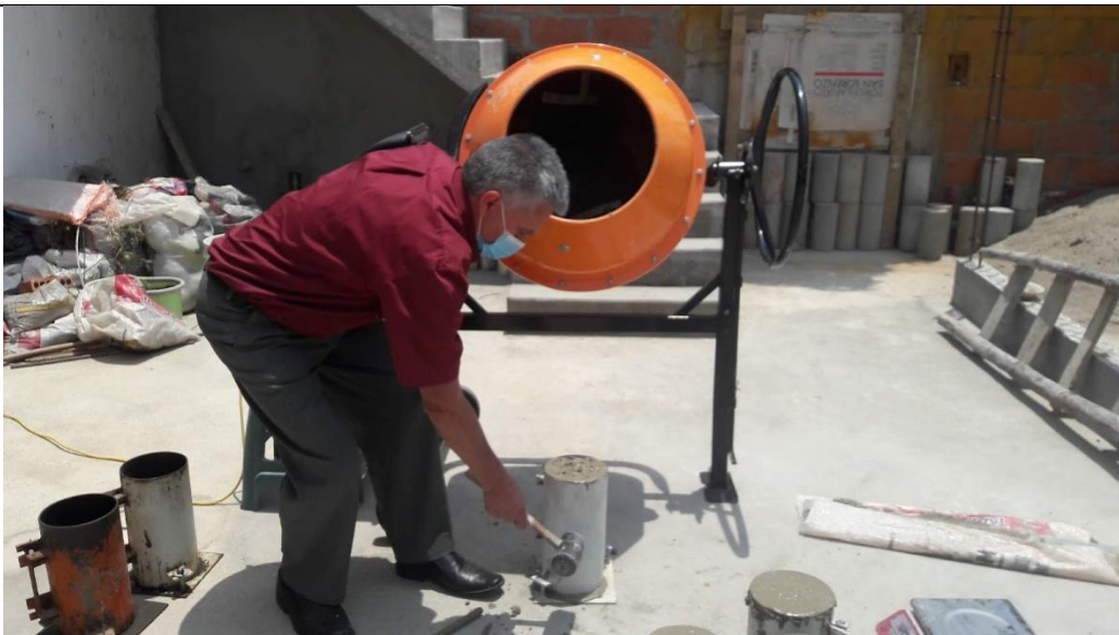
Figura 12. El llenado de probetas de mezcla de concreto para la probeta patrón.
