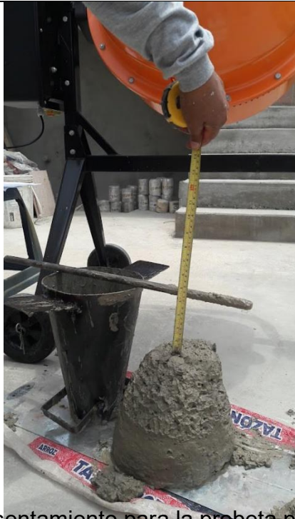
Figura 11. El ensayo de asentamiento para la probeta patrón es de 3".
