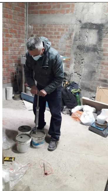
Figura 6. Realizando la penetración a las probetas de concreto de 0,50% de adición de mucílago de tuna con el instrumento llamado Penetrómetro con fuerza como máximo de 130 Lbf.
