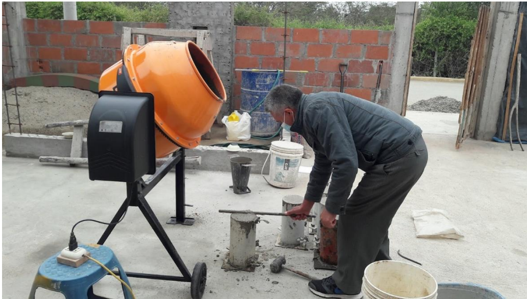
Figura 15. El llenado de probetas de mezcla de concreto para la probeta con adición de mucílago de tuna de 0,25 % y 0,50 %.
