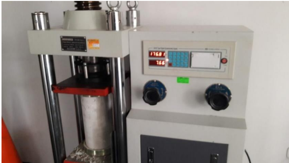
Figura 5. Instrumento de medición de la resistencia a compresión del concreto
