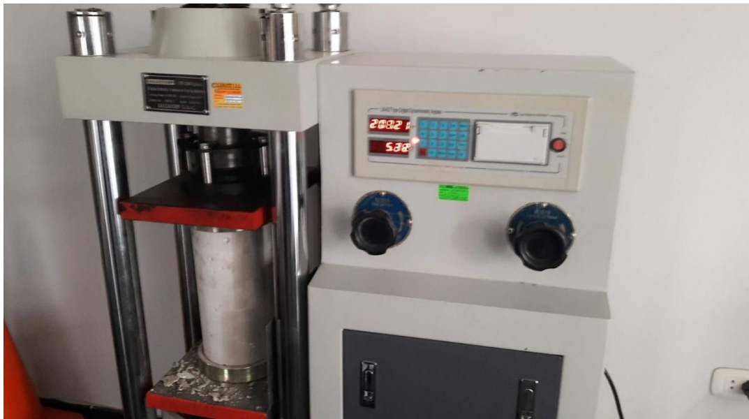
Figura 18. Rotura de la primera probeta patrón, a los 7 días Fuente: Elaboración propia.
