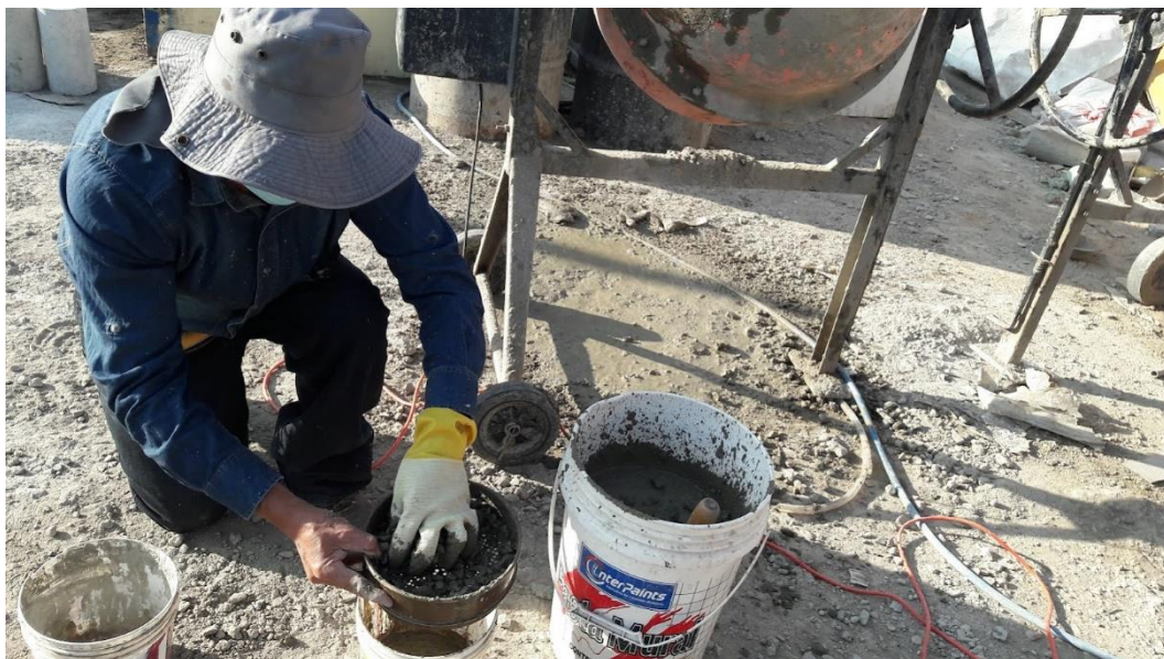
Figura 4. La mezcla de concreto pasa por el tamiz N°4, de 4.75 mm, y va quedando la muestra de mortero de concreto en el molde de altura de 150 mm. Fuente: Elaboración propia.
