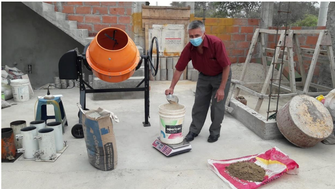
Figura 10. Realizando las mediciones de los pesos de agregados fino y grueso, cemento y agua para probeta patrón según el diseño de mezcla para el concreto.
