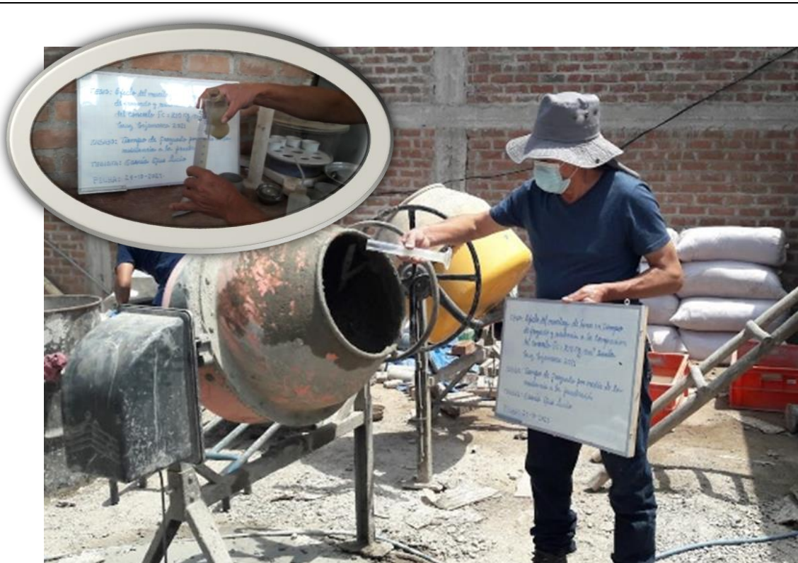
Figura 5. Midiendo el mucílago de tuna para la adición de 0,25% a la probeta de concreto y luego se vierte a la mezcladora para la mezcla respectiva.
