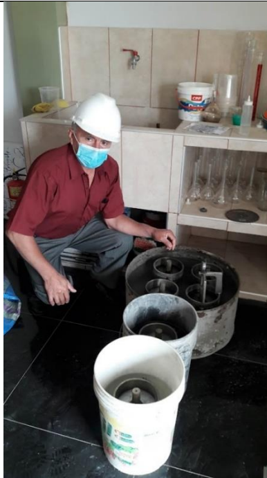
Figura 7. Las herramientas para los ensayos de los agregados para el concreto f'c=210 \text{ kg/cm}^2
