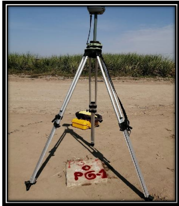
Fotografía N°10: Estacionamiento del receptor GNSS Stonex S800 sobre el punto PG-01
