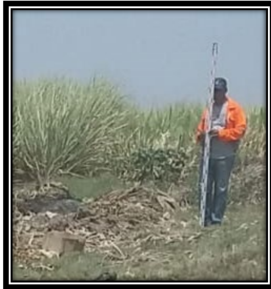
Foto N° 08.- Se aprecia al ayudante del nivelador realizando la nivelación de la regla, también llamada mira para realizar la nivelación geométrica compuesta.
