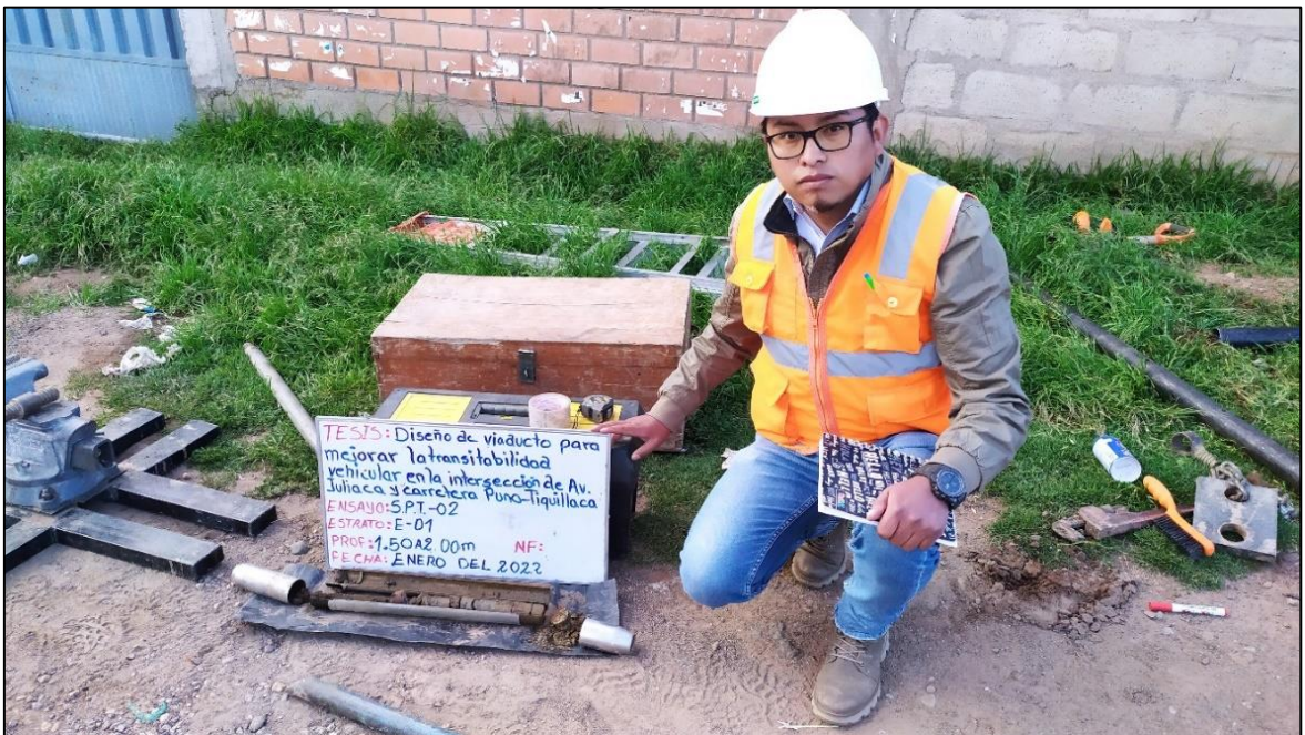
Figura 26: SPT-02 muestra 02 a una profundidad de 2.00 metros.
