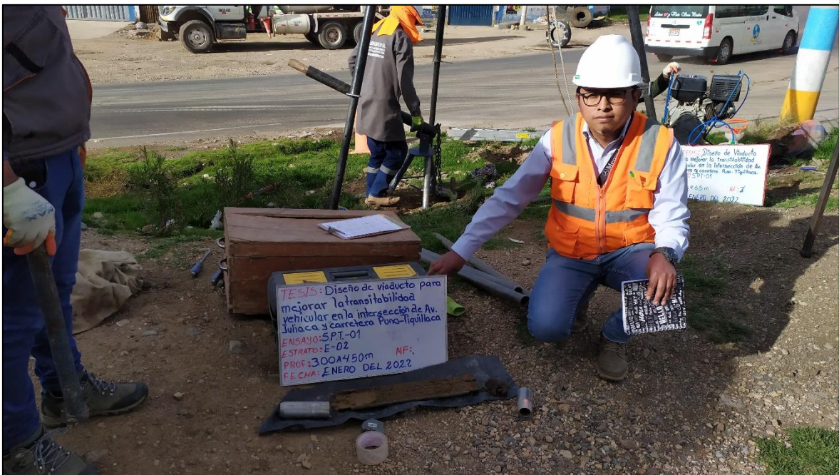
Figura 24: SPT-01 muestra 03 a una profundidad de 4.50 metros.
