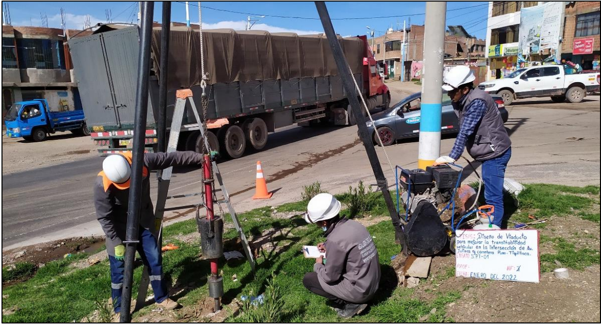
Figura 23: Desarrollo del ensayo de penetración estándar SPT-01.
