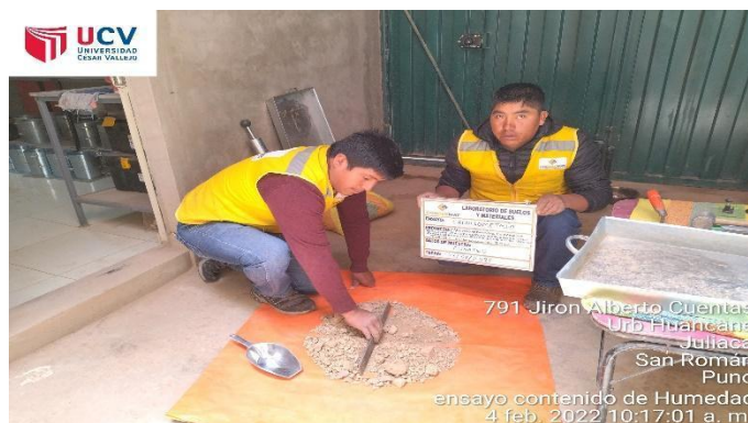
Figura 12. Paso 7. Se realizó la selección del material para determinar la granulometría de suelos.
