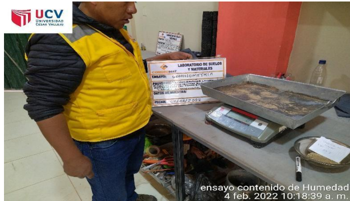
Figura 13. Paso 8. Se realizó el pesado y selección del material granular en la balanza analítica en el laboratorio
