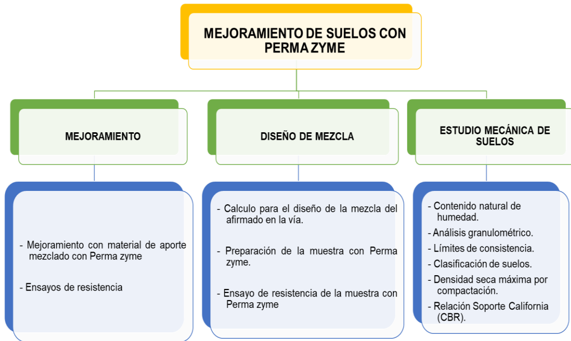
Figura 5. Proceso del mejoramiento de la resistencia de suelos de la capa de rodadura no pavimentada del tramo Taraco – Huancollusco.
