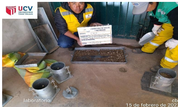
Figura 17. Paso 12. Se realizó la determinación del CBR al 100% compactado
