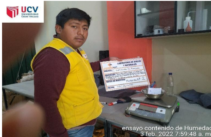
Figura 10. Paso 5. Se realizó la determinación del contenido natural de humedad en el laboratorio
