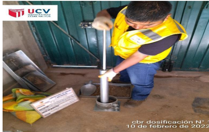
Figura 16. Paso 11. Se realizó la compactación del suelo con Proctor modificado en el laboratorio
