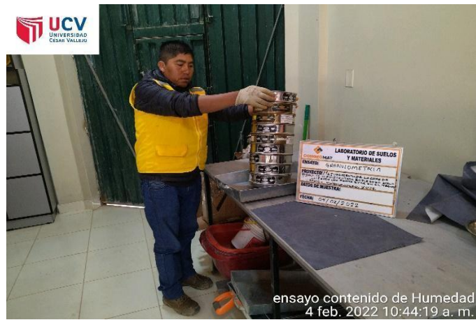
Figura 14. Paso 9. Se realizó la determinación de la granulometría en los tamices del laboratorio
