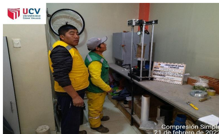
Figura 18. Paso 13, se realizó la compresión simple del CBR en el laboratorio
