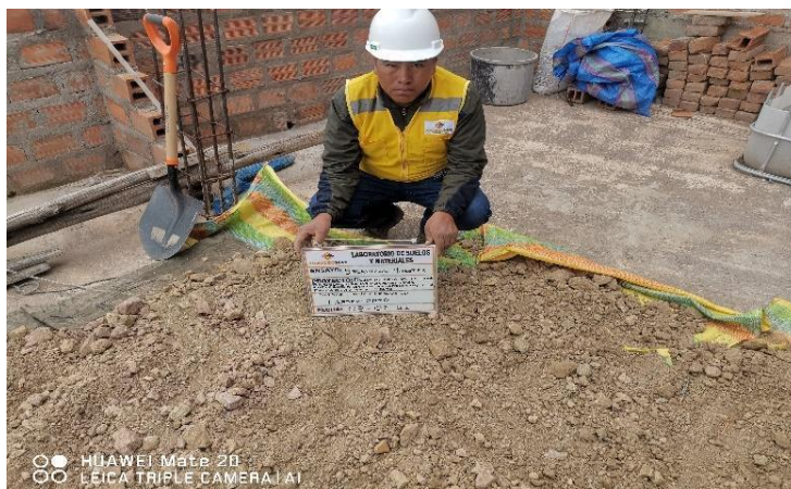
Figura 9. Paso 4. Se realizó el secado de muestras extraídas en el laboratorio para obtener los resultados de los suelos naturales
