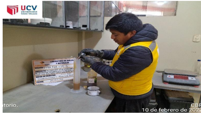
Figura 19. Paso 14. Se realizó la dosificación de la enzima orgánica Perma-Zyme en el laboratorio
