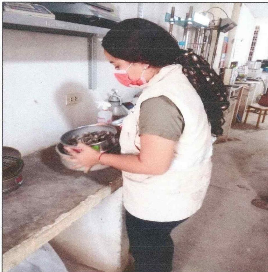
Proceso de pesado de material agregado fino para lavado por tamiz N° 200 Ensayo de ensayo de tamizado mecánico (granulometría) NTP 400.012 – AGREGADOS, análisis granulométrico del agregado fino, grueso y global.
