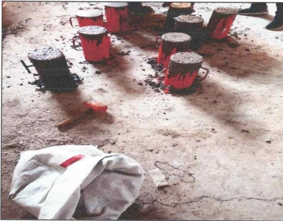
Realización de moldeo patrón de probetas de 15 x 30 cm – Hormigón concreto método de ensayo normalizado para la determinación de la resistencia a la compresión del concreto en muestras cilíndricas. NTP 339.034 – 2008. con adición de fibras de polipropileno de calidad  $f'c = 210 \text{ Kg/cm}^2$  al 0.50 %.
