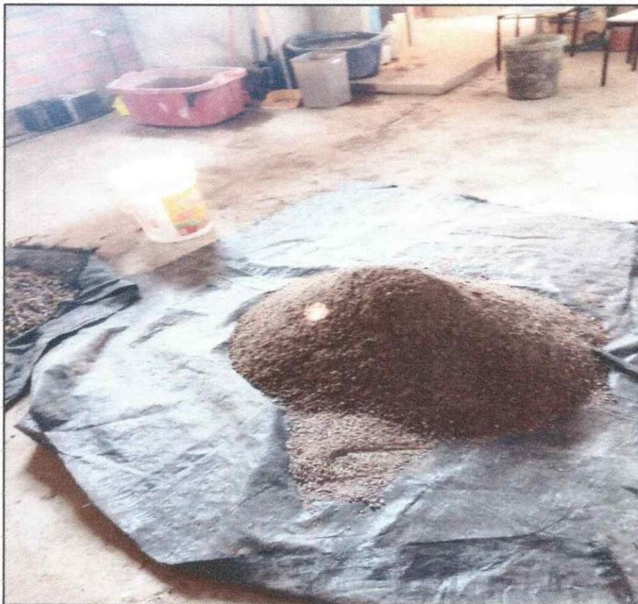
Proceso de pesado de materiales, agregado fino y grueso y cemento para el moldeo del concreto y elaboración de cilindros de concreto con adición de fibras de polipropileno de calidad  $f_c = 210 \text{ Kg/cm}^2$ .
