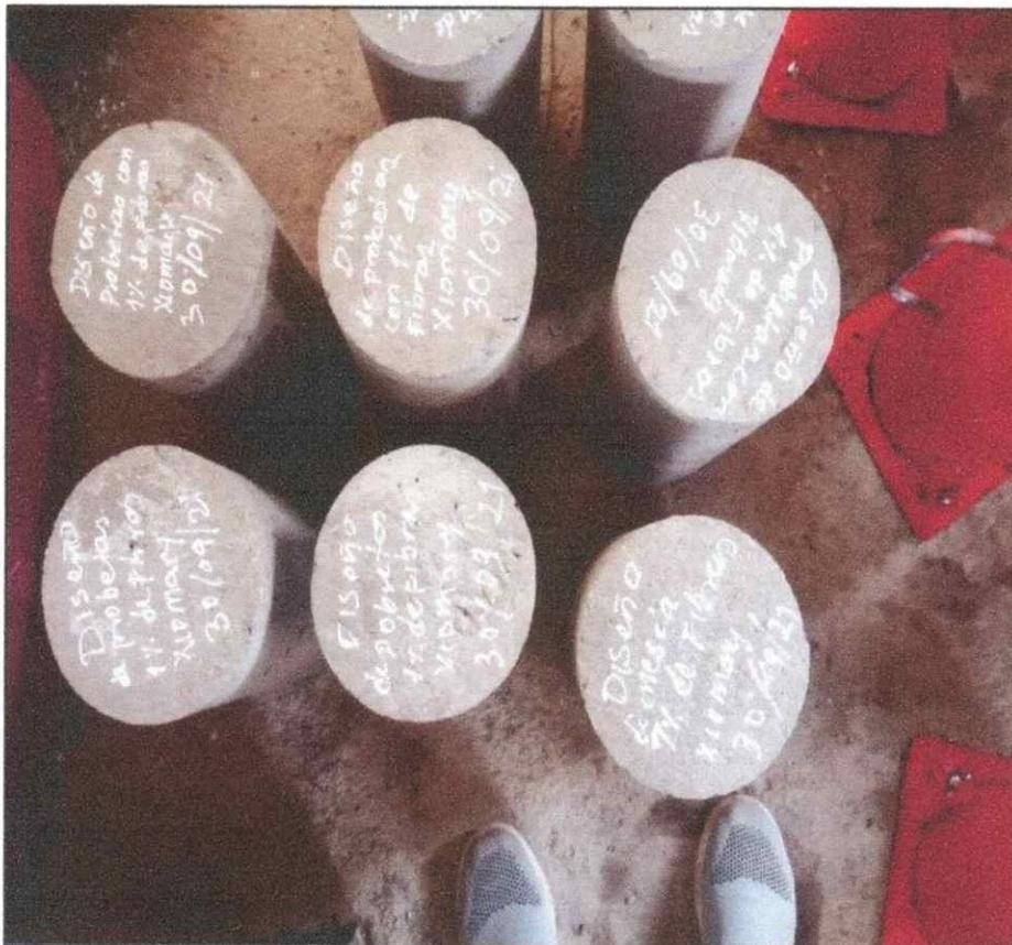
Proceso de identificación de, fecha, porcentaje de adición y f'c de diseño de probetas de 15 x 30 cm – Hormigón concreto método de ensayo normalizado para la determinación de la resistencia a la compresión del concreto en muestras cilíndricas. NTP 339.034 – 2008.
