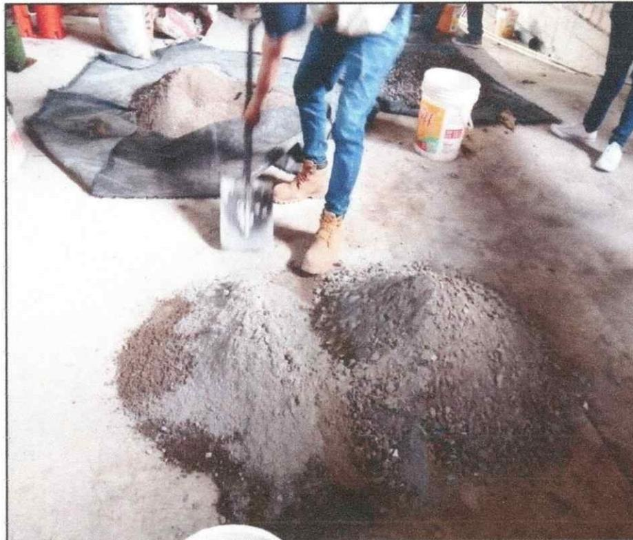
Proceso de pesado de materiales, agregado fino y grueso y cemento para el moldeado del concreto y elaboración de cilindros de concreto con adición de fibras de polipropileno de calidad  $f_c = 210 \text{ Kg/cm}^2$ .
