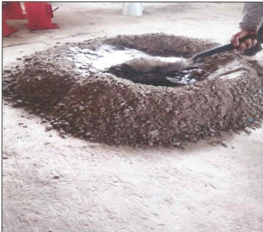
Proceso de pesado de materiales, agregado fino y grueso y cemento para el moldeo del concreto y elaboración de cilindros de concreto con adición de fibras de polipropileno de calidad  $f_c = 210 \text{ Kg/cm}^2$ .
