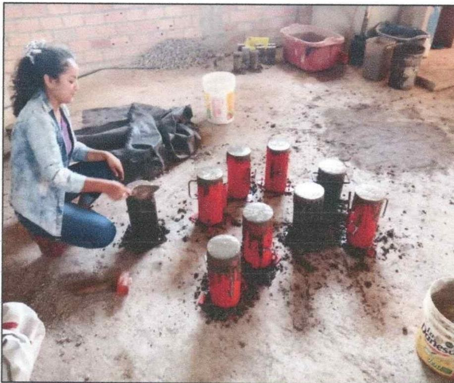
Realización de moldeo patrón de probetas de 15 x 30 cm – Hormigón concreto método de ensayo normalizado para la determinación de la resistencia a la compresión del concreto en muestras cilíndricas. NTP 339.034 – 2008. con adición de fibras de polipropileno de calidad  $f'c = 210 \text{ Kg/cm}^2$  al 0.75 %.
