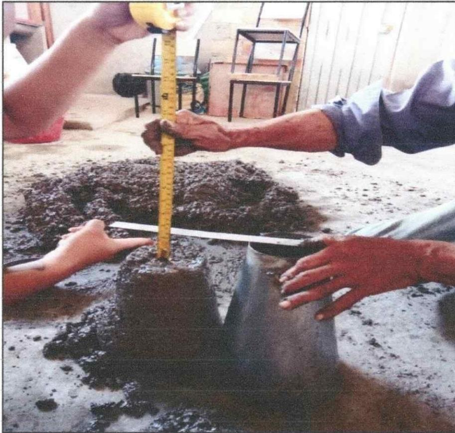
Realización de medición del ensayo de asentamiento "SLUMP" de 3" a 4" HORMIGÓN (CONCRETO). Método de ensayo para la medición del asentamiento del concreto de cemento Portland - NTP 339.035 – 2009.
