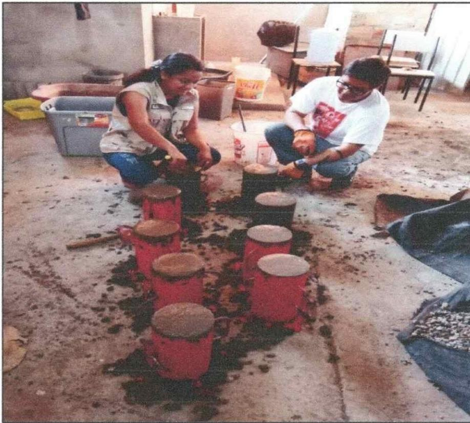
Realización de moldeo patrón de probetas de 15 x 30 cm – Hormigón concreto método de ensayo normalizado para la determinación de la resistencia a la compresión del concreto en muestras cilíndricas. NTP 339.034 – 2008. con adición de fibras de polipropileno de calidad  $f'c = 210 \text{ Kg/cm}^2$  al 1.00 %.
