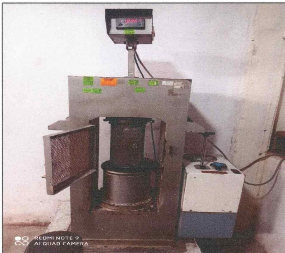
Realización de ensayo normalizado para la determinación de la resistencia a la compresión del concreto en muestras cilíndricas. NTP 339.034 – 2008.
