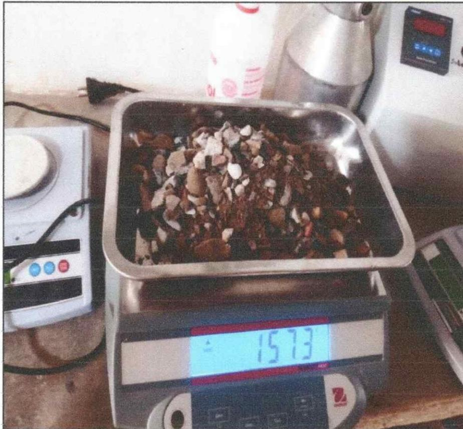
Proceso de pesado de material agregado fino para lavado por tamiz N° 200 Ensayo de ensayo de tamizado mecánico (granulometría) NTP 400.012 – AGREGADOS, análisis granulométrico del agregado fino, grueso y global.
