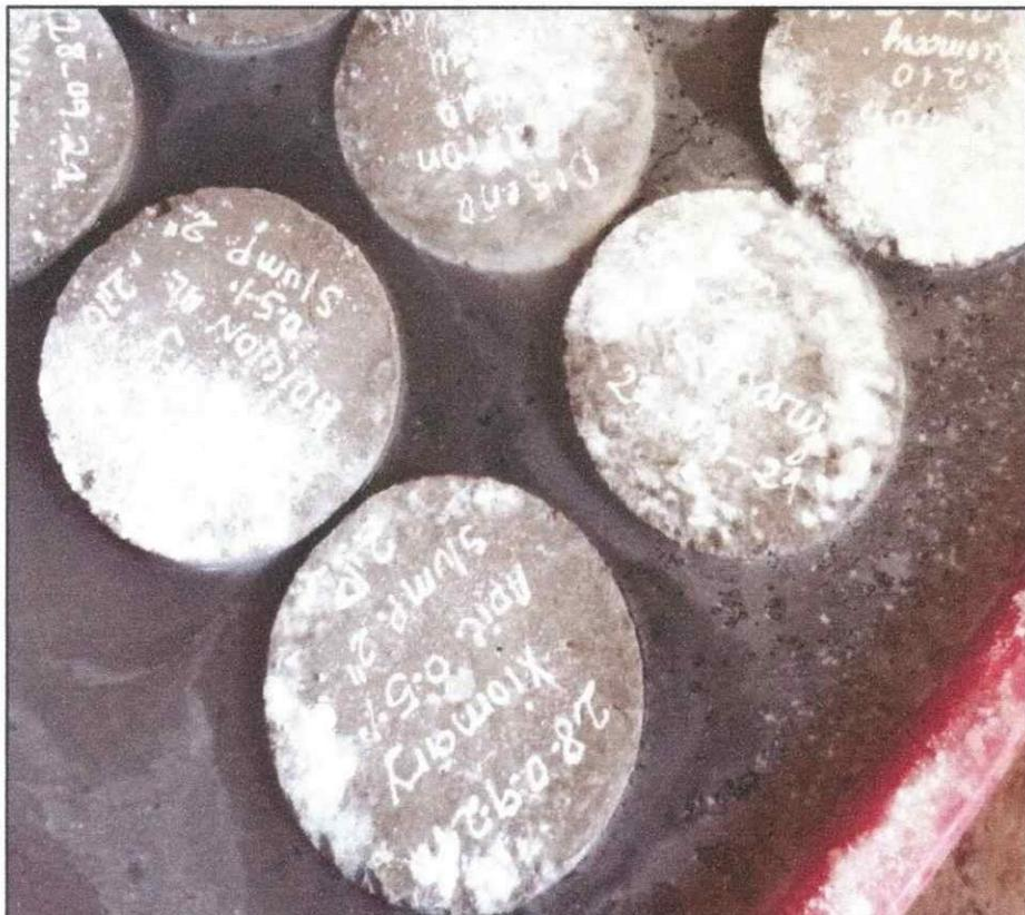
Proceso de curado en agua con fechas, 1, 14 y 28 de probetas de 15 x 30 cm – Hormigón concreto método de ensayo normalizado para la determinación de la resistencia a la compresión del concreto en muestras cilíndricas. NTP 339.034 – 2008.
