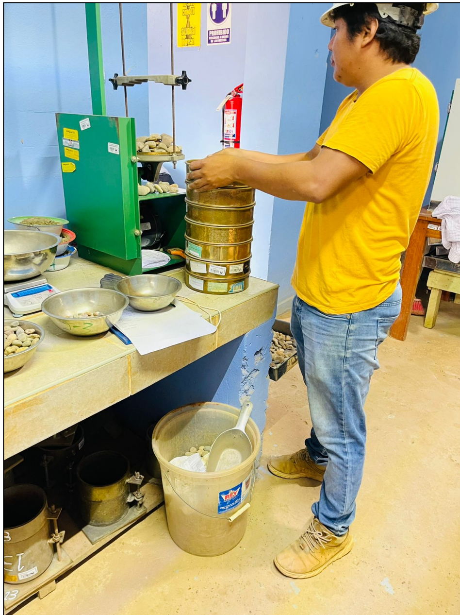
Figura 12. Tamizado del agregado grueso
