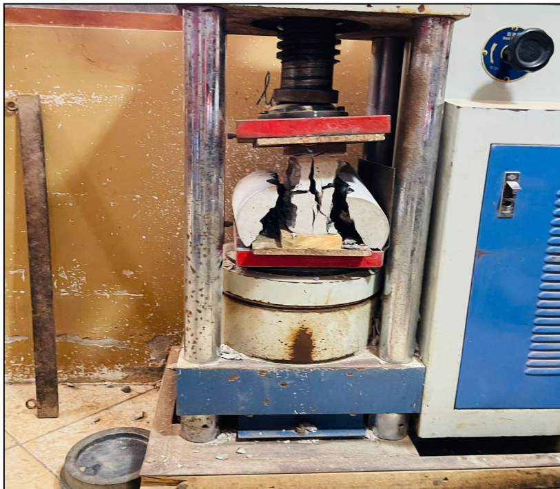
Figura 24. Ensayo a tracción indirecta
