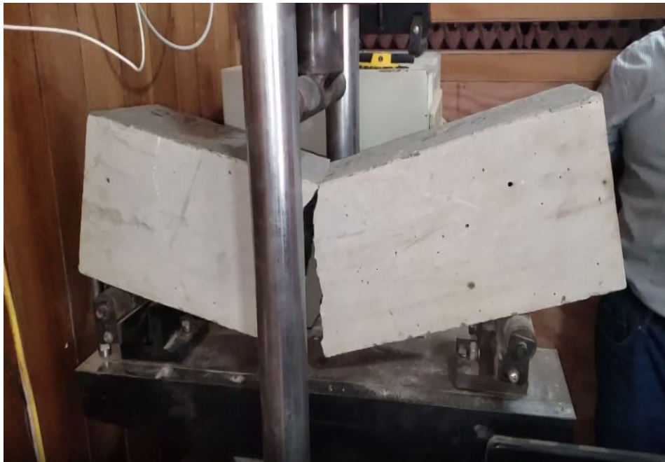
FOTO N° 14: Ensayo a flexión
