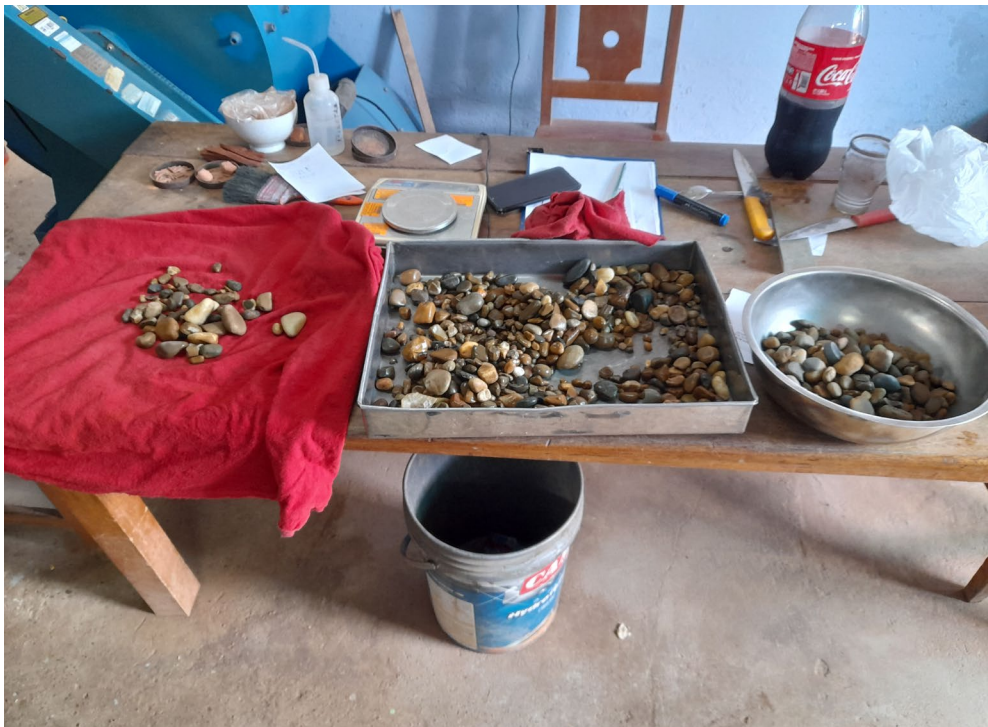
FOTO N° 09: Agregado grueso saturado superficialmente seco
