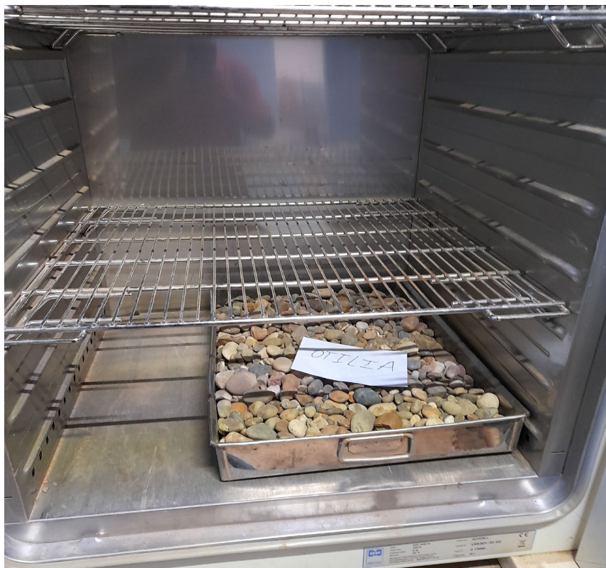
FOTO N° 07: Secado en horno del agregado grueso
