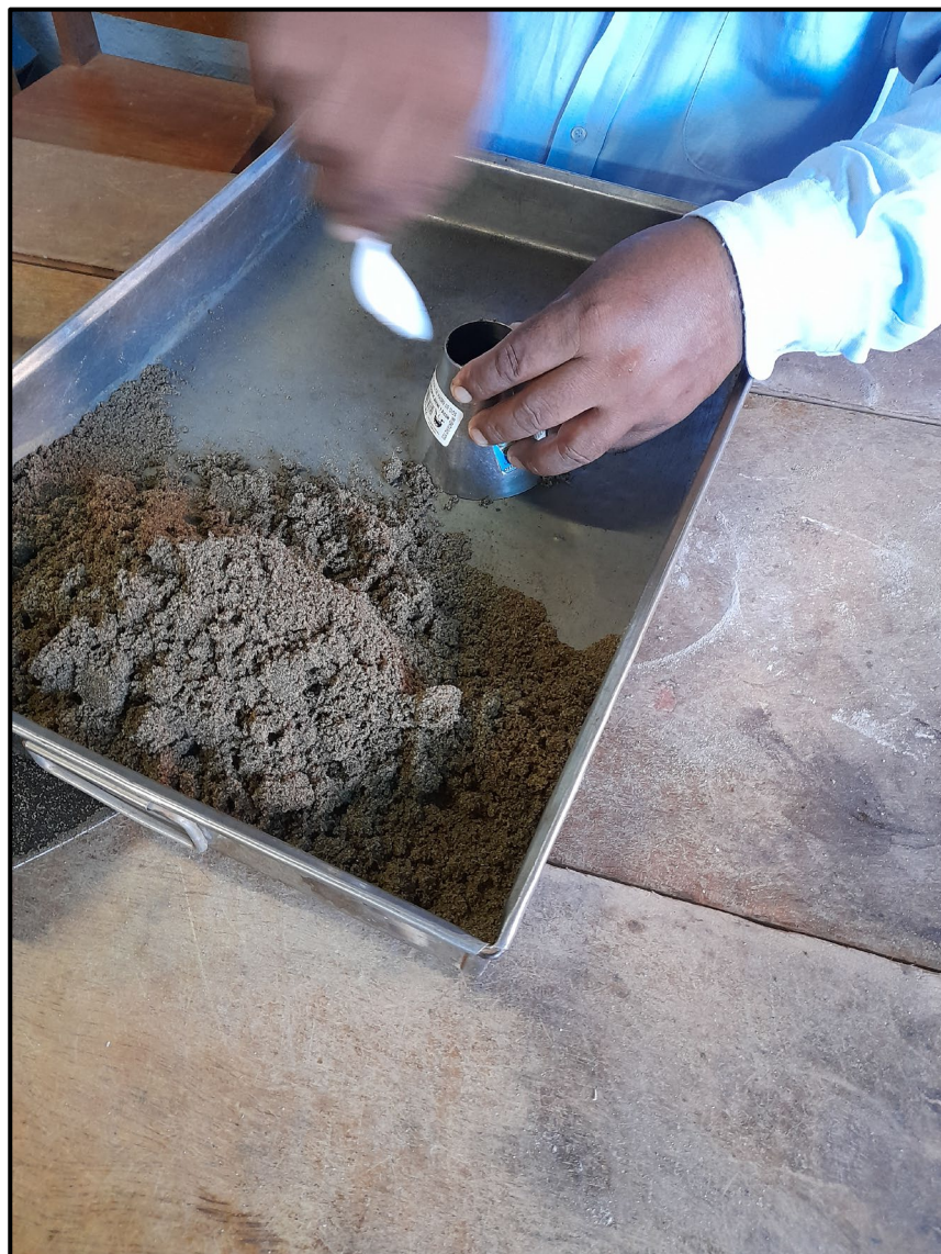
Figura 17. Cono de absorción para el agregado fino
