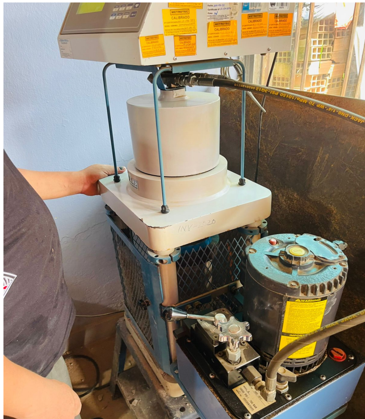
FOTO N° 13: Ensayo a compresión
