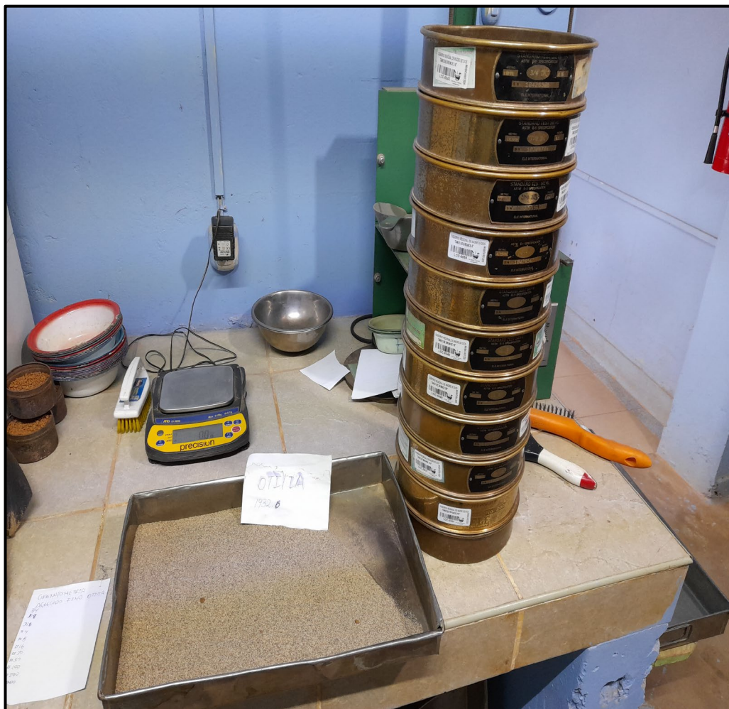
Figura 16. Tamices y muestra del agregado fino
