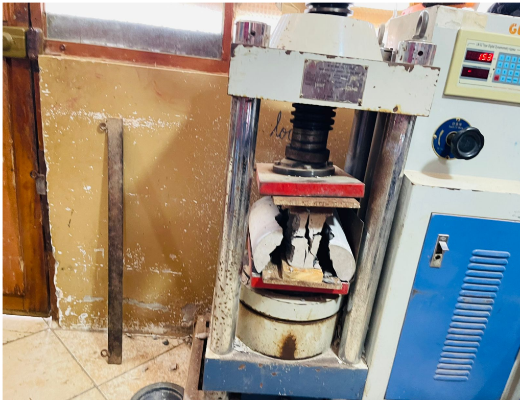
FOTO N° 15: Ensayo a tracción indirecta
