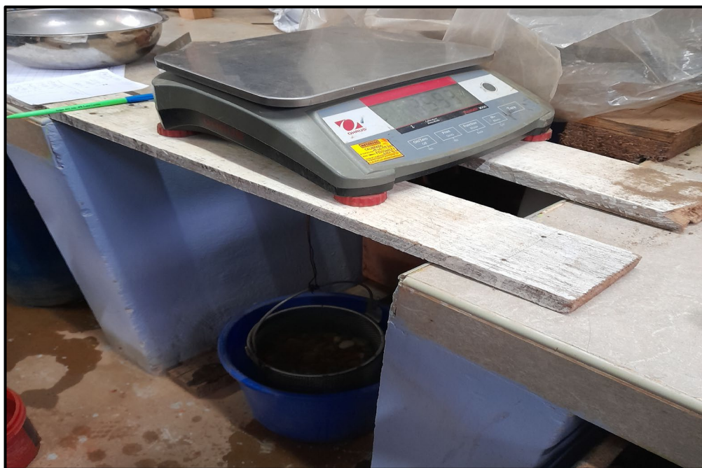
Figura 14. Ensayo del peso específico del agregado grueso
