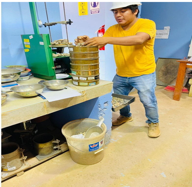
FOTO N° 05: Tamizado del agregado grueso
