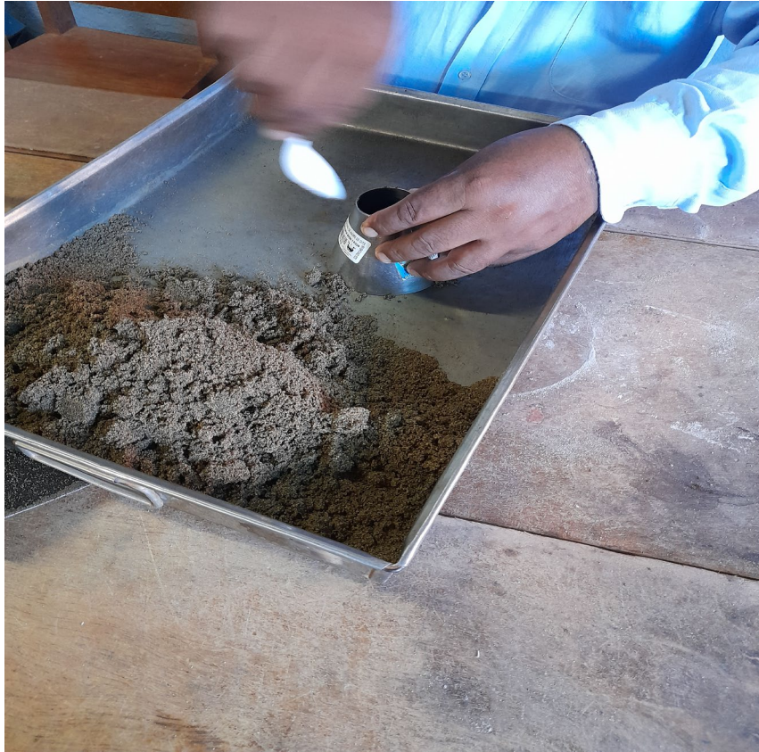
FOTO N° 08: Cono de absorción para el agregado fino
