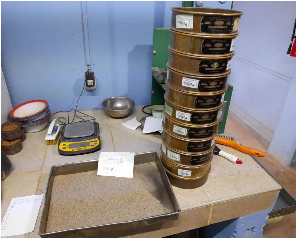
FOTO N° 06: Tamizado del agregado fino
