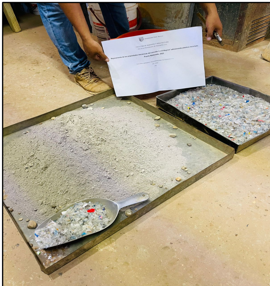
Figura 19. Incorporación del plástico triturado al concreto
