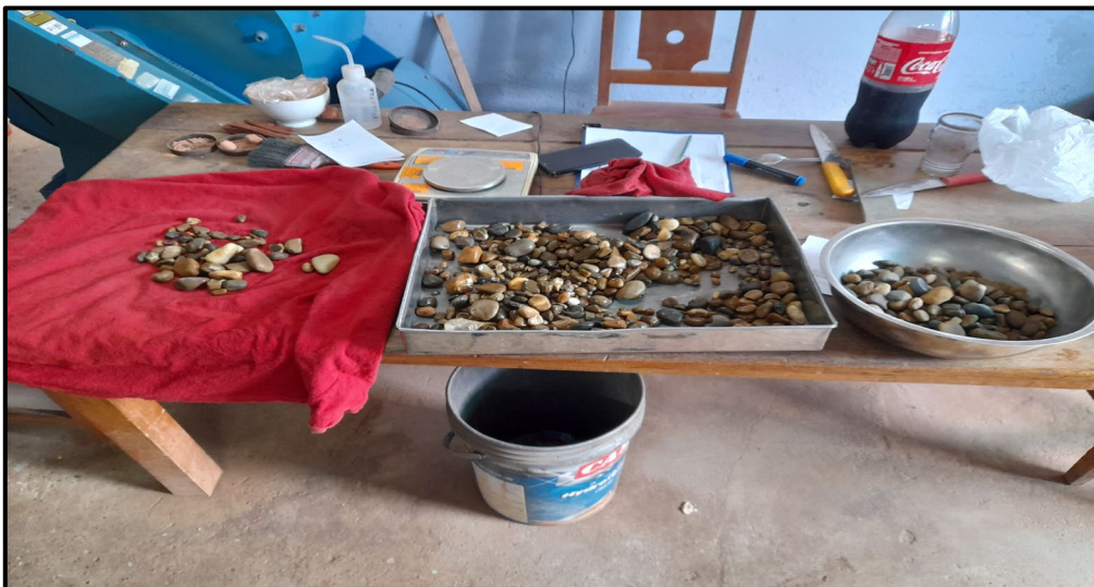
Figura 13. Muestra saturada superficialmente seca
