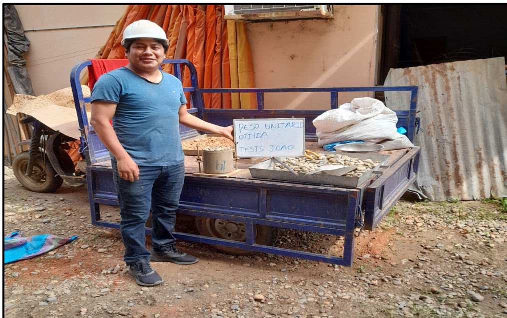
Figura 15. Ensayo de peso específico suelto y compactado
