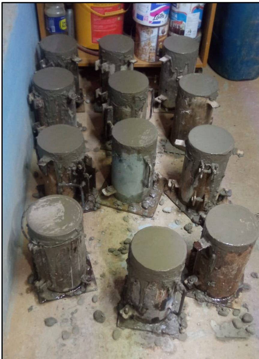
Figura 21. Briquetas con y sin incorporación de plástico triturado
