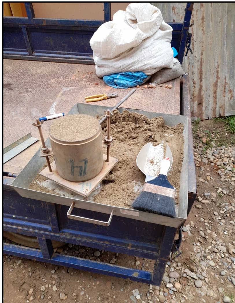
Figura 18. Ensayo de peso unitario suelto y compactado del agregado fino
