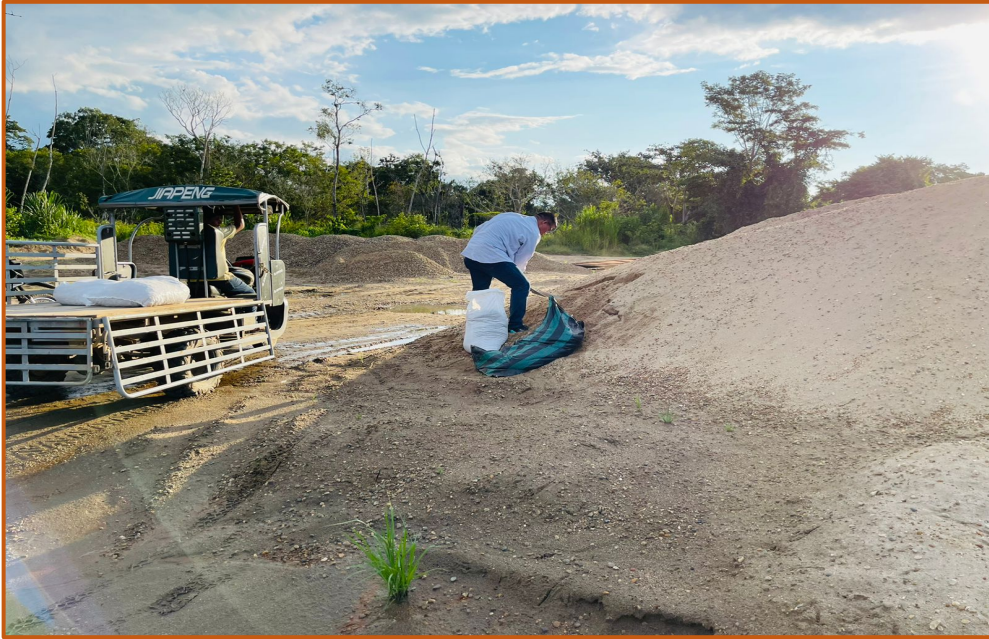
Figura 10. Extracción de agregados para ensayarlas
