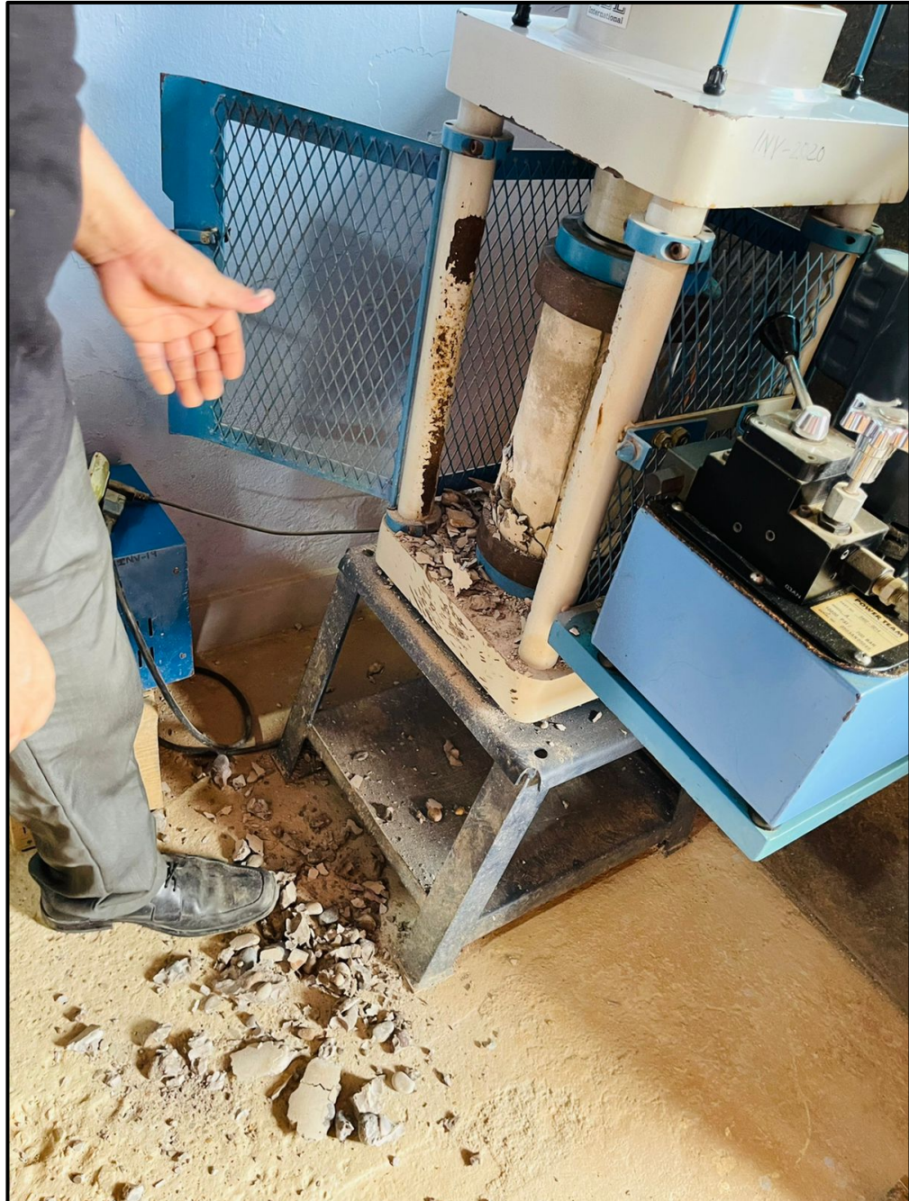
Figura 22. Ensayo a compresión
