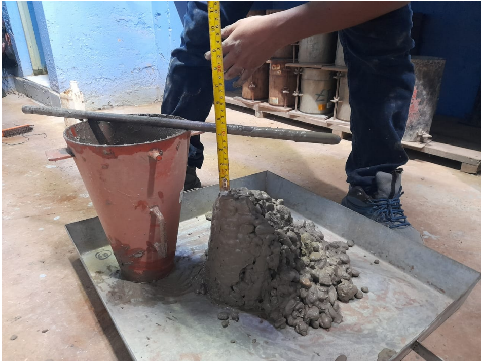
FOTO N° 10: Control del slump en el concreto
