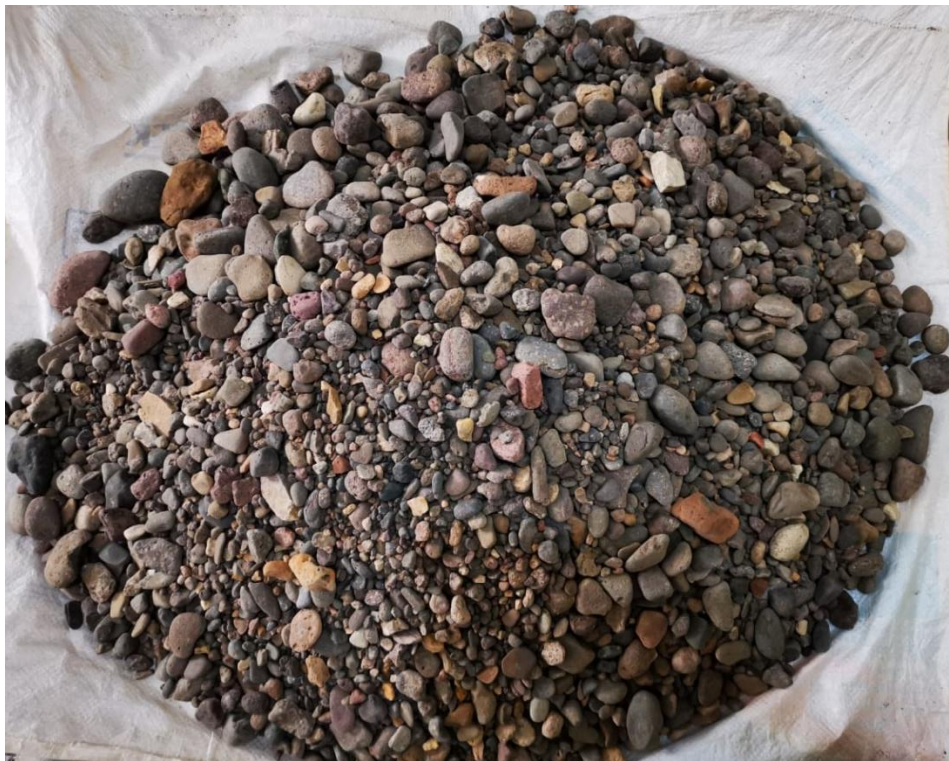
Agregado o Árido Grueso
