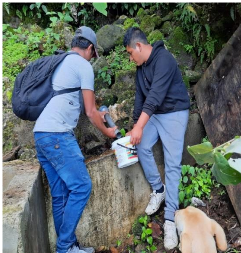
Figura 23. Calculo de Aforo de la Captación de Ladera “Cerro Chacas”
