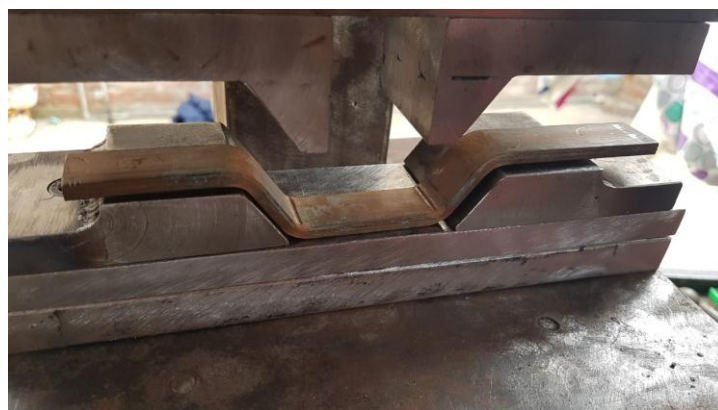
Figura 14. Dobladora de platinas de cobre. Ensayo en caja de fuerza
