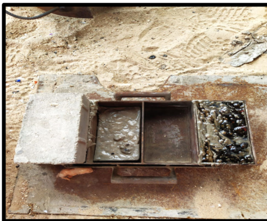
Figura 34. Vaciado de Plástico Reciclado Fundido.
