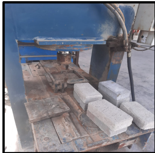
Figura 54. Prensa Hidráulica para pruebas de Rotura en COBELI S.A.C
