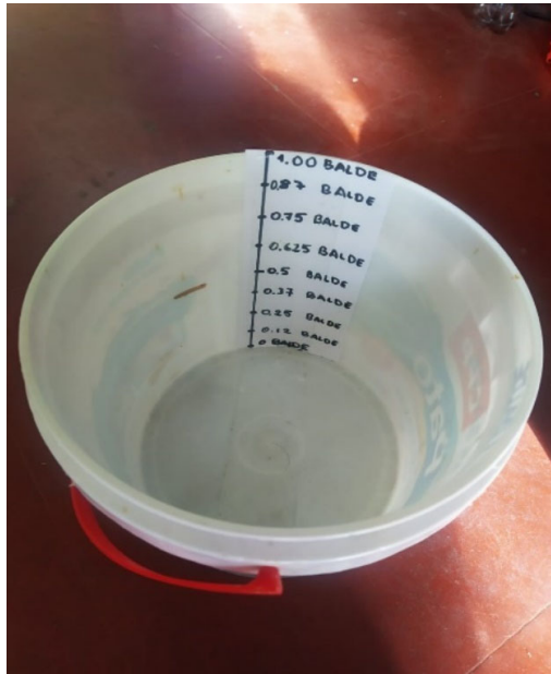
Figura 16. Balde Graduado para dosificación de Plástico, Agregados Fino y Agregados Grueso Nota. Elaboración propia
