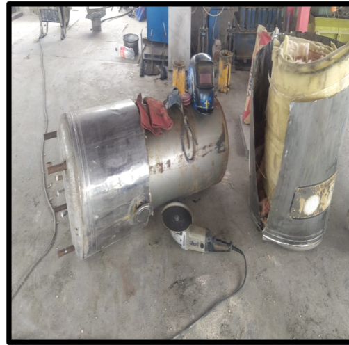
Figura 21. Fabricación de Horno.
