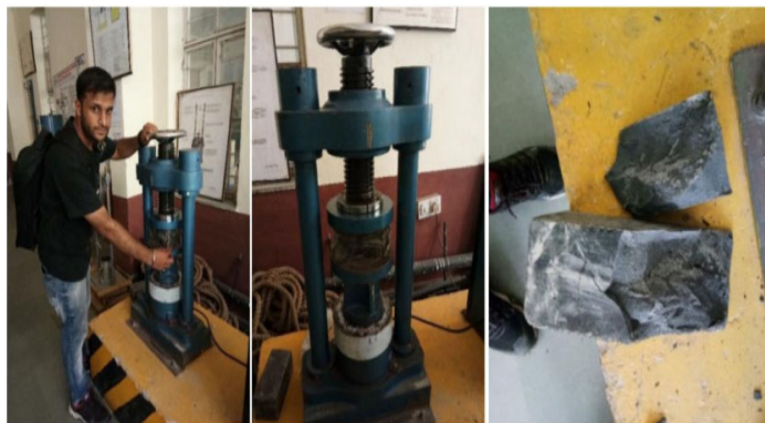
Figura 3. Ensayo de rotura de bloque de plástico reciclado NOTA: Ensayo de rotura de adoquín en prensa Singhal y Netula (2018).
