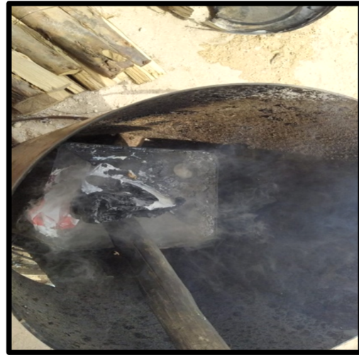
Figura 39. Mezcla de Bolsas Plásticas en el Recipiente Metálico
