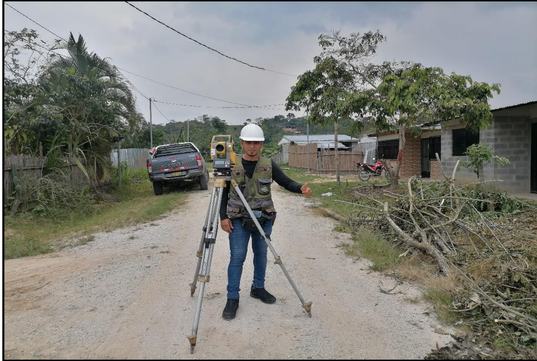
Foto N.º 01, Vista donde se aprecia al tesista responsable realizando la toma de datos en campo coordenadas (N,E,Z) referenciando Bm's y levantando estructuras existentes.
