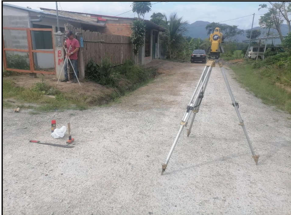
Foto N.º 01 , Vista donde se aprecia el equipo topográfico (estación total) en la realización de tomas de datos técnicos y relieve de terreno en campo (catastro)
