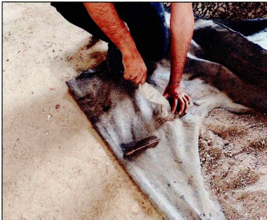
Proceso de ensayo de absorción del agregado fino – AGREGADOS, Método normalizado para peso específico y absorción del agregado grueso, NTP 400.21-2002
