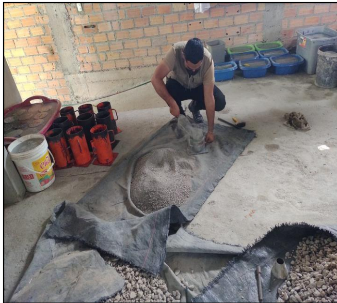
Figura 16. Ensayo de peso unitario suelto.
