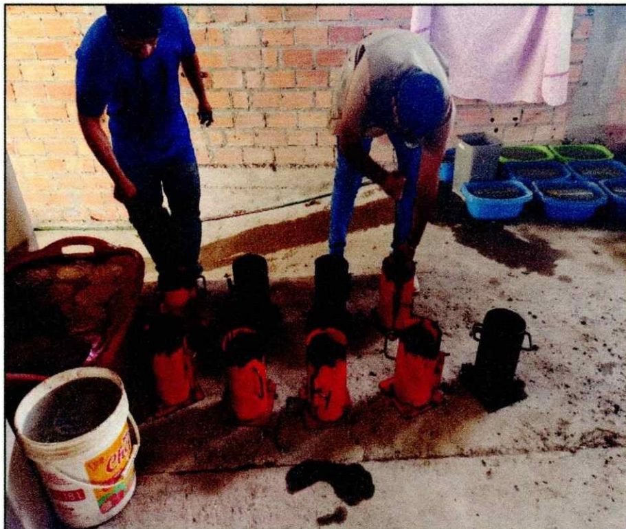
Realización de moldeo patrón de probetas de 15 x 30 cm – Hormigón concreto método de ensayo normalizado para la determinación de la resistencia a la compresión del concreto en muestras cilíndricas. NTP 339.034 - 2008
