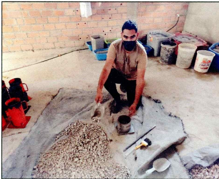
Realización de ensayo de peso volumétrico suelto y peso volumétrico compactado NTP-400.017-2011 (Agregados) Método de Ensayo Para Determinar El Peso Unitario Del Agregado.
