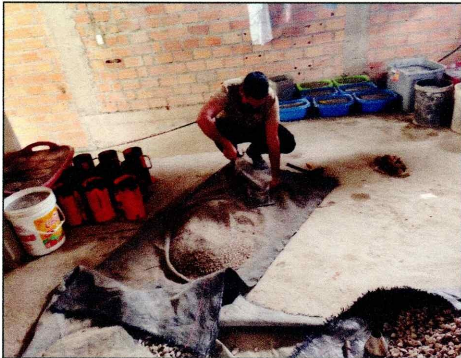
Realización de ensayo de peso volumétrico suelto y peso volumétrico compactado NTP-400.017-2011 (Agregados) Método de Ensayo Para Determinar El Peso Unitario Del Agregado.
