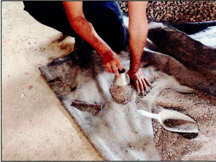
Proceso de ensayo de absorción del agregado fino – AGREGADOS, Método normalizado para peso específico y absorción del agregado grueso, NTP 400.21-2002.
