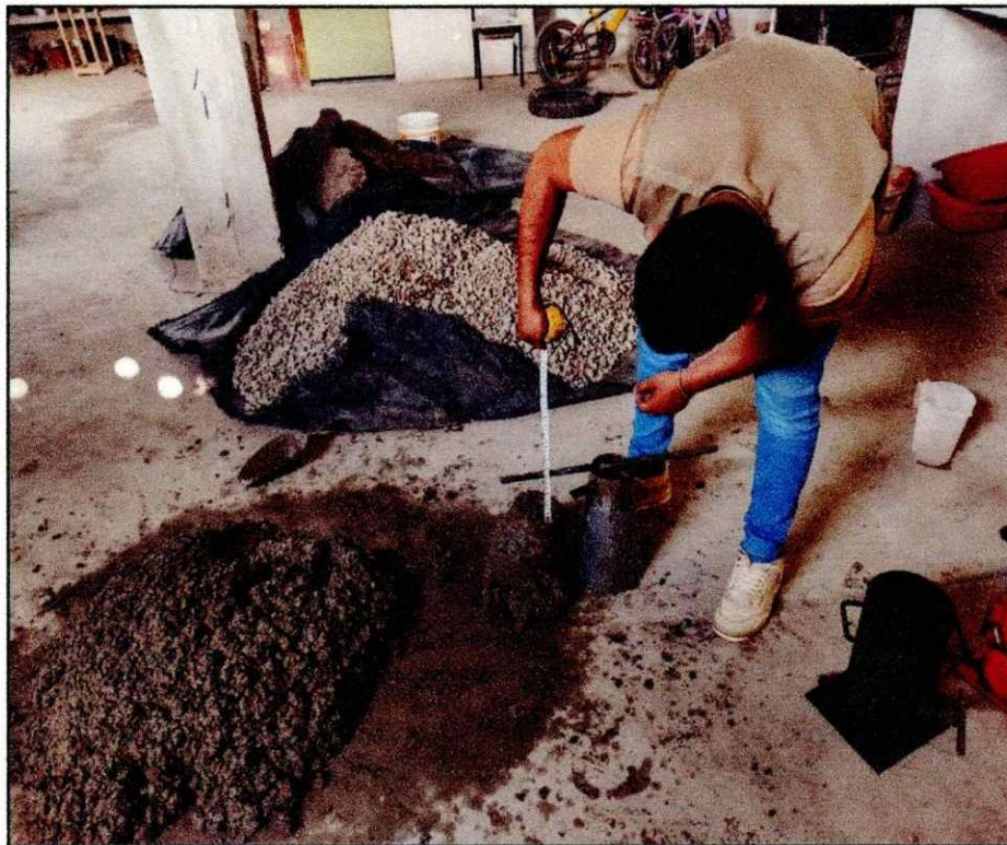
Realización de medición del ensayo de asentamiento "SLUMP" de 3" a 4" HORMIGÓN (CONCRETO). Método de ensayo para la medición del asentamiento del concreto de cemento Portland - NTP 339.035 – 2009.
