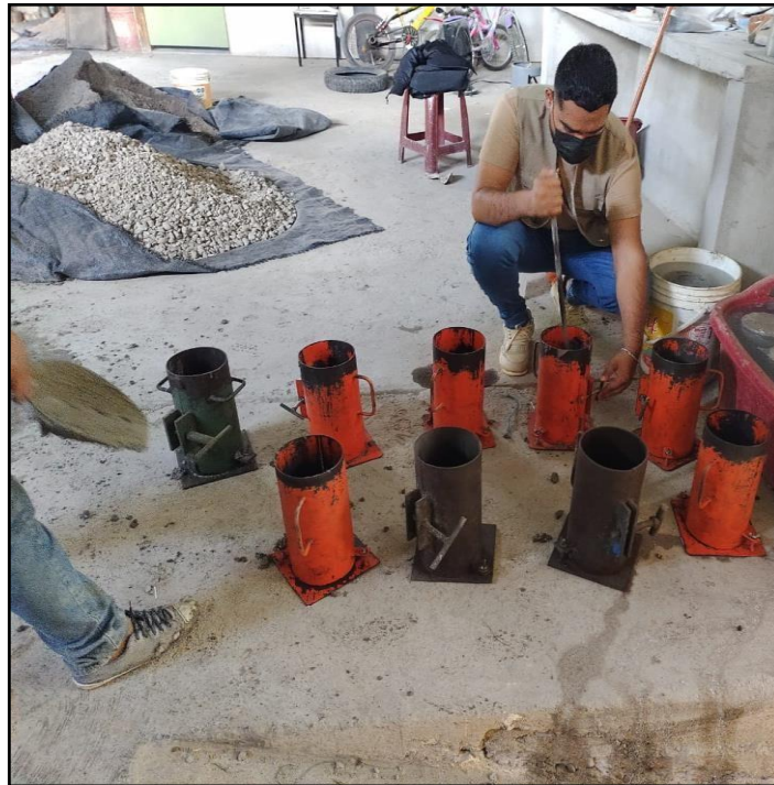
Figura 22. Elaboración de probetas de concreto
