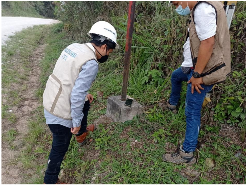
Figura 1. Sacando coordenadas de los BM.
