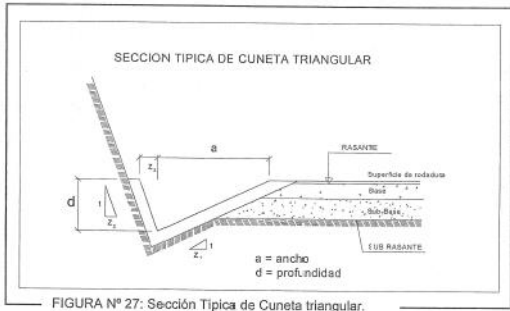
FIGURA N° 27: Sección Típica de Cuneta triangular.
