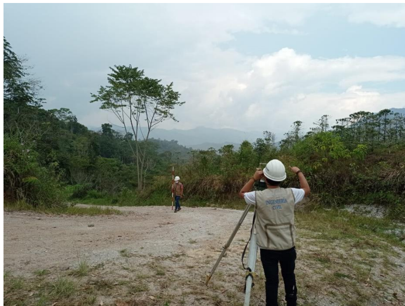
Figura 2. Proceso de levantamiento topográfico.
