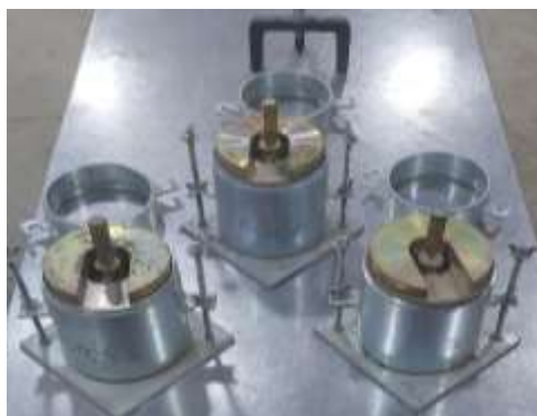
Figura 28. Equipo usado en el ensayo de CBR
