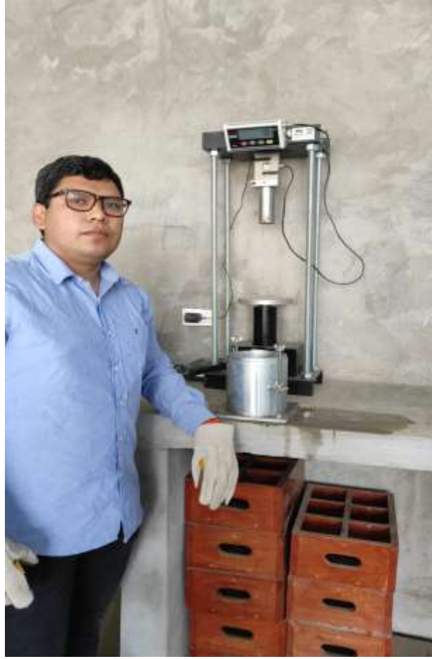
Realización del ensayo de carga – penetración en la prensa
