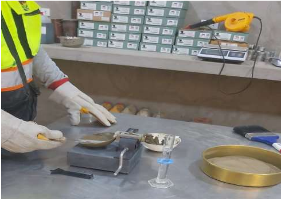
Colocación de muestra en la cuchara Casagrande
