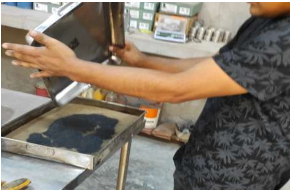
Incorporación de la ceniza de cáscara de arroz a la muestra natural
