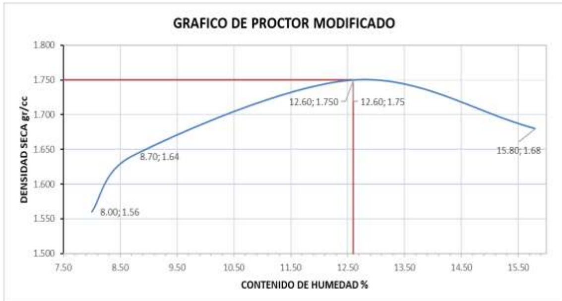
Figura 58. Curva óptimo contenido de humedad - máxima densidad seca de material natural
