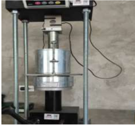
Figura 30. Colocación de la sobrecarga en cada uno de los moldes
