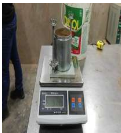
Figura 26. Peso del molde con muestra compactada
