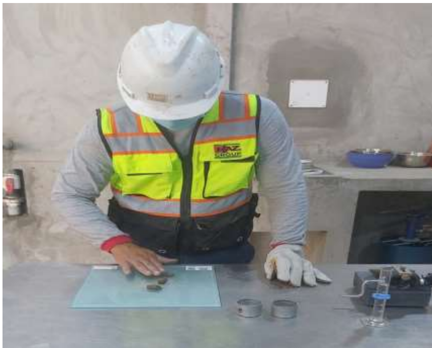
Amasando la muestra en el esmerilado de vidrio para el ensayo plástico
