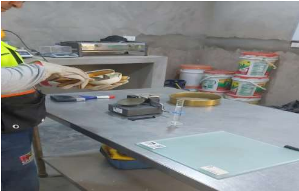
Preparación de la muestra para poder realizar los ensayos de limite liquido
