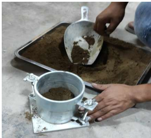
Figura 24. Primera capa puesta en el molde de ensayo de Proctor
