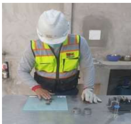
Figura 21. Ensayo de Limite Plástico con adición de 7% CCA
