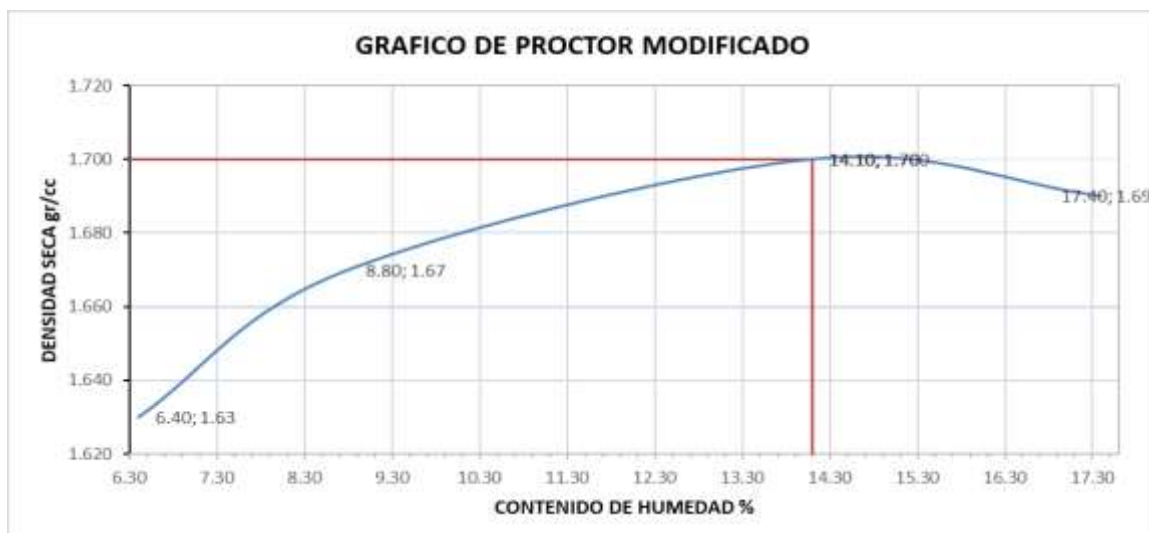
Figura 59. Curva óptimo contenido de humedad - máxima densidad seca de material natural + adición de 4% de cáscara de arroz
