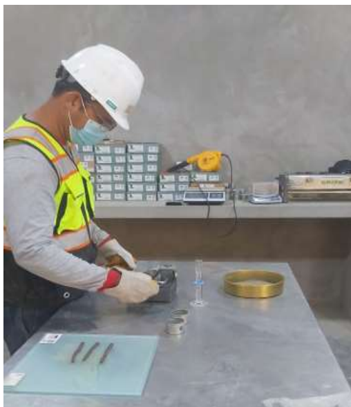
Figura 22. Ensayo de Limite Plástico con adición de 7% CCA
