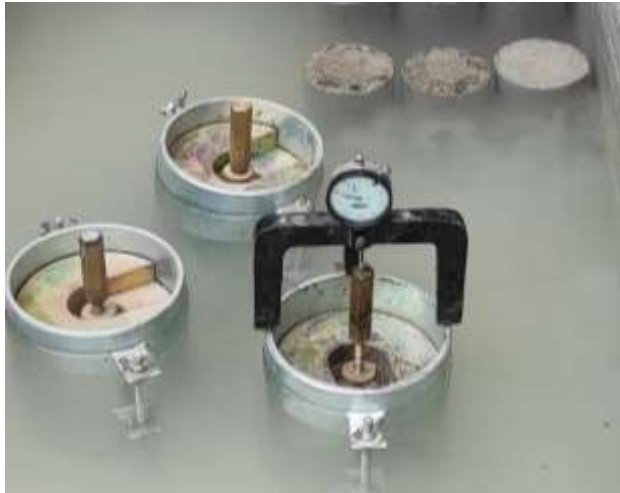
Figura 29. Colocación de los moldes en la Piscina
