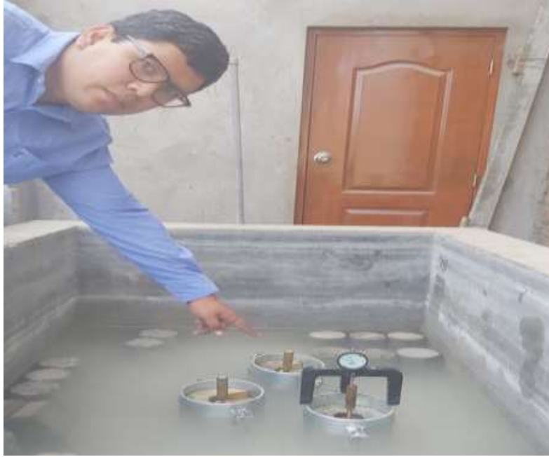
Moldes con mezcla de 7% de CCA sumergidos en la piscina de agua
