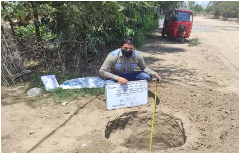
Extracción de muestra profundidad de 1.50m- calicata N° 01
