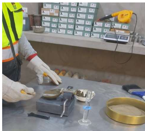
Figura 19. Ensayo de Límite Líquido con adición de 7% CCA
