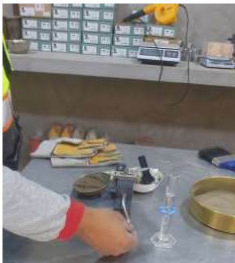
Figura 20. Ensayo de Limite Liquido con adición de 7% CCA
