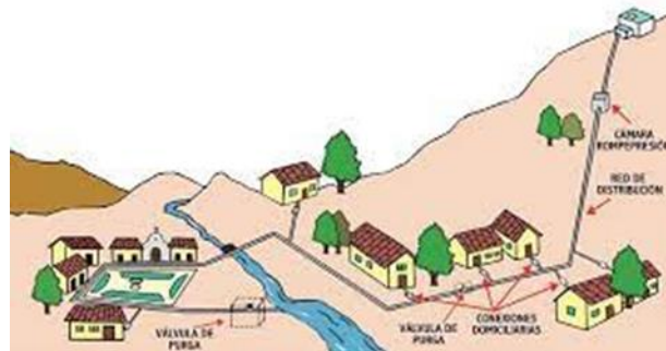
Figura 4. Sistema de abastecimiento de agua potable
