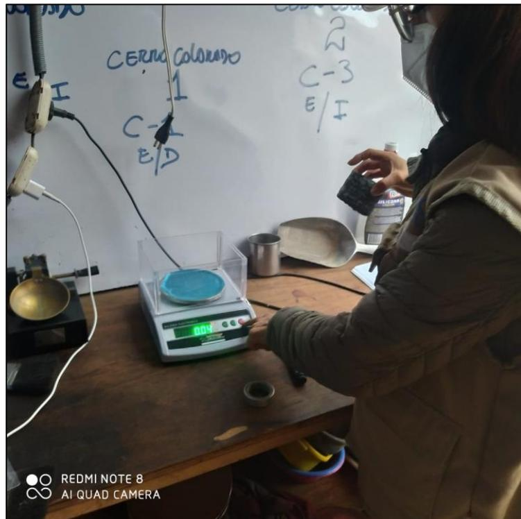
Foto N°12: Pesado de las muestras obtenidas por el ensayo de diamantina
