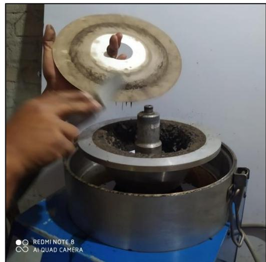
Foto N°19: Ensayo lavado asfáltico N°4-Muestra N°4
