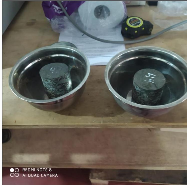
Foto N°11: Separación de las muestras obtenidas por el ensayo de diamantina
