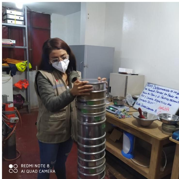
Foto N°21: Análisis granulométrico de las muestras obtenidas por el secado del horno
