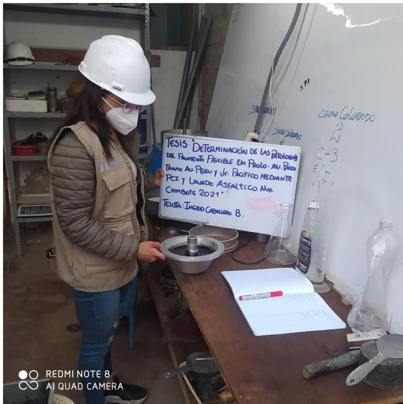
Foto N°14: Aplicación del ensayo lavado asfáltico
