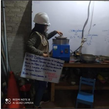
Foto N°17: Ensayo lavado asfáltico N°3-Muestra N°3
