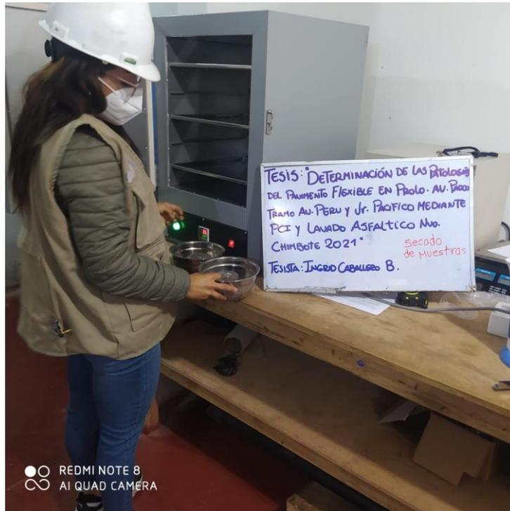
Foto N°20: Secado de las muestras obtenidas por el ensayo de lavado asfáltico
