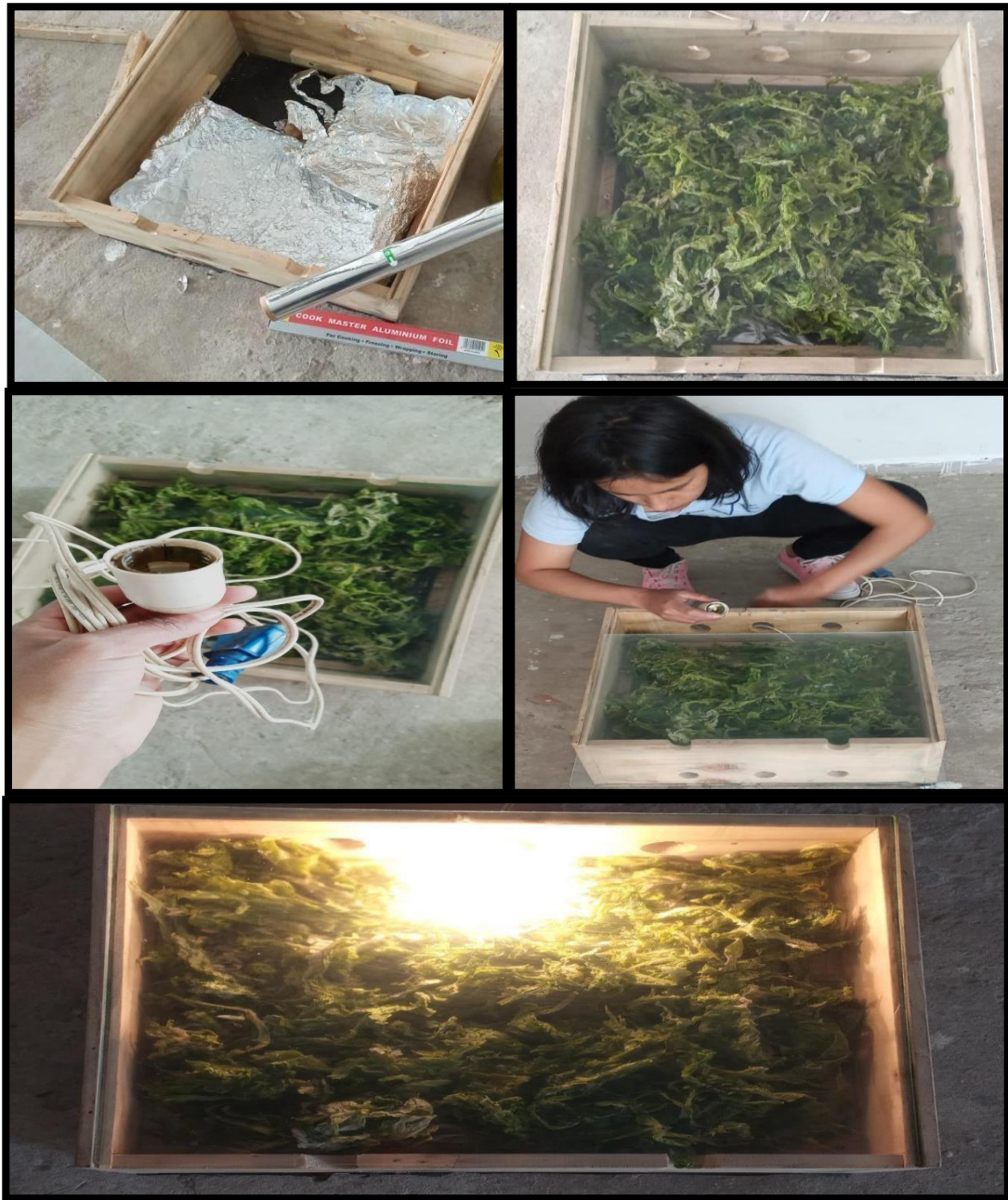
Figura 14. Colocación de papel aluminio y el sócate con el foco al deshidratador
