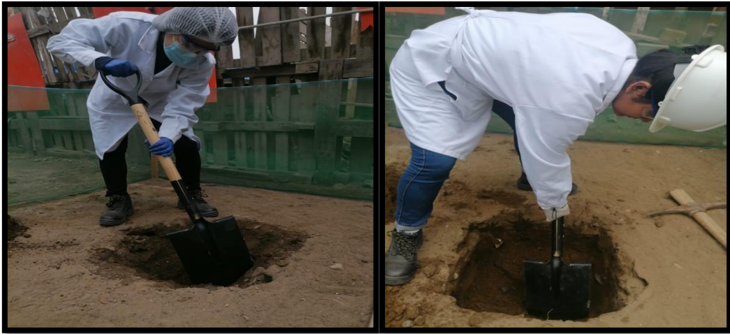
Figura 25. Procedimiento de la calicata
