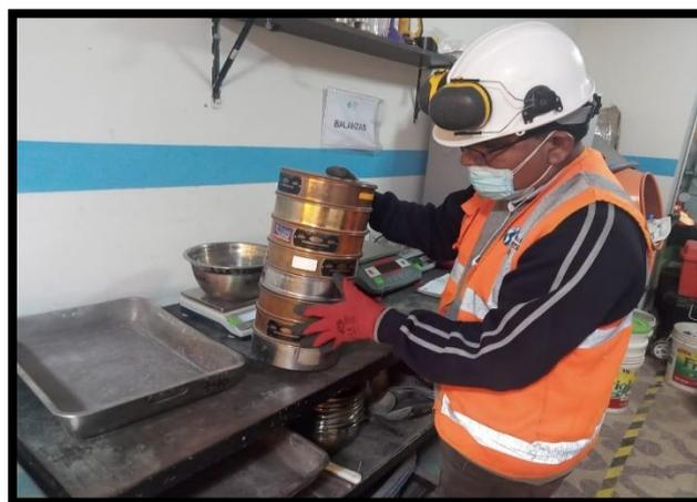
*Figura 7.* Tamizado de agregado grueso
