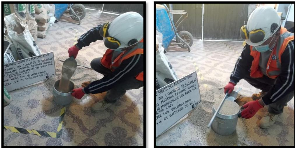
Figura 5. Llenado y enrasado de agregado fino
