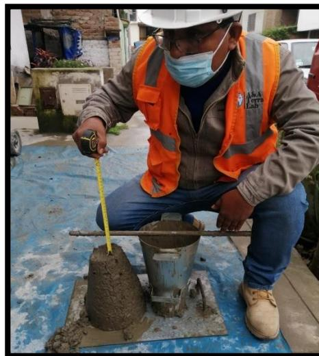
*Figura 13.* Ensayo de consistencia (Slump) 2.5% materiales reciclados de alambre N°8.
