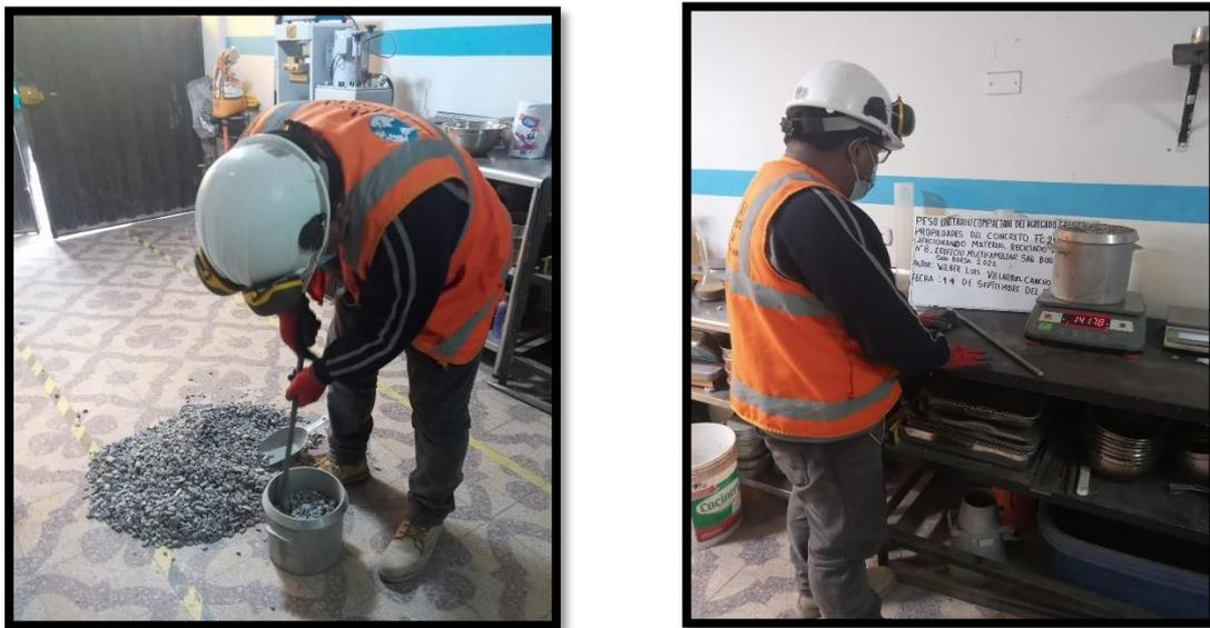
*Figura 8. Ensayo unitario agregado grueso*
