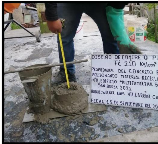
Figura 10. Ensayo de Consistencia (Slump)
