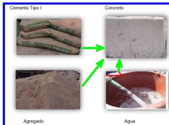
Figura 1. Materiales que dan efecto el concreto
