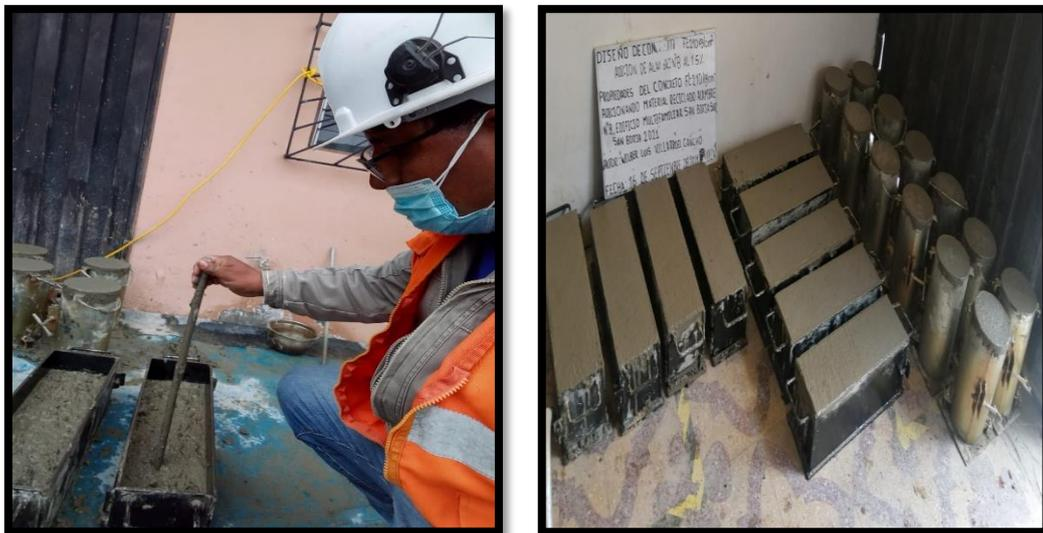
*Figura 15. Elaboración de probetas*
