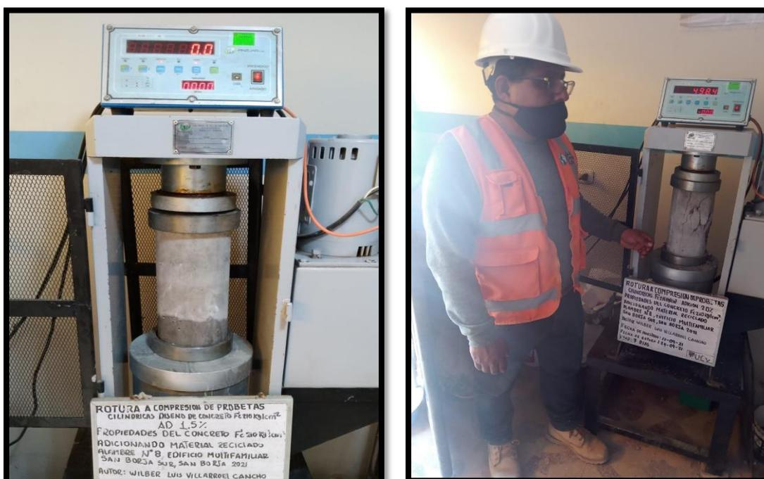
Figura 17. Ensayo de resistencia a compresión
