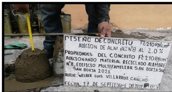
Figura 12. Ensayo de consistencia (Slump) 2% materiales reciclados de alambre N°8.
