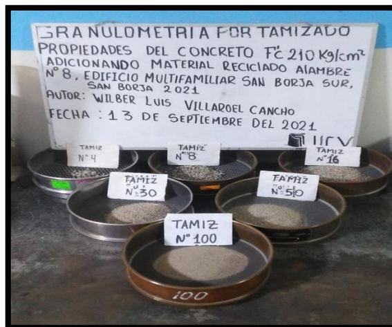
Figura 4. Granulometría agregado fino
