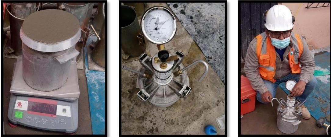
Figura 14. Ensayo de contenido de aire
