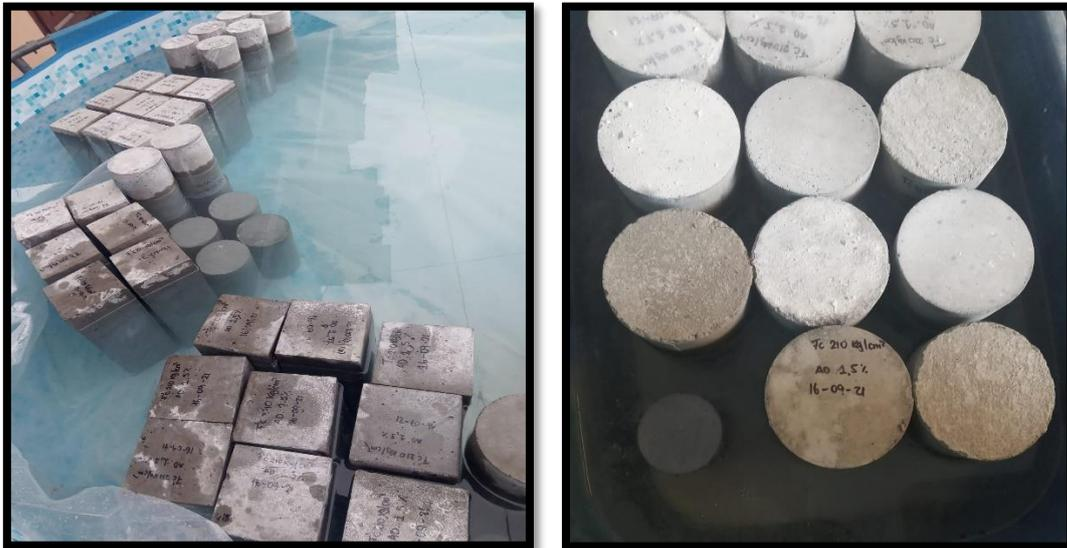
Figura 16. Curado de probetas
