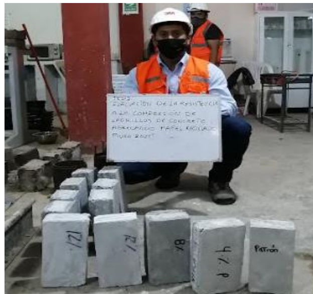
Figura 16: Ladrillos de concreto con adición de 4%, 8% y 12% de papel reciclado en 28 días
