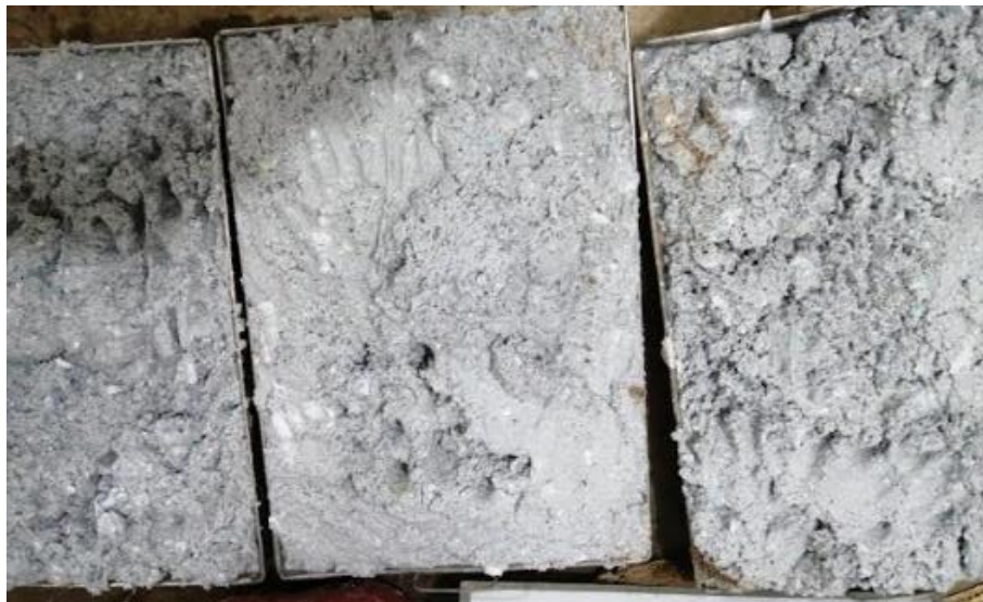
Figura 12: Mezcla del concreto con adición de papel reciclado colocado en bandeja
