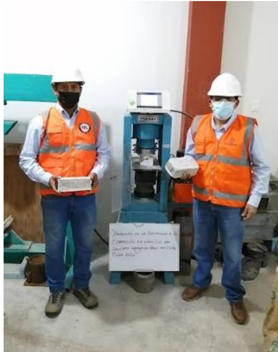
Figura 17: Ensayo de compresión de ladrillos de concreto con adición de 4%, 8% y 12% de papel reciclado en 28 días
