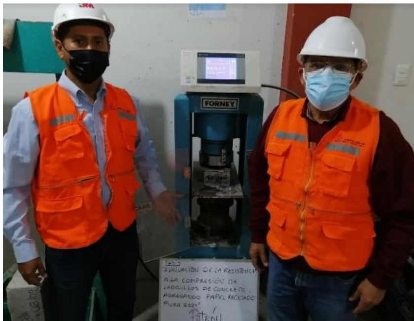
Figura 18: Ensayo de compresión de ladrillos de concreto con adición de 4%, 8% y 12% de papel reciclado en 28 días
