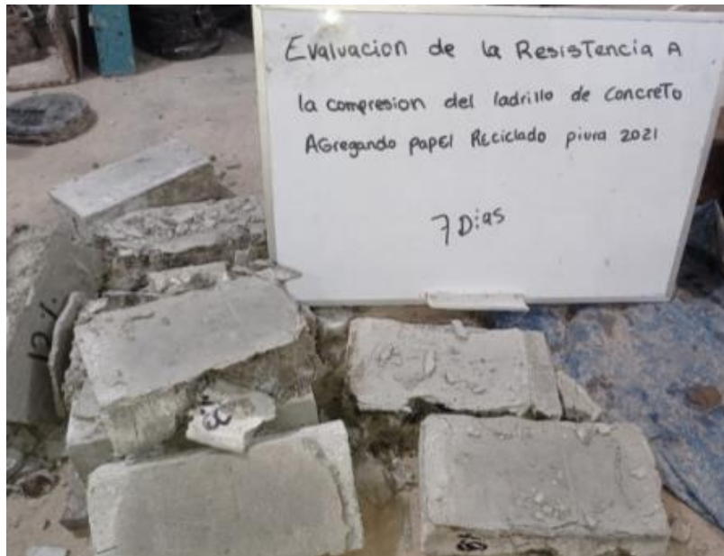
Figura 23: Rotura de ladrillos de concreto con adición de 8% de papel reciclado en 28 días
