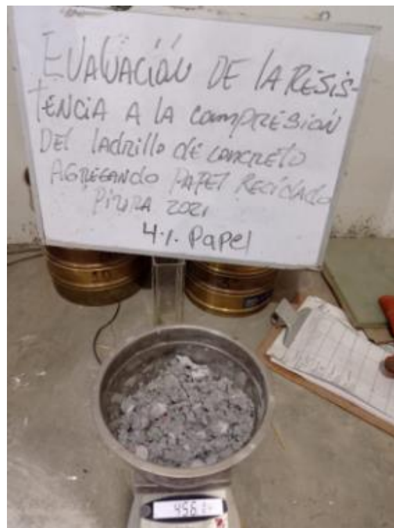
Figura 6: Peso de papel reciclado de impresiones que será ingresado a la mezcla de concreto
