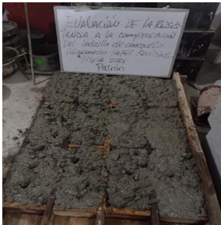
Figura 13: Mezcla del concreto de control en moldes para ladrillos
