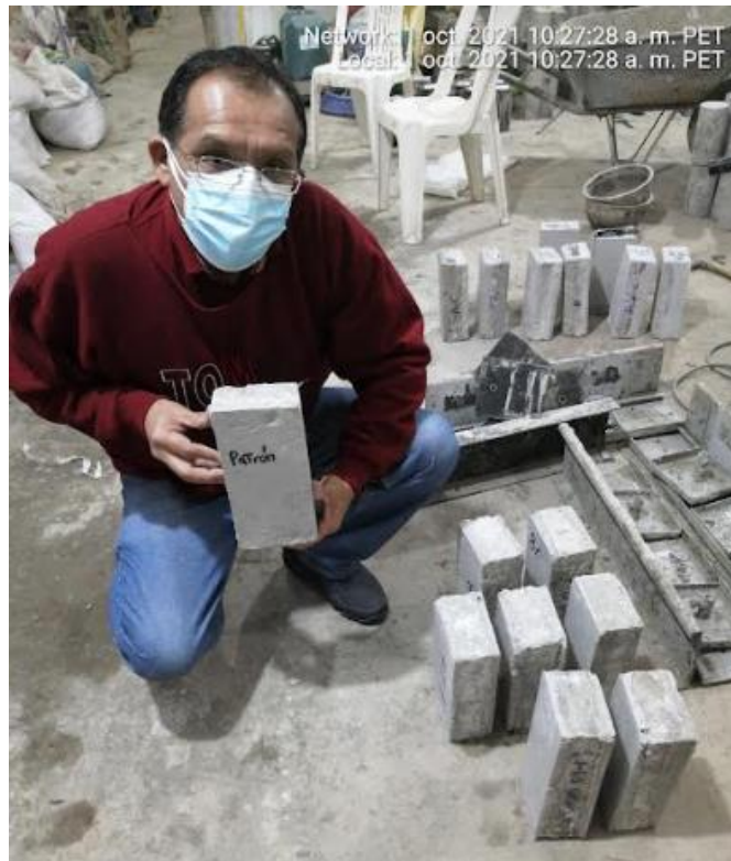
Figura 15: Ladrillos de concreto de control con edad de 28 días
