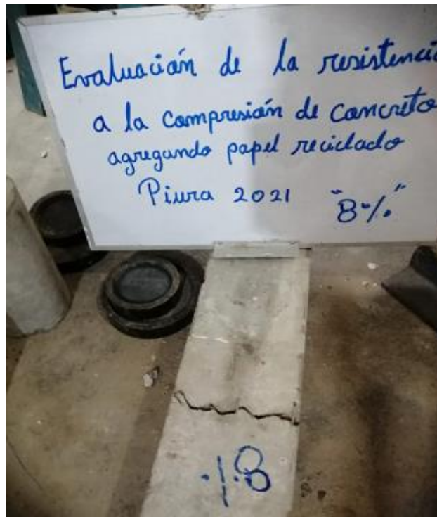
Figura 22: Rotura de vigas de concreto con adición de 8% de papel reciclado en 28 días
