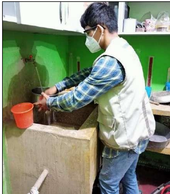
Figura 39. Lavado de muestras por la malla N° 200, 29-06-2021.
