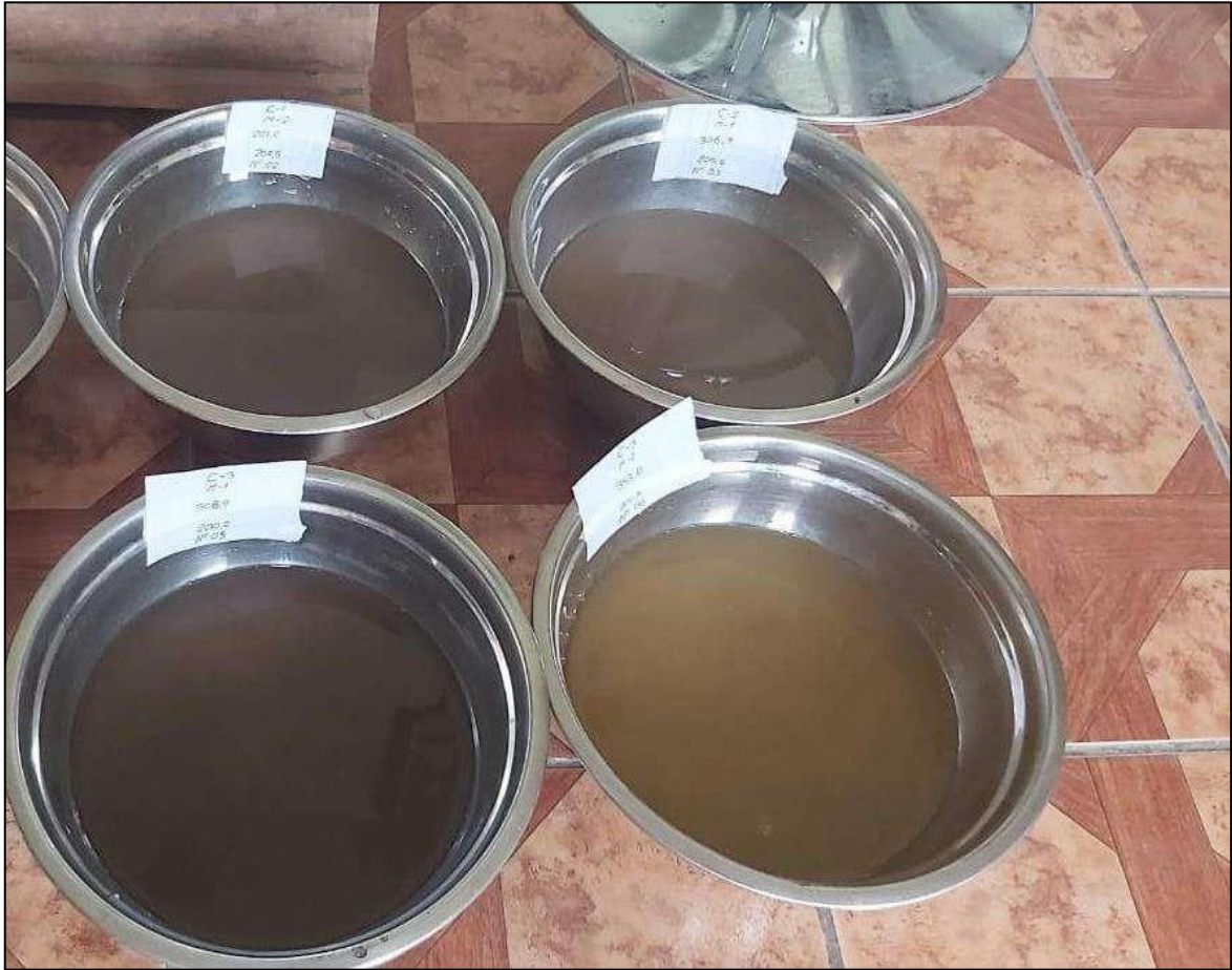
Figura 38. Saturación de muestras para lavarlas por la malla N° 200, 29-06-2021.
