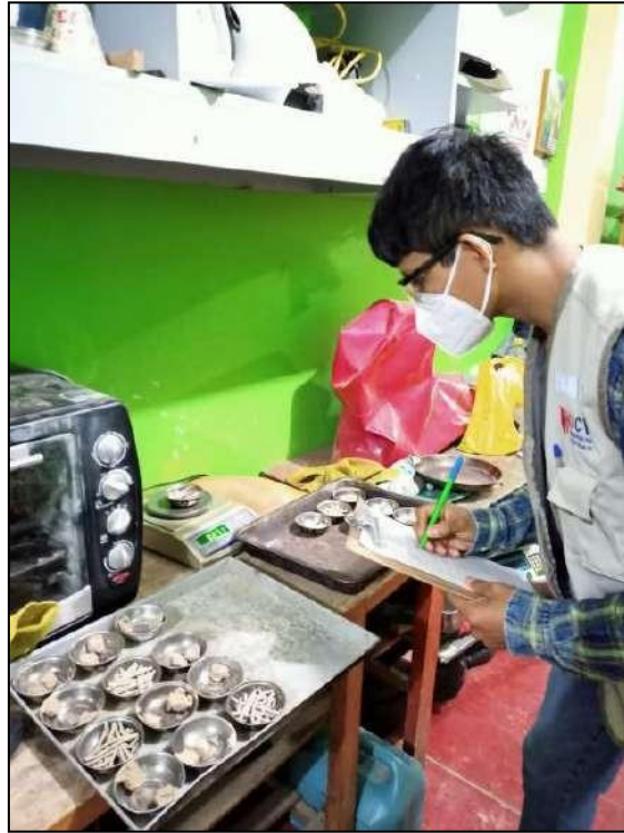
Figura 42. Peso de muestras secas: Límite Líquido y Límite Plástico, 29-06-2021.
