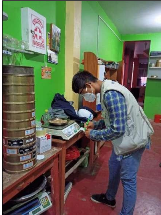
Figura 36. Pesado de muestras para calcular el contenido de humedad, 27-06-2021.
