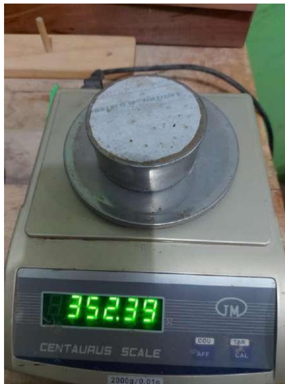
Figura 43. Peso de muestra en anillo de corte, 29-06-2021.
