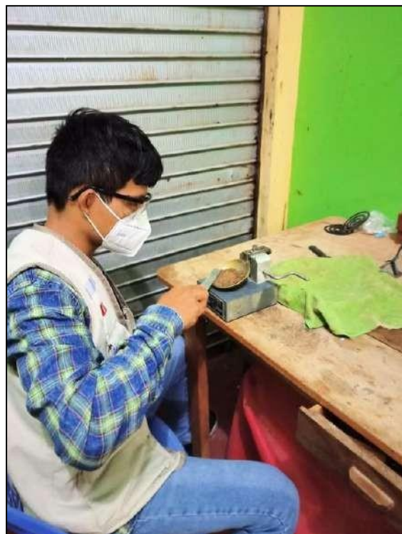
Figura 41. Ensayos para Límites de Consistencia: Límite Líquido y Límite Plástico, 29-06-2021.
