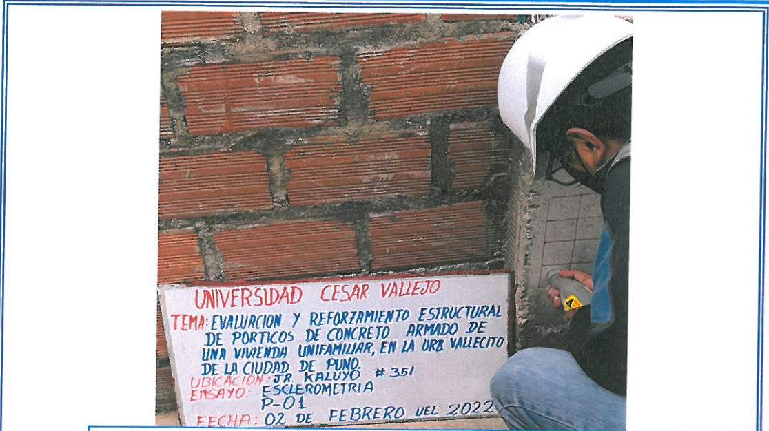
VISTA 03: REALIZANDO EL ENSAYO DE ESCLEROMETRIA PUNTO-01, PROYECTO UNIFAMILIAR URB. VALLECITO – PUNO.
