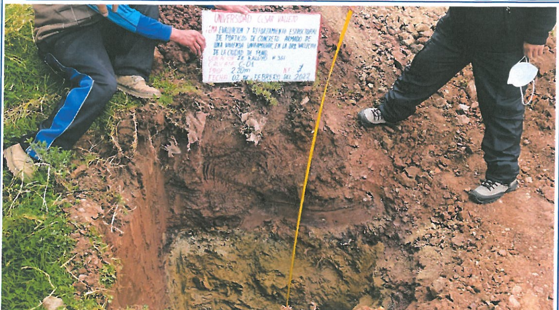
VISTA 05: REGISTRO DE ESTRATOS DE LA C-01, PROYECTO UNIFAMILIAR URB. VALLECITO – PUNO.
