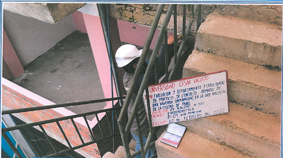
VISTA 13: REALIZANDO EL ENSAYO DE ESCLEROMETRIA PUNTO-04, PROYECTO UNIFAMILIAR URB. VALLECITO – PUNO.
