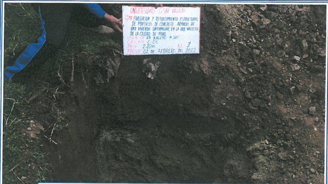
VISTA 03: PERFIL ESTRATIGRAFICO DE LA CALICATA-01, PROYECTO UNIFAMILIAR URB. VALLECITO – PUNO.
