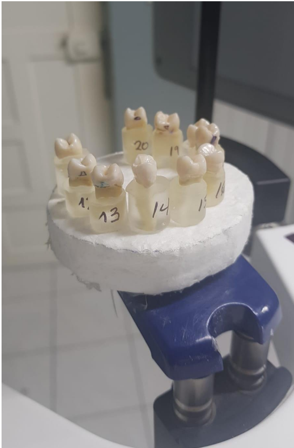
Foto 8 Colocación de 10 maquetas individualizadas en la mentonera para la toma de tomografía de haz cónico (tomografía 2).
