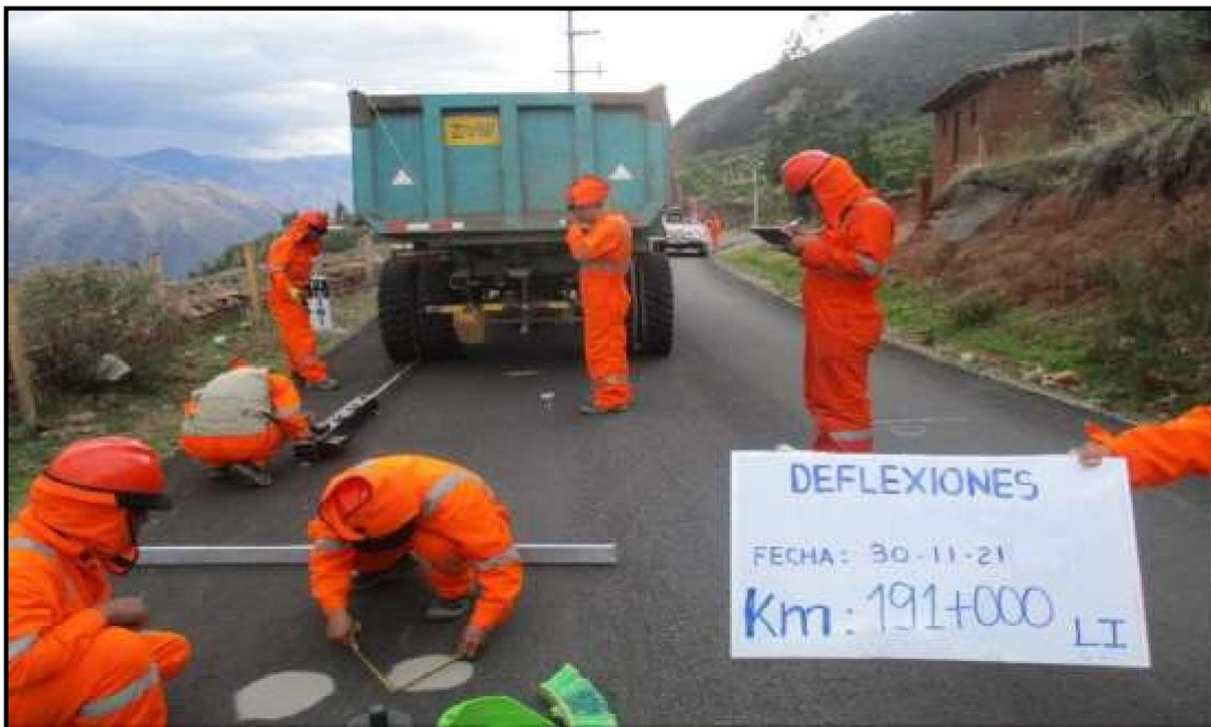
Foto 2. Medición de deflexiones en el tramo San Fransisco – Palmapampa. (lado izquierdo)
