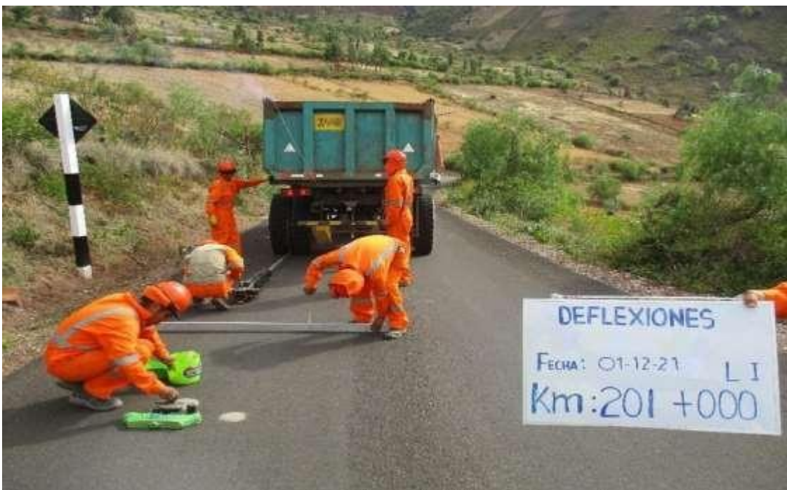
Foto 4. Medición de deflexiones en el tramo Chiquintirca – San Miguel. (lado izquierdo)
