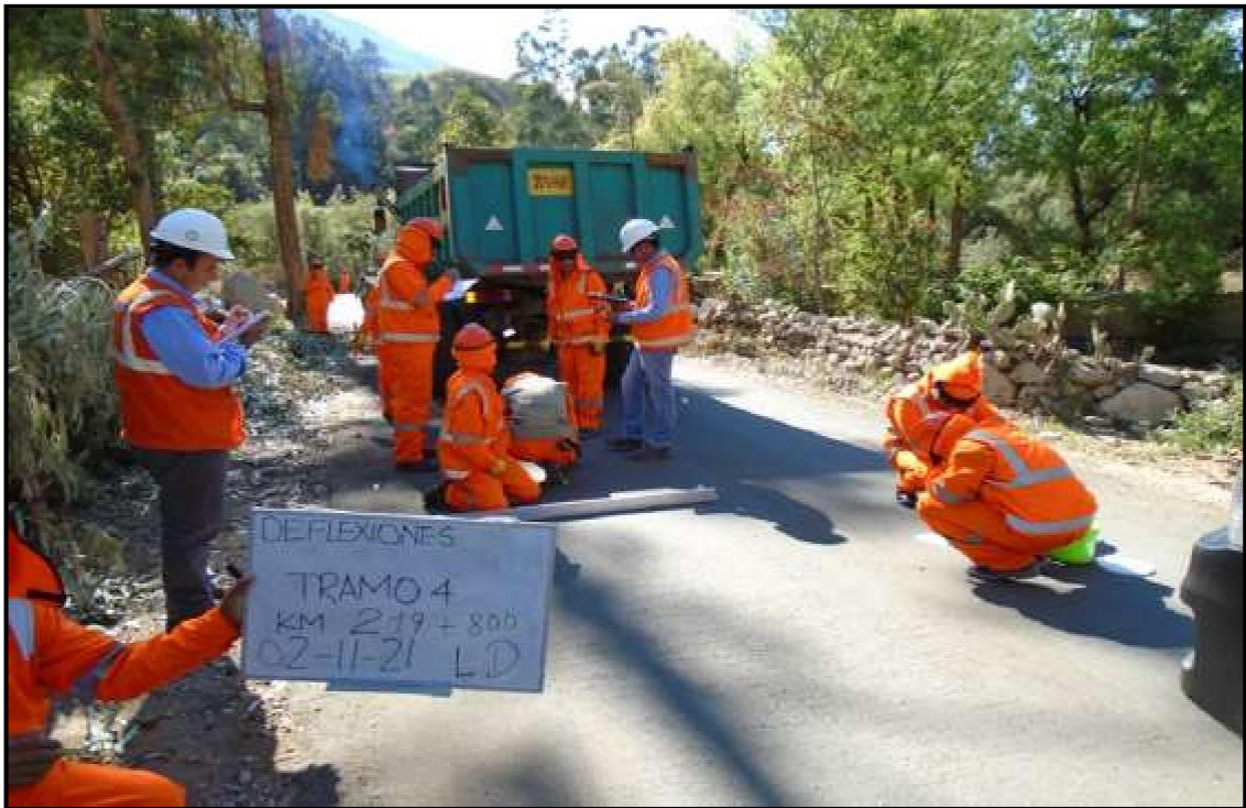
Foto 5. Medición de deflexiones en el tramo Chiquintirca – San Miguel. (lado derecho)
