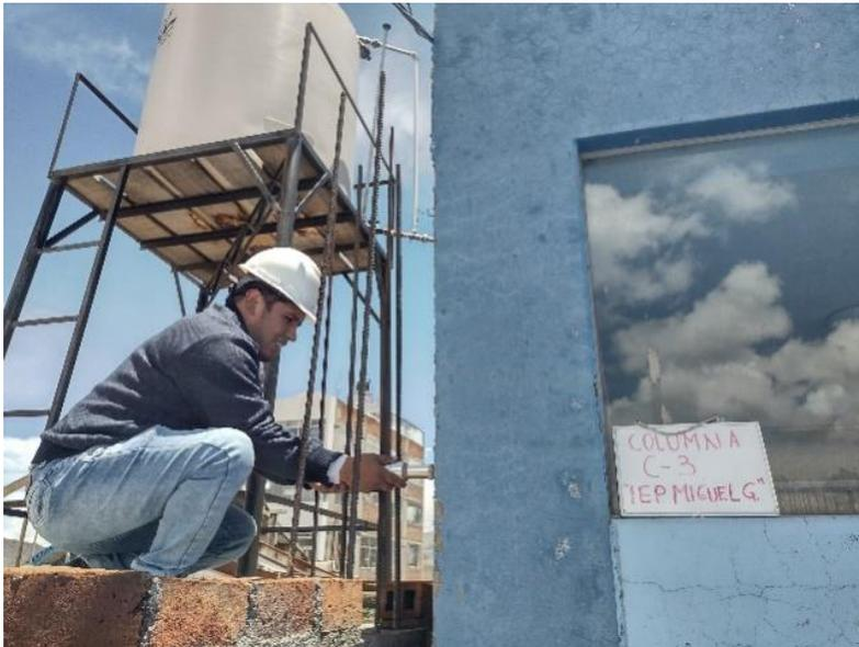
Figura 4.12. Figura Ensayo de esclerometría en columnas
