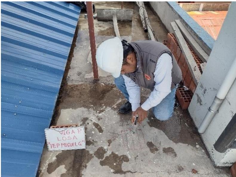
Figura 4.13. Ensayo de esclerometría en viga losa
