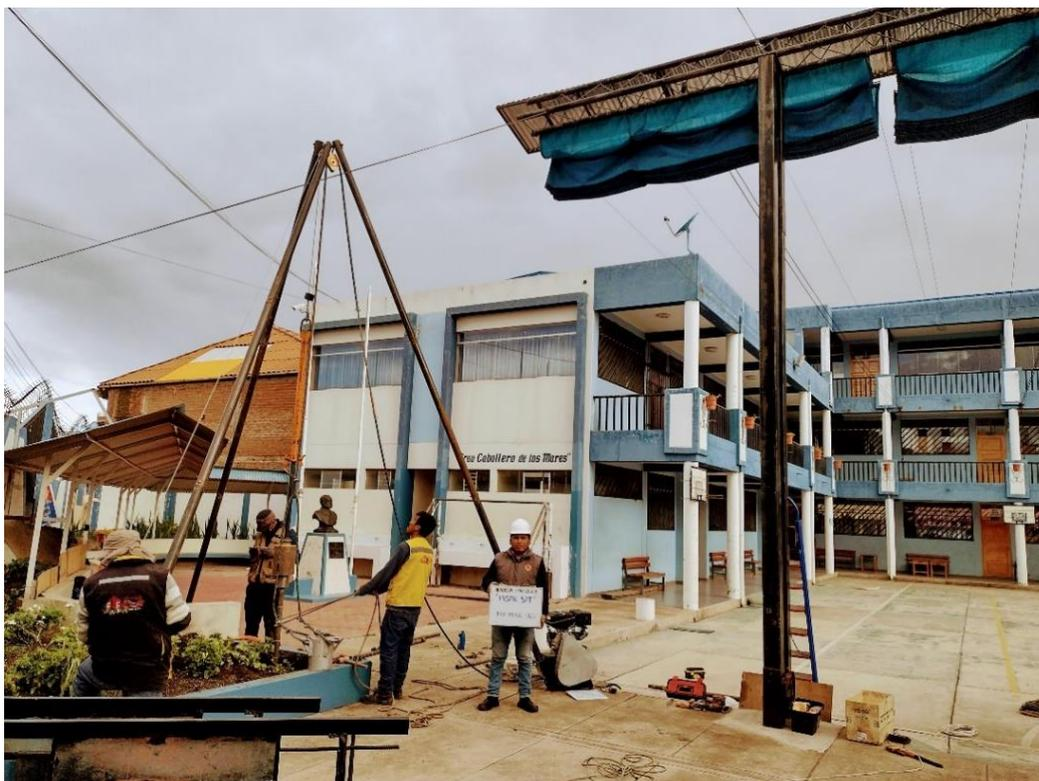
Figura 4.18. Ensayo SPT
