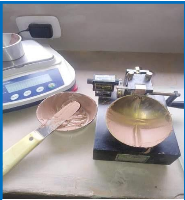
Figura 60: Imagen de realización del límite plástico en laboratorio.
