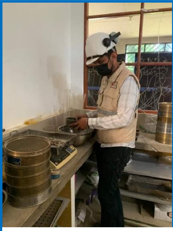
Figura 50: Imagen de realización del granulometría en laboratorio.
