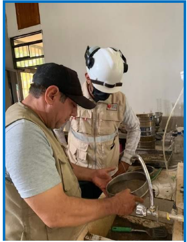
Figura 55: Imagen de realización del granulometría en laboratorio.
