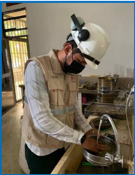
Figura 52: Imagen de realización del granulometría en laboratorio.
