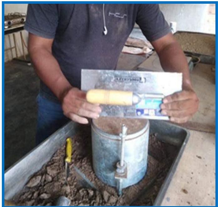
Figura 61: Imagen de realización del proctor en laboratorio.
