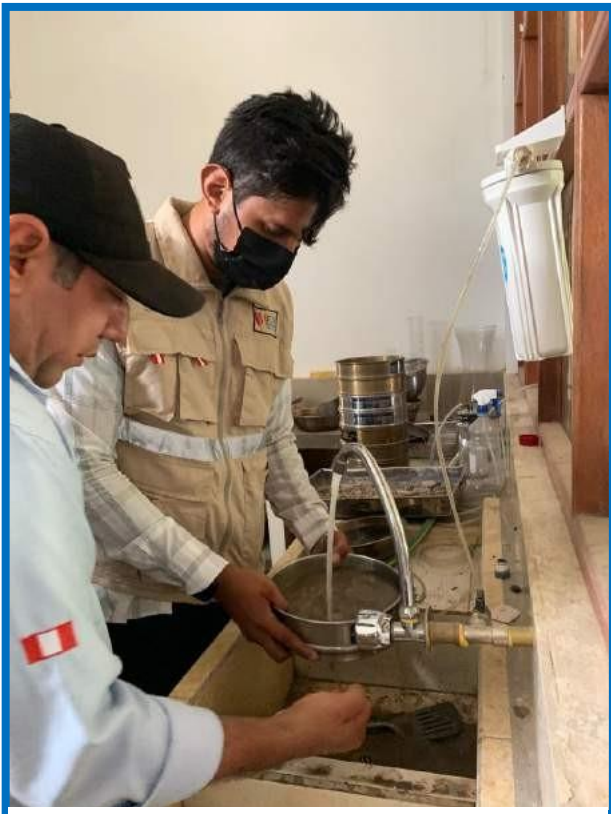
Figura 58: Imagen de realización del granulometría en laboratorio.
