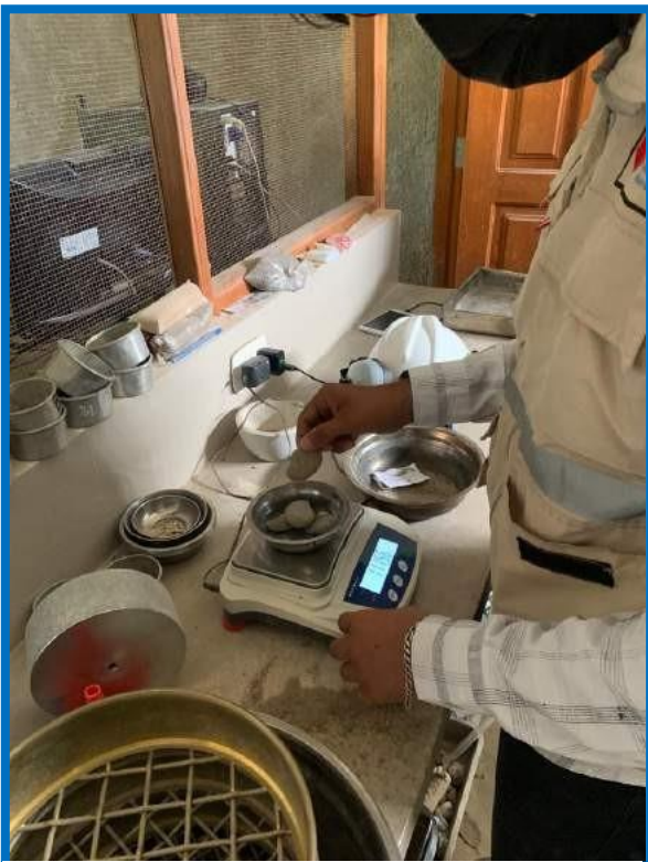
Figura 56: Imagen de realización del granulometría en laboratorio.
