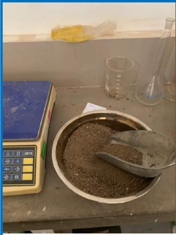
Figura 54: Imagen de realización del granulometría en laboratorio.
