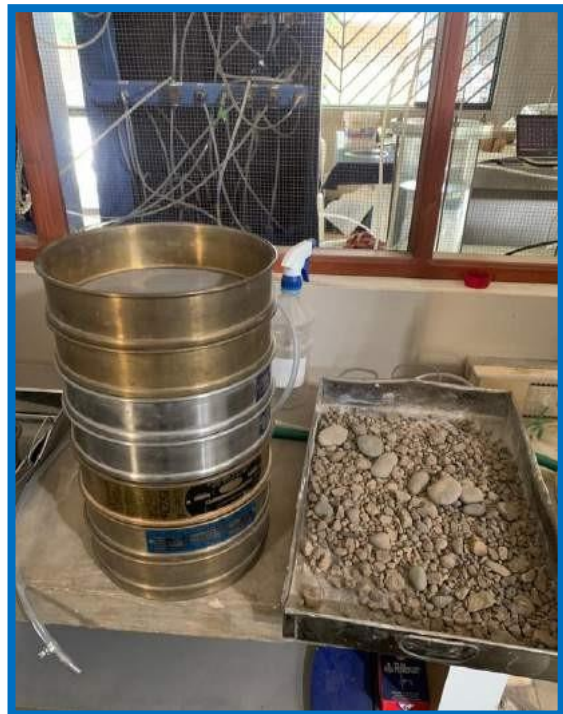
Figura 53: Imagen de realización del granulometría en laboratorio.
