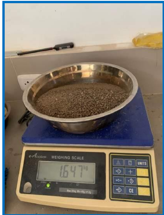
Figura 51: Imagen de realización del granulometría en laboratorio.
