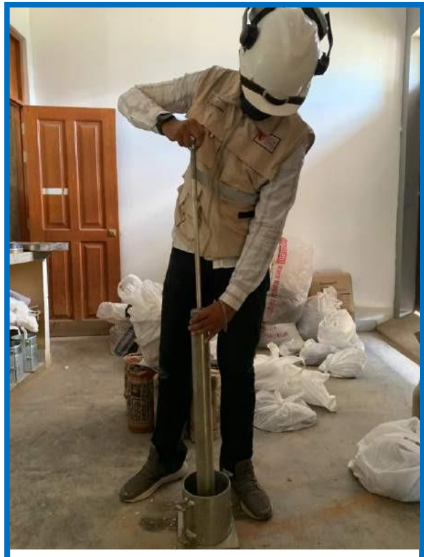
Figura 59: Imagen de realización del proctor en laboratorio.
